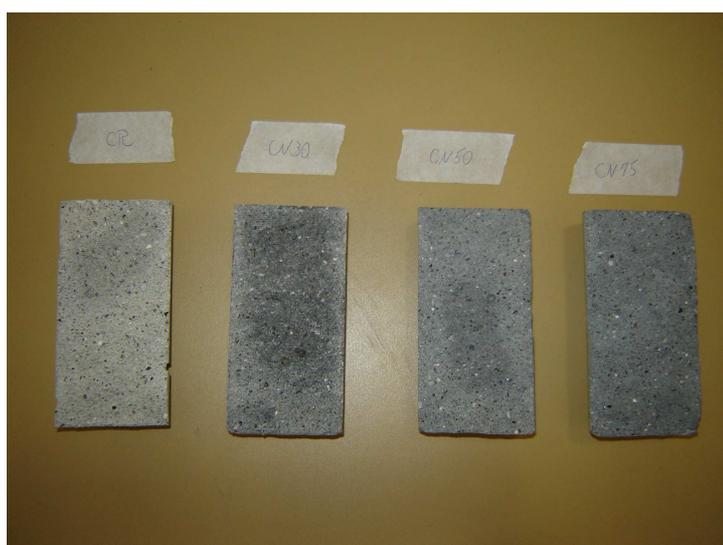
FIGURA 4.3 – Coloração dos quatro traços realizados na primeira etapa: CR, CN30, CN50 e CN75 (da esquerda para direita)
