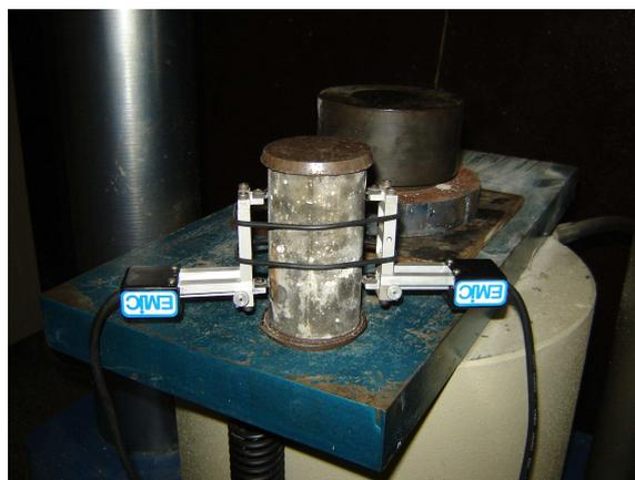
FIGURA 3.21 – Corpo-de-prova com *clip-gage* para ensaio de módulo de deformação
