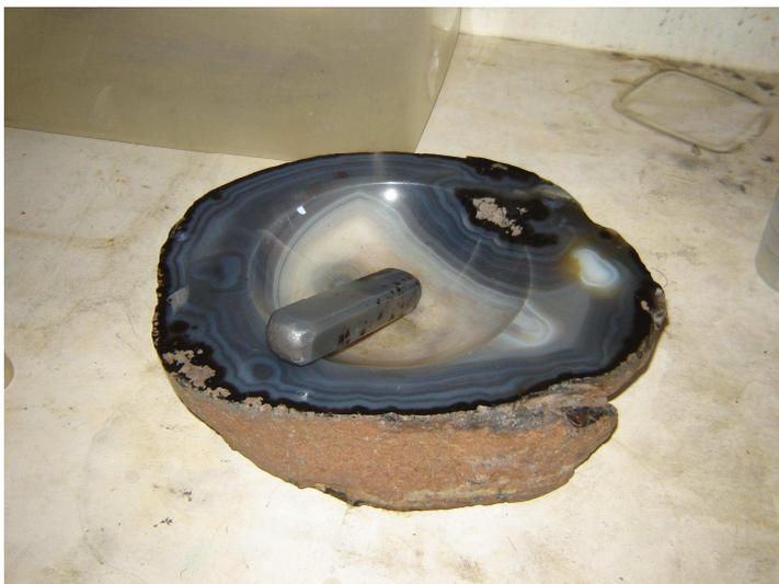
FIGURA 3.22 – Grau utilizado para a transformação da amostra em pó
