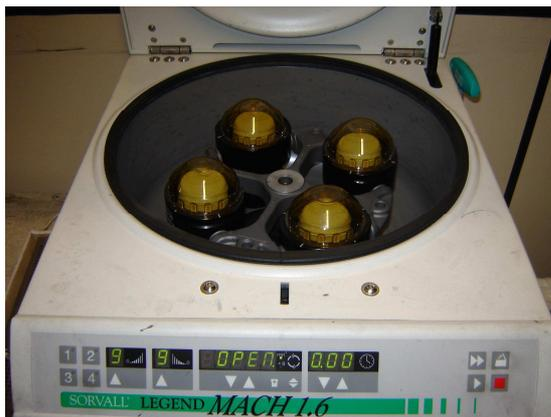
FIGURA 3.8 – Centrífuga com o rotor de quatro potes
