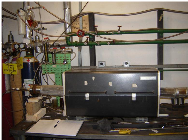
FIGURA 3.1 – Forno para produção de nanotubos de carbono
