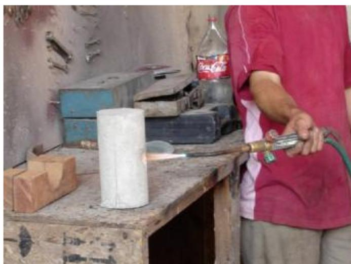
Figura 3.8- Detalhe da utilização do maçarico ao aquecer um CP
