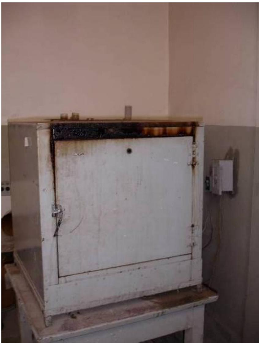
Figura 3.6- Estufa utilizada para aquecer os Corpos de prova
