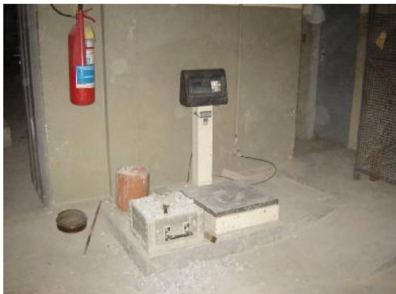
Figura 3.3- Balança eletrônica, capacidade 50kg e precisão 50g
