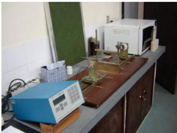
Figura 3.4- Equipamento de teste por frequência ressonante
