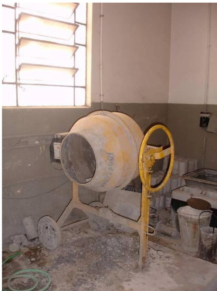
Figura 3.1- Betoneira de eixo horizontal, capacidade 120 litros
