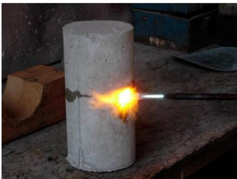
Figura 4.2- Concreto C3- linha d'água aparece na altura do ponto de aplicação do fogo
