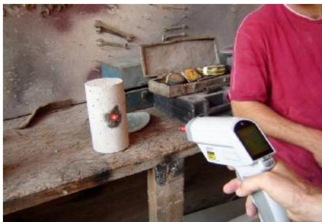
Figura 3.5- Picnômetro utilizado para medir as temperaturas nos Corpos de prova
