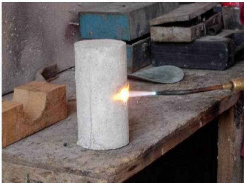
Figura 3.9 – Corpo-de-prova sendo aquecido com maçarico –Ponto “O”
