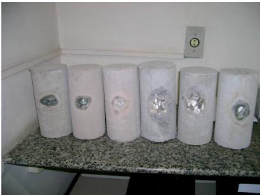
Figura 4.1- Corpos-de-prova após o aquecimento localizado, realizado com maçarico. A seqüência, da esquerda para a direita é a seguinte: CR, C1, C2, C3, C4 e C5
