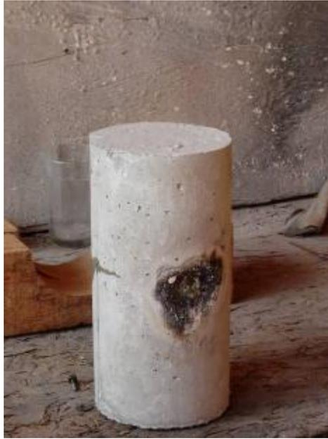
Figura 4.3- Concreto C4- linha d'água aparece na altura do ponto de aplicação do fogo
