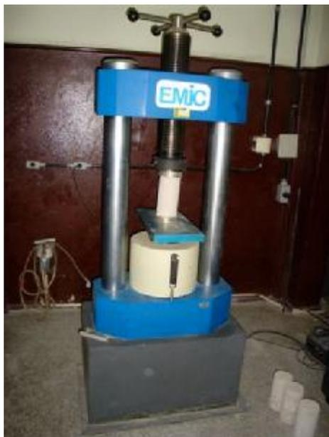
Figura 3.7- Prensa hidráulica utilizada nos ensaios de resistência à compressão simples e resistência à tração por compressão diametral
