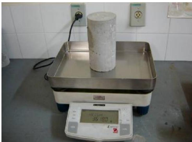
Figura 3.2- Balança eletrônica, capacidade 20kg e precisão 0,1g
