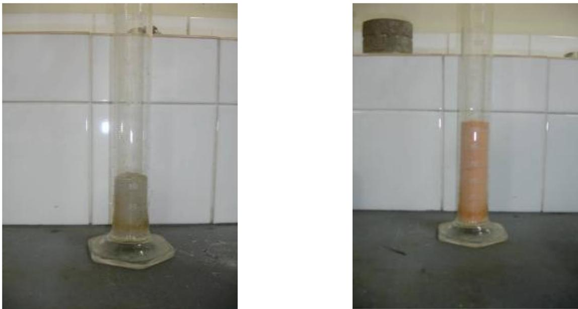
Figura 2.1 – Comparação entre diferentes densidades dos aglomerantes: cimento CP V – ARI PLUS (esquerda-60g) com relação ao metacaulim (direita-60g)
