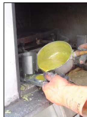
b) enxofre derretido sendo lançado na base da fôrma
