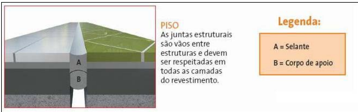
Figura 4.10 – Junta estrutural (O Guia Weber Digital, 2008)
