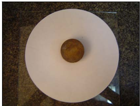
b) copo cilíndrico colocado com a boca voltada para baixo, em contato com o papel filtro.
