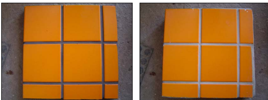
Figura 5.24 – Placas de substrato padrão assentadas com cerâmica 10x10cm, rejuntadas com cada uma das amostras.
