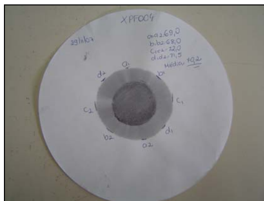
c) média aritmética entre quatro medidas de diâmetros ortogonais registradas na mancha de umidade retida no papel filtro.
