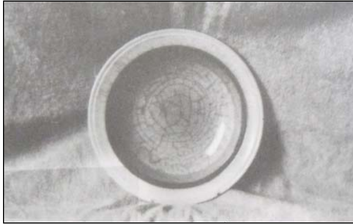
Figura 4.12 – Efeito da expansão provocando o gretamento do esmalte de uma louça de mesa após alguns anos de uso (FIORITO, 1994).
