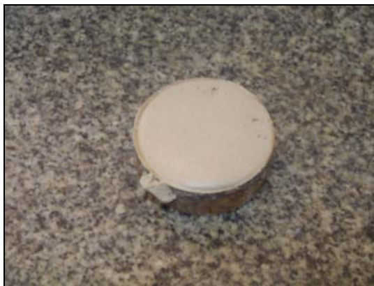
a) copo cilíndrico moldado com a mistura do rejunte.
