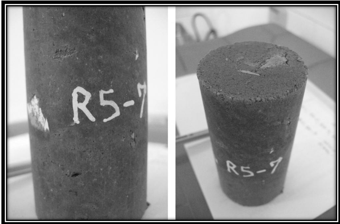
Figura 33 – Resíduos aparentes na face do corpo-de-prova
