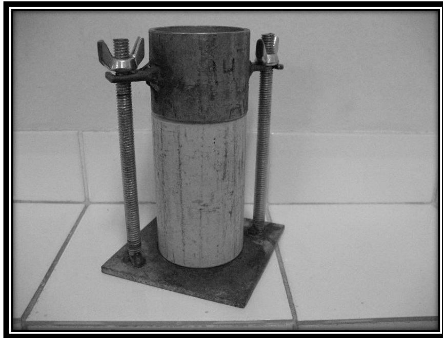
Figura 11 – Molde utilizado para confecção dos corpos-de-prova
