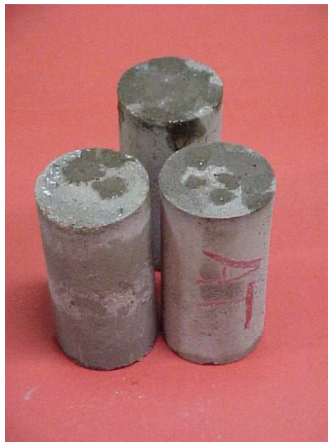
Figura 38 – Argamassa com a substituição pelas escórias de alto-forno.
