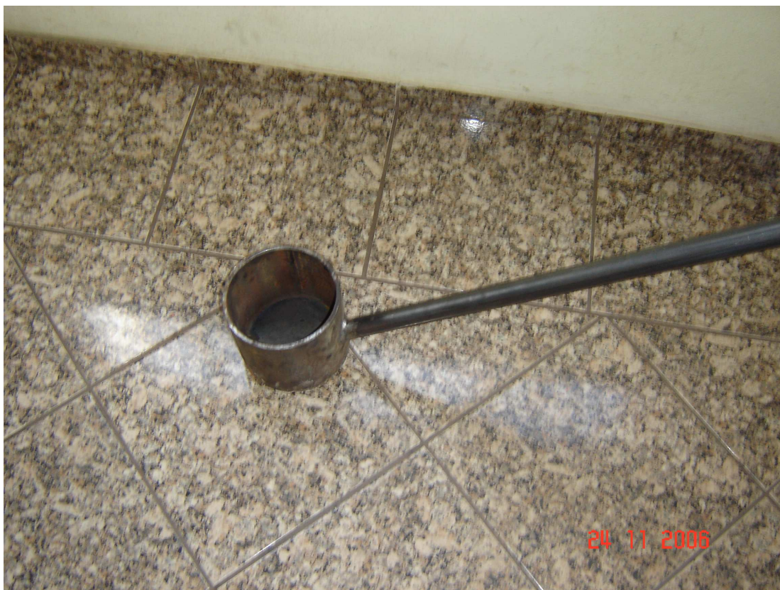
Figura 19 – Sistema adotado na coleta de escória na bica
