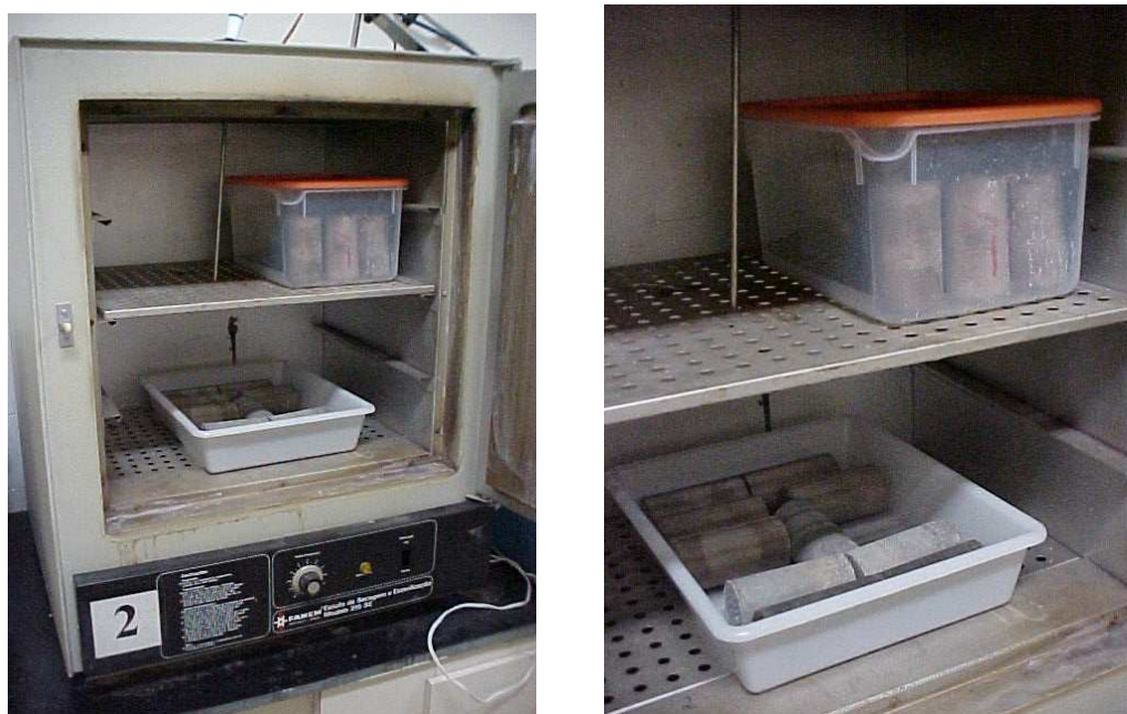
Figura 39 – Estufa utilizada na cura dos corpos-de-prova de argamassa
