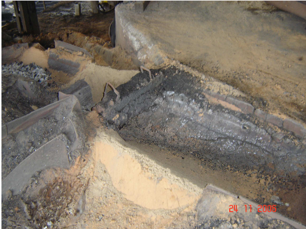
Figura 23 – Ponto final de escoamento da escória na bica
