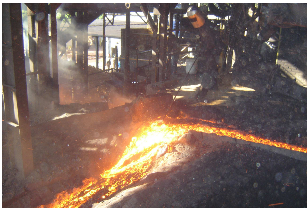
Figura 26 – Detalhe da captação da escória líquida
