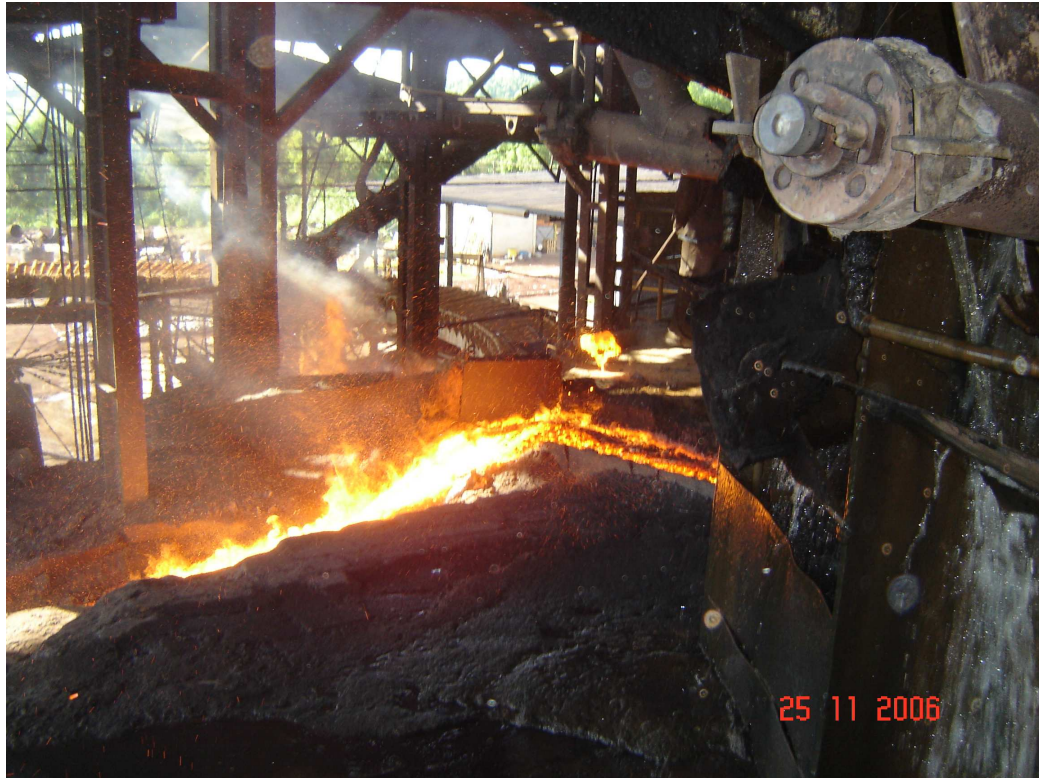
Figura 27 – Detalhe da captação da escória líquida na bica
