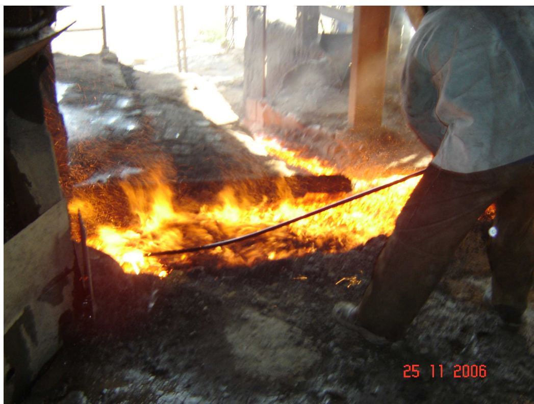
Figura 22 – Detalhe da limpeza do furo de corrida
