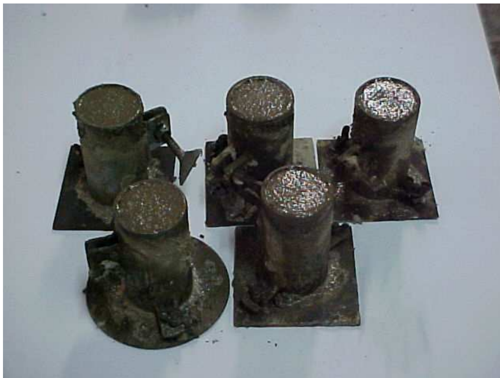
Figura 36 – Corpos-de-prova moldados com substituição pelas escórias de alto-forno
