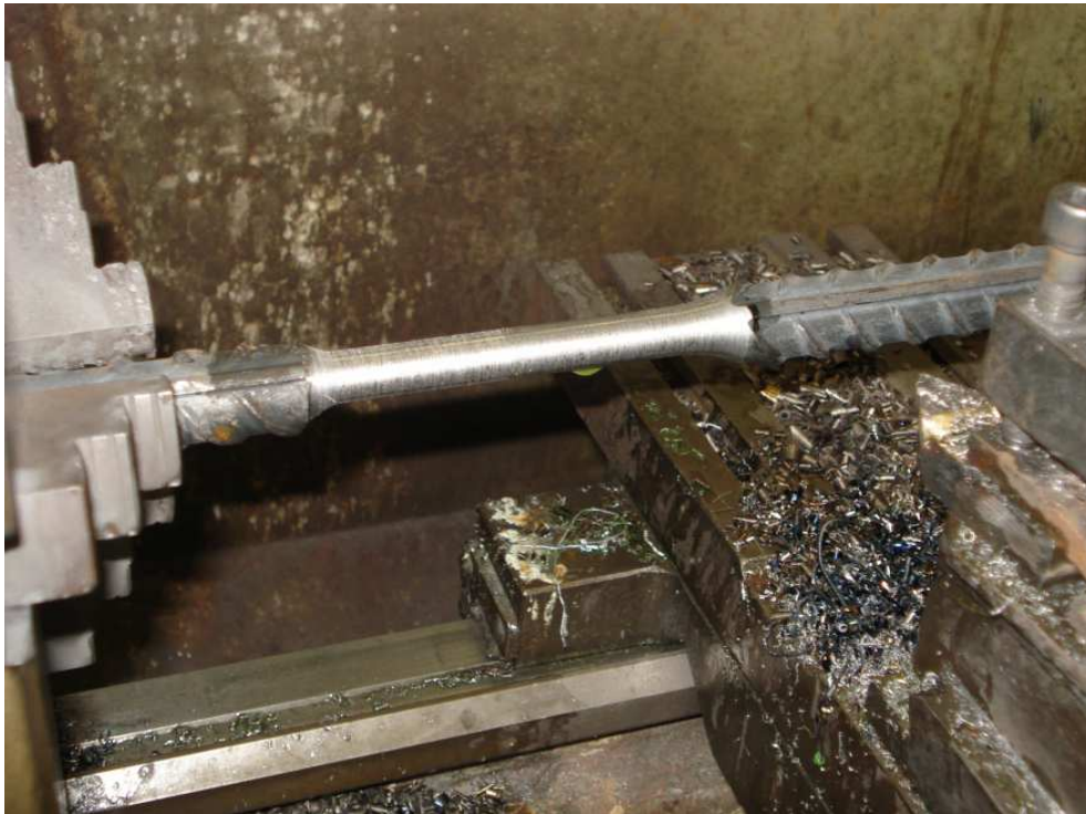
Figura 4.10 – Usinagem do corpo de prova, torno Nardini-MS 175E.
