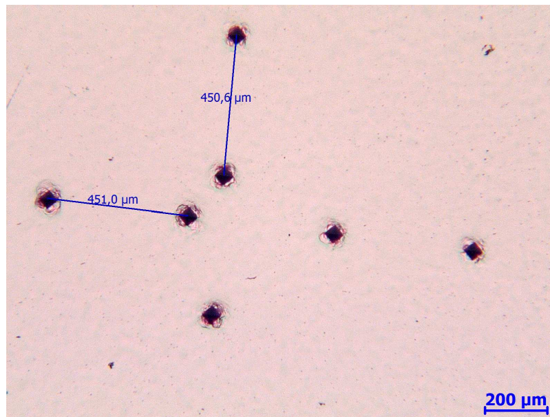
Figura 5.49 – Impressões perpendiculares da microdureza Vickers, barra 8,0 mm.
