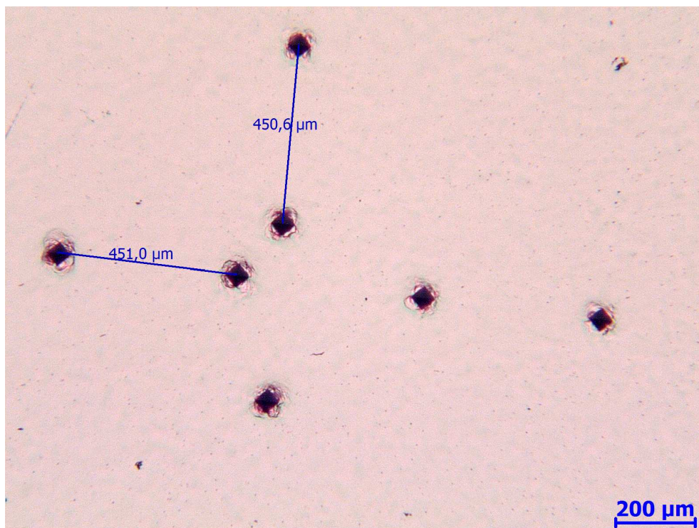
Figura 4.7 – Perfis perpendiculares de microdureza Vickers, barra de 8mm.
