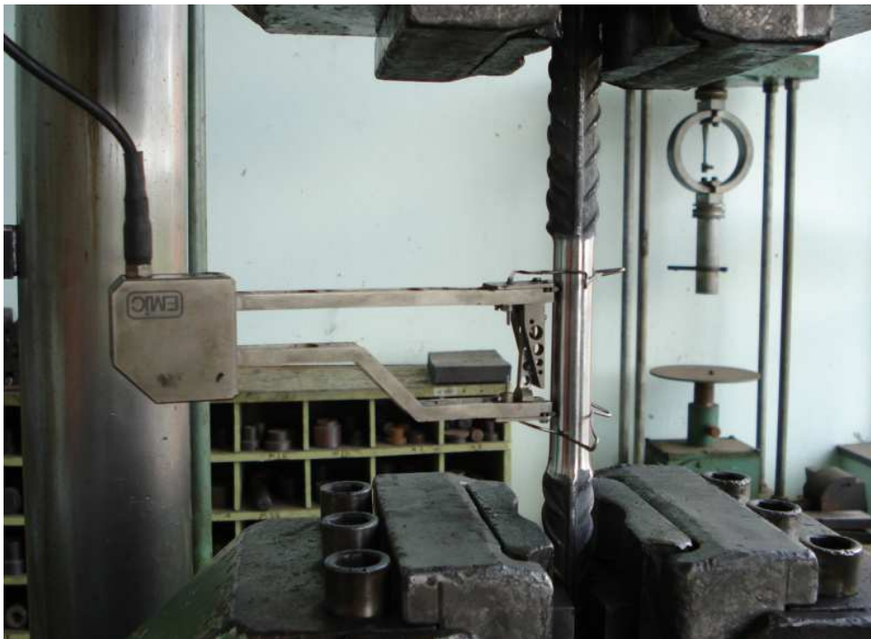
Figura 4.13 – Detalhe do extensômetro eletrônico utilizados nos ensaios.
