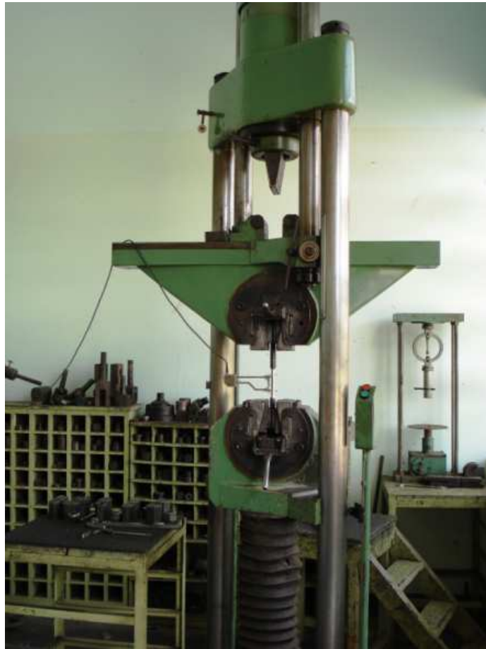
Figura 4.12 – Ensaio de tração utilizando a máquina Mohr Federhaff Losenhausen (UIT).
