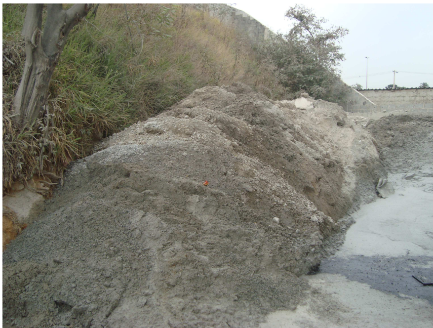
Figura 2 – Resíduo de Concreto
