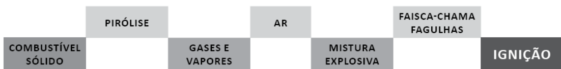
Figura 3.4 – mecanismo de ignição dos combustíveis sólidos
