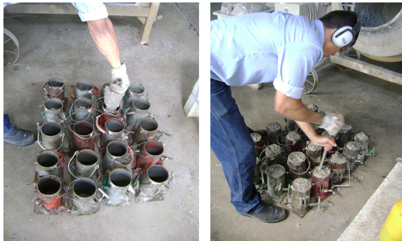
Figura 4.4 - Fotos da moldagem/adensamento manual dos corpos de prova
