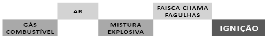
Figura 3.6 – mecanismo de ignição dos combustíveis gasosos
