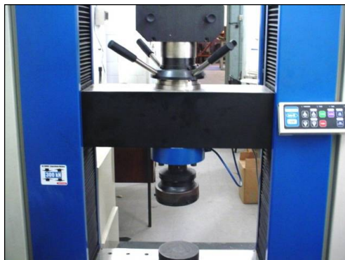
Figura 5.17: Máquina universal EMIC com capacidade de 300 kN, utilizada nas caracterizações da madeira.
