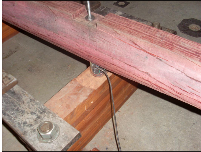
Figura 5.8: Detalhe do posicionamento da célula de carga.
