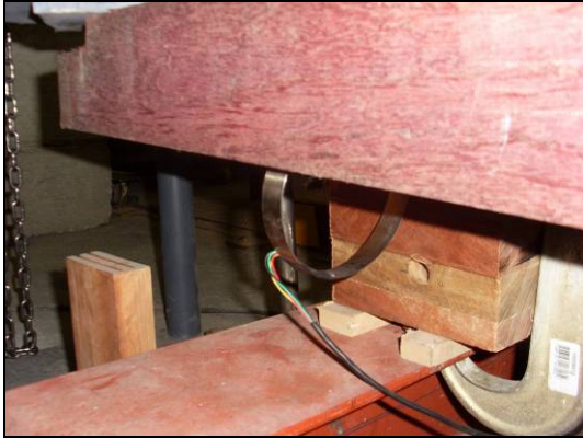
Figura 5.10: Detalhe do posicionamento do transdutor de deslocamento.
