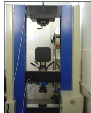
Figura 5.17: Máquina universal EMIC com capacidade de 300 kN, utilizada nas caracterizações da madeira.
