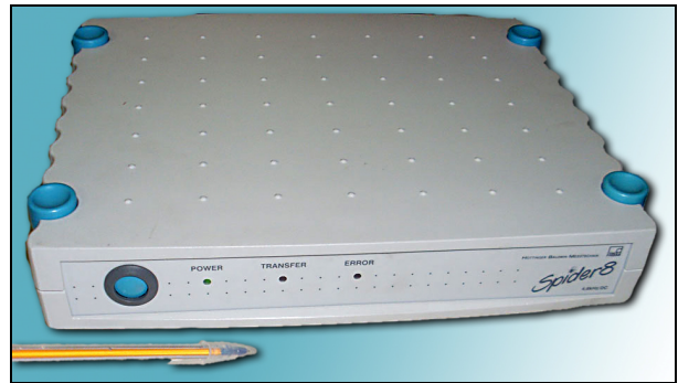
Figura 5.16: Detalhe do sistema de aquisição de dados utilizados – Spider 8®.
