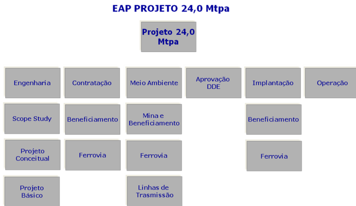
Figura 33 – Estrutura Analítica do Projeto 24 Mtpa – EAP (Adaptado do Relatório de FEL1, Vale 2009)
