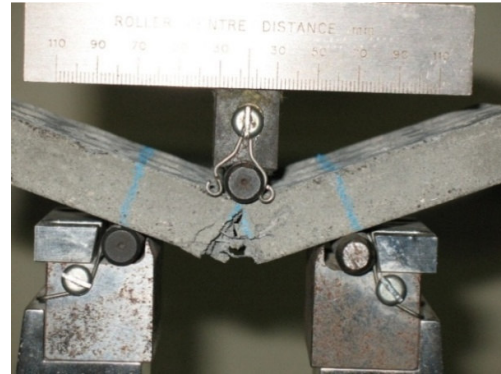
(b) - Barra fissurada ao fim do ensaio
