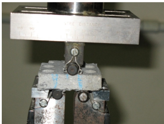
Figura 36 - Corpo-de-prova do CONCRETO/FIBRA POLIMÉRICA
