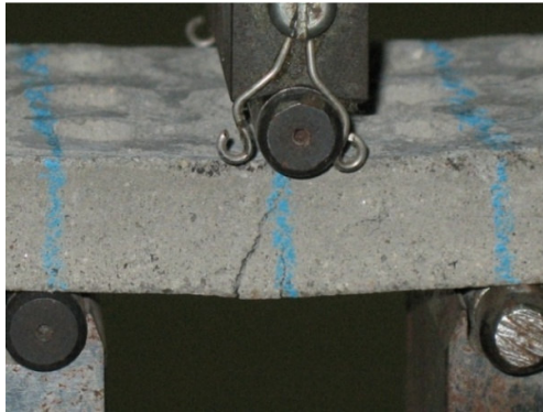
(a) - Detalhe da trinca no início da fissuração
