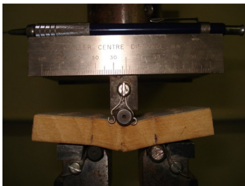
(a) - Início da fissuração da amostra
