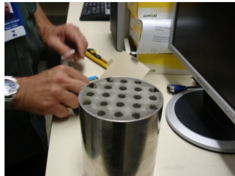
Figura 29 - Fixação dos discos de concreto no porta-amostras do tubo
