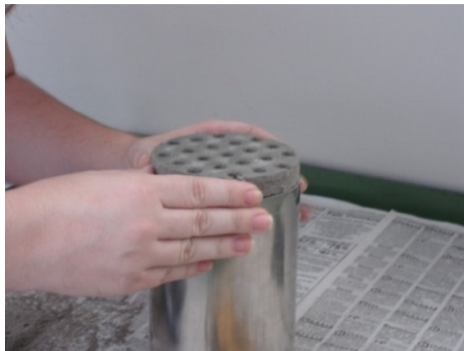
Figura 29 - Fixação dos discos de concreto no porta-amostras do tubo
