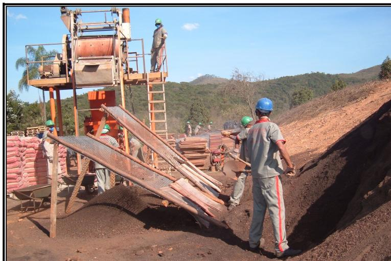
**Figura 10 – Instalação de peneiramento para produção do Pavieco**
