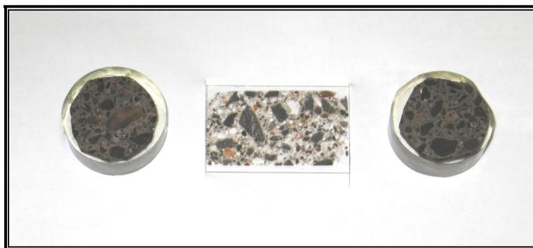
**Figura 38 – Detalhe da lâmina montada e das duas seções polidas preparadas**
