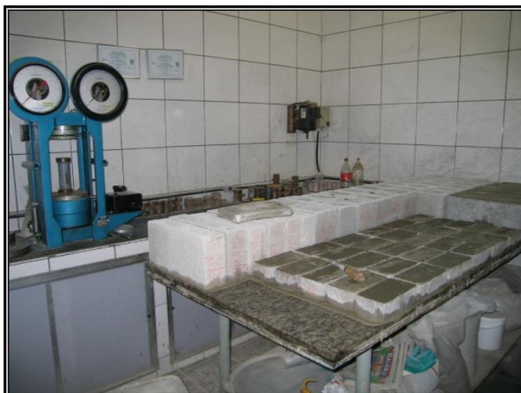
**Figura 33 – Vista da área do laboratório da IBEC na fase de capeamento dos bloquetes para seu rompimento**
