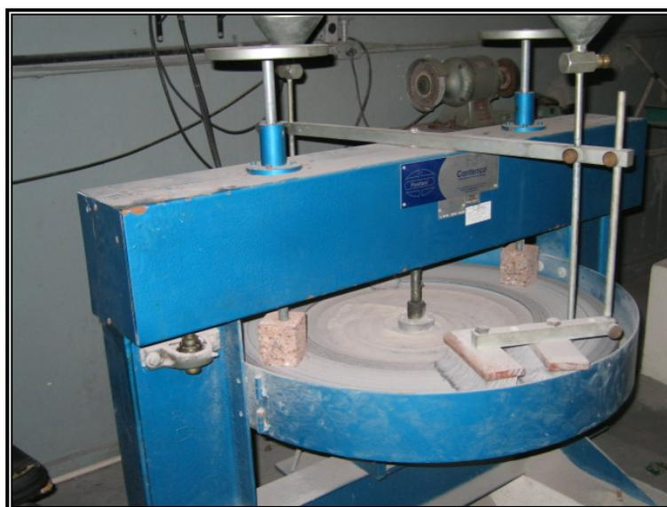
**Figura 35 – Vista do aparelho de ensaio de desgaste por abrasão**
