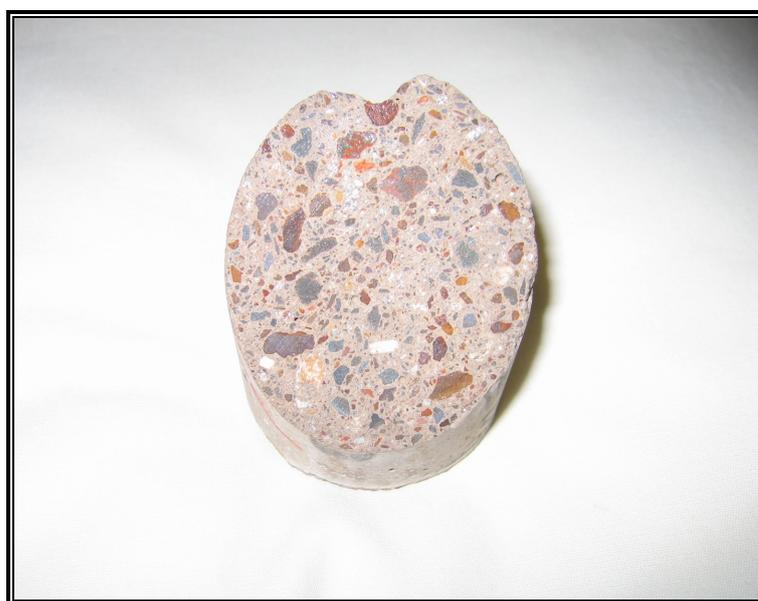
**Figura 37 – Detalhe da seção de um corpo de prova 5 x 10 cm da argamassa produzida com o rejeito de sinter feed**
