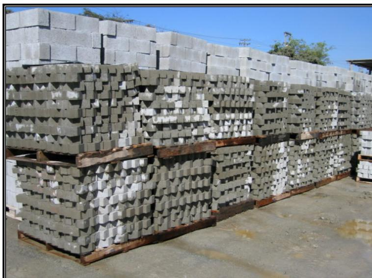
**Figura 31 – Vista de área externa de cura de bloquetes paletizados**
