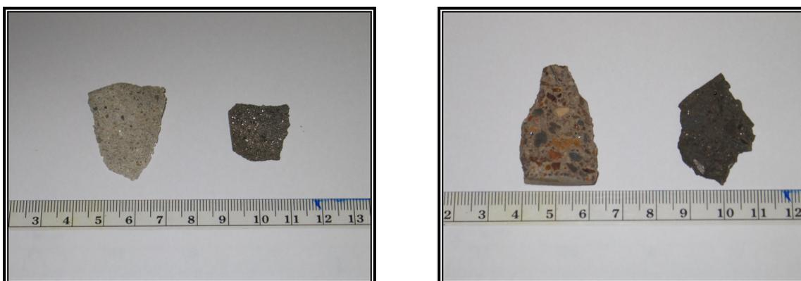
**Figura 39 – Fragmentos de argamassa normal e argamassa com rejeito para o ensaio de MEV**
