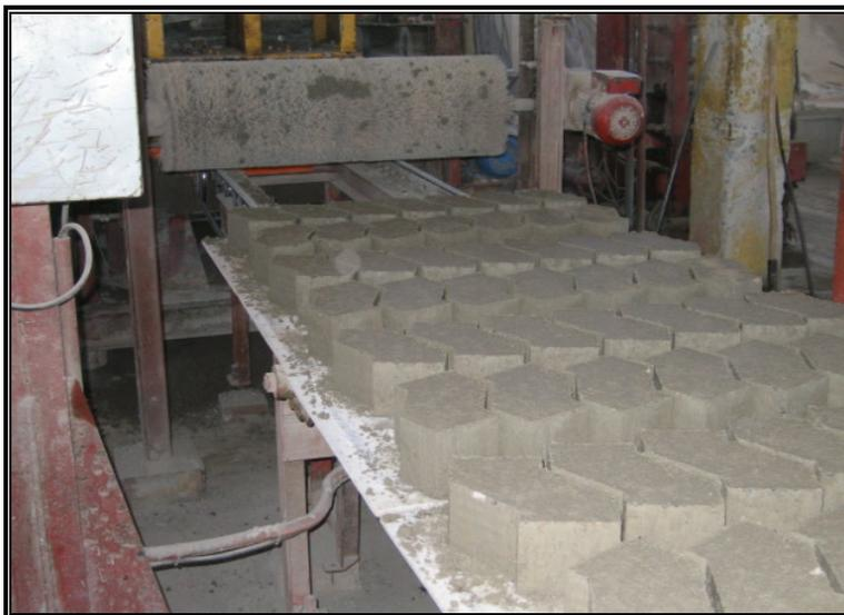
**Figura 27 – Sequência de bandejas de bloquetes na saída da vibro-prensa**
