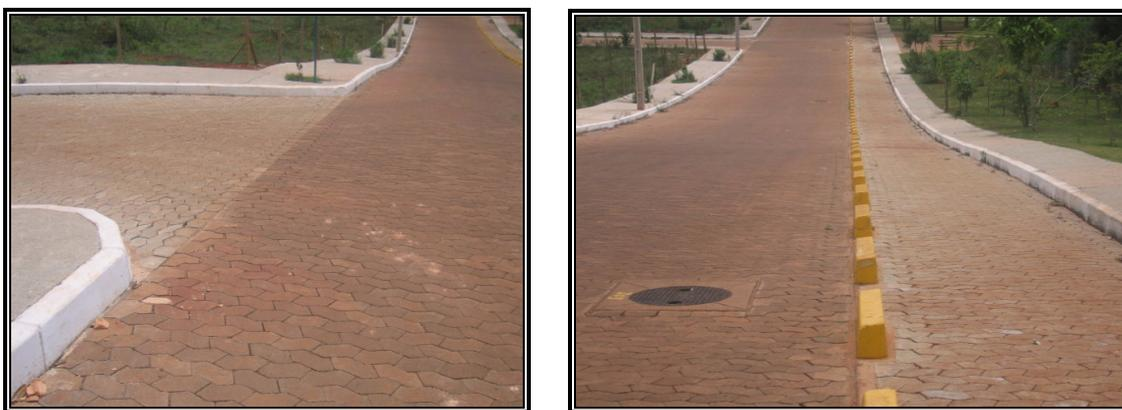
**Figura 50 – Vista de trecho do bairro Jd. Canadá em Nova Lima pavimentado com bloquetes produzidos com material semelhante ao da presente pesquisa**
