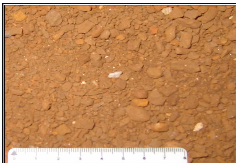
**Figura 6 – Detalhe do rejeito de sinter feed com referência de dimensão**
