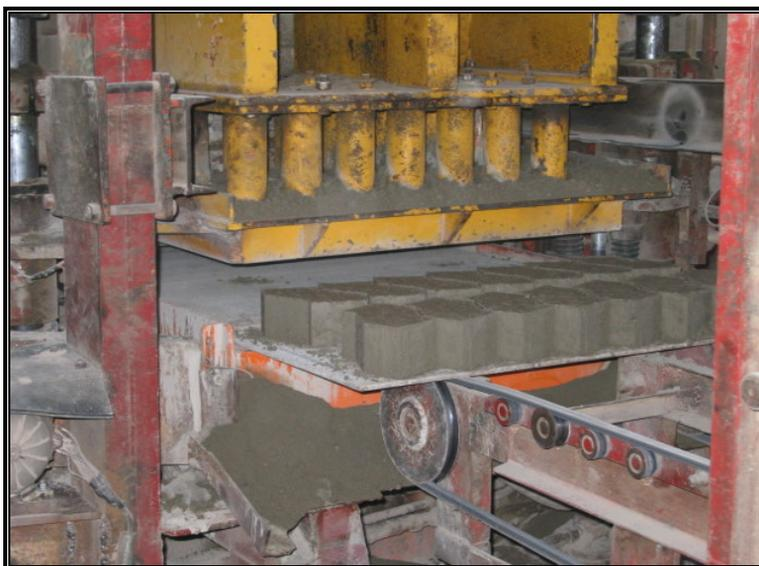
**Figura 26 – Momento da saída dos bloquetes na vibro-prensa**
