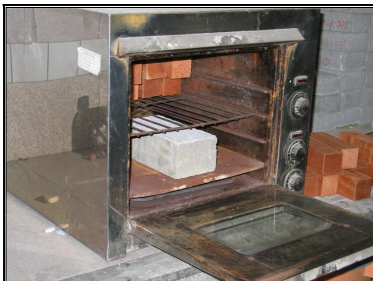
**Figura 34 – Vista da estufa elétrica utilizada na secagem das peças**
