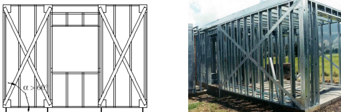
FIGURA 10 – Detalhes dos Painéis (Fonte: Usiminas- 2004).
