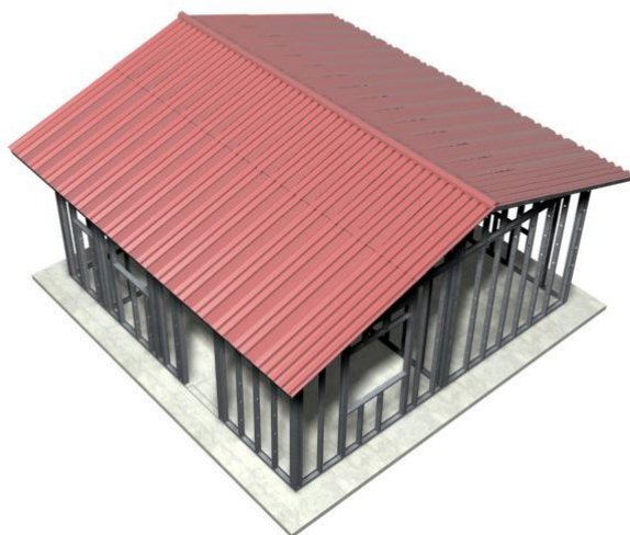
FIGURA 46 – Colocação das telhas (Fonte: Arquivo do autor, 2008).
