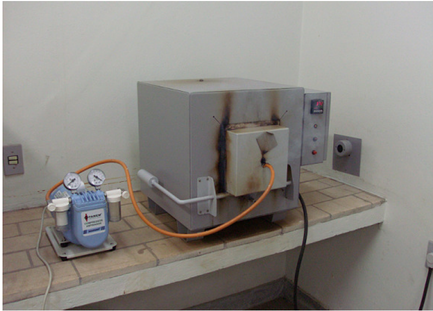
Figura 4.10 - Forno tipo mufla com adaptação para injeção de ar.
