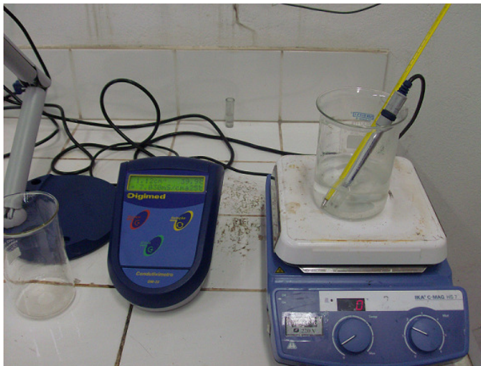
Figura 4.17 - Condutímetro medindo condutividade e temperatura da solução de \text{Ca(OH)}_2 saturada.
