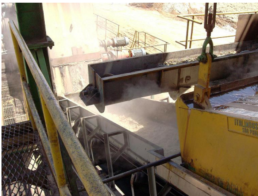
Figura 4.3 - Desfibrilador de cana-de-açúcar.
