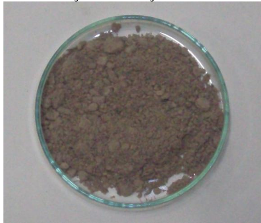
(d) Temperatura = 600 °C Tempo de queima = 120 minutos Resfriamento rápido Com circulação de ar forçada
