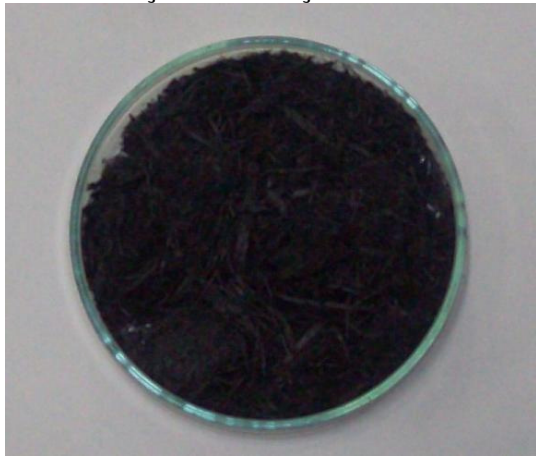
(c) Temperatura = 600 °C Tempo de queima = 120 minutos Resfriamento rápido Sem circulação de ar forçada
