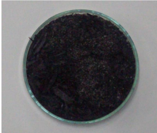
(a) Temperatura = 600 °C Tempo de queima = 120 minutos Resfriamento lento Sem circulação de ar forçada
