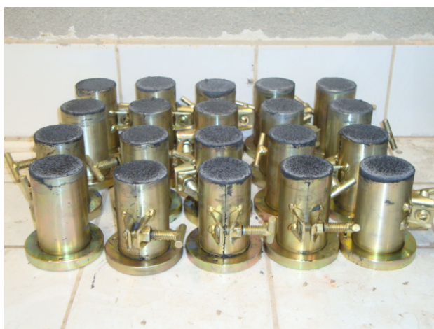
Figura 4.14 - Moldes utilizadas para a confecção dos corpos de prova de microconcretos.
