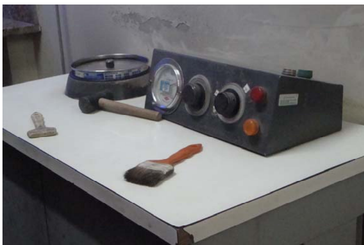
Figura 4.10 - Equipamento utilizado para o peneiramento do cimento.
