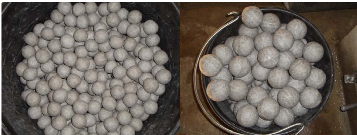
Figura 4.3 - Esferas de alumina sinterizada utilizadas no moinho.
