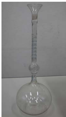
Figura 4.7 - Frascos de Le Chatelier utilizados para realizar o ensaio de massa específica das cinzas.
