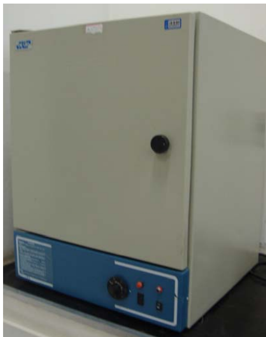
Figura 4.2 - Estufa utilizada para a secagem das cinzas.
