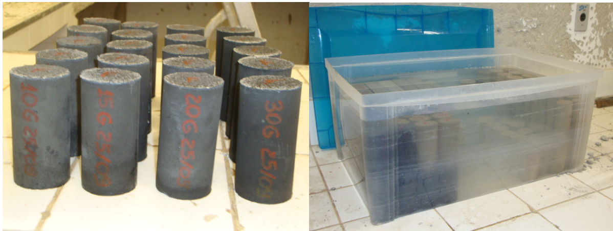
(a) (b) Figura 4.15 - Corpos de prova desmoldados e devidamente identificados (a) e colocados em um recipiente para a cura (b).
