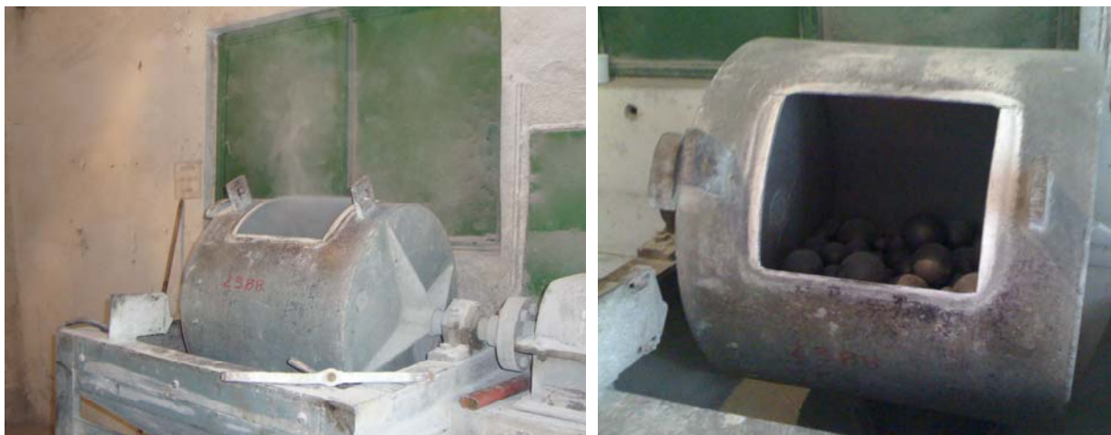
Figura 4.4 - Moinho piloto utilizado na moagem do cimento.
