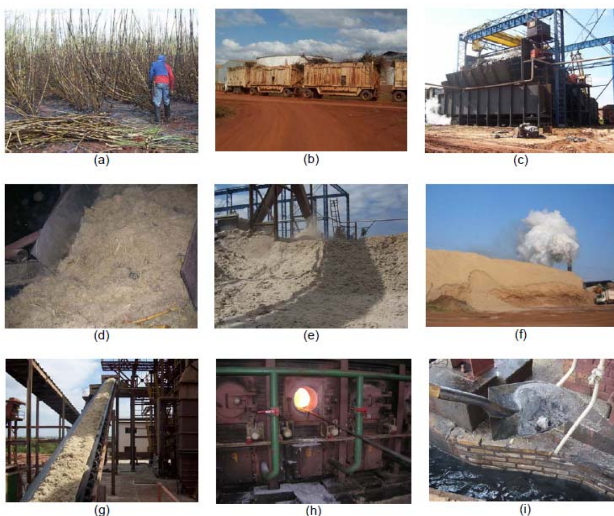
Figura 3.14 - Cane-de-açúcar: corte, moagem, produção e queima do bagaço. (a) Corte da cana-de-açúcar, (b) transporte até a unidade industrial, (c) a cana é lavada, (d) a cana é desfibrada e enviada à moenda para a retirada do caldo, (e, f) depósito do bagaço a céu aberto, (g) esteira rolante para levar o bagaço à caldeira, (h) caldeira onde é queimado o bagaço, (i) cinzas residuais (Adaptado de SOUZA, G. N. et al., 2007a).
