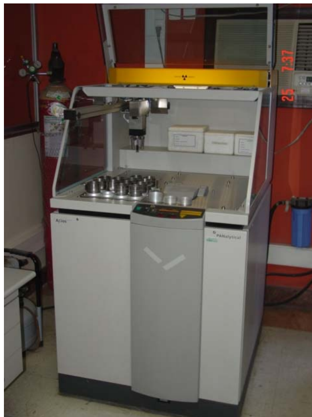
Figura 4.11 - Equipamento para ensaio de espectrometria de fluorescência de raios X - AXIOS DY 758 (Fornecido pela Lafarge Brasil).
