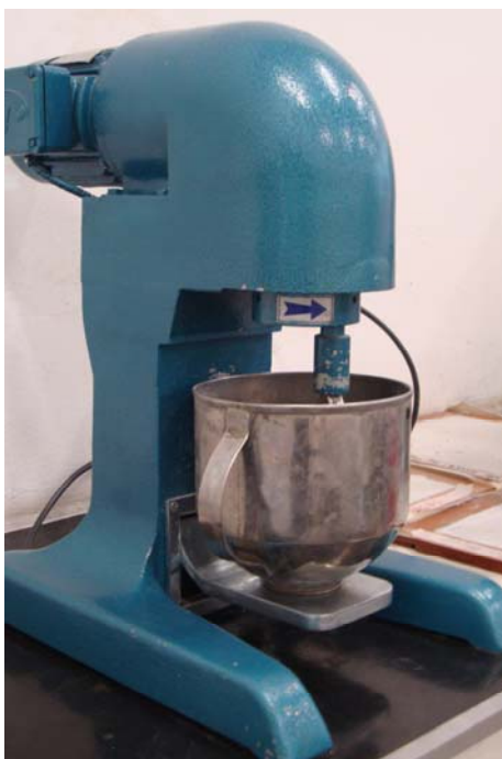
Figura 4.13 - Misturador mecânico utilizada para misturar os diferentes traços de microconcretos.
