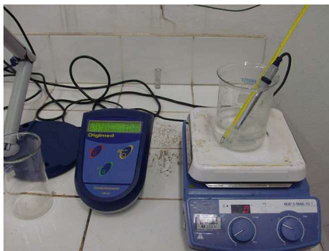
Figura 4.8 - Condutímetro medindo condutividade e temperatura da solução de \text{Ca(OH)}_2 saturada.
