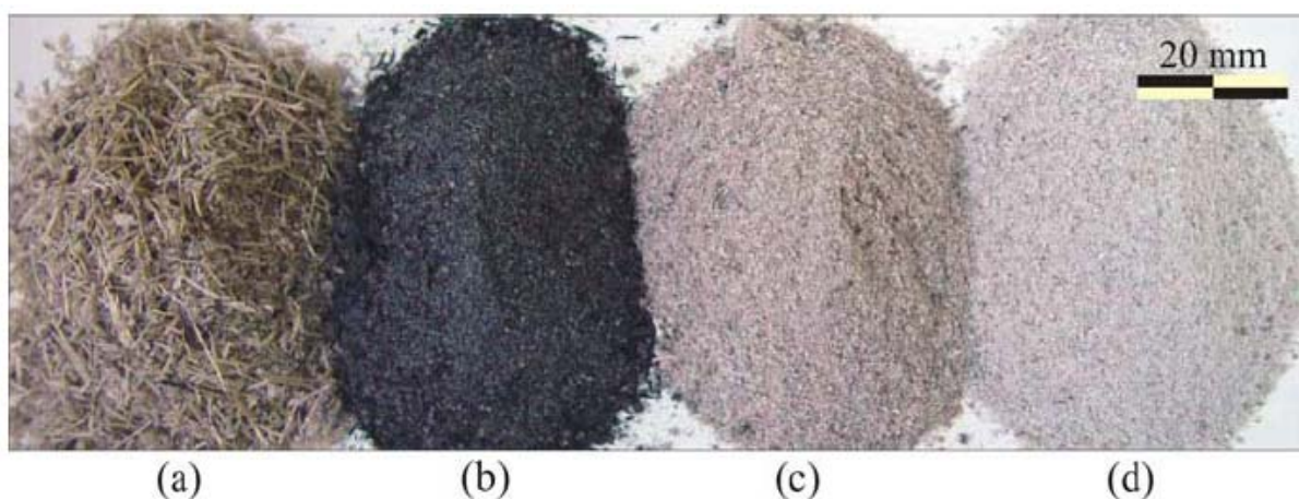
Figura 3.18 - Bagaço de cana-de-açúcar (a) e diferentes cinzas residuais geradas após a queima do bagaço em caldeira: cinza escura com alto teor de carbono, característico de combustão incompleta (b), cinza com menor teor de carbono (c) e cinza gerada após combustão completa (d) (CORDEIRO, G. C., 2006).
