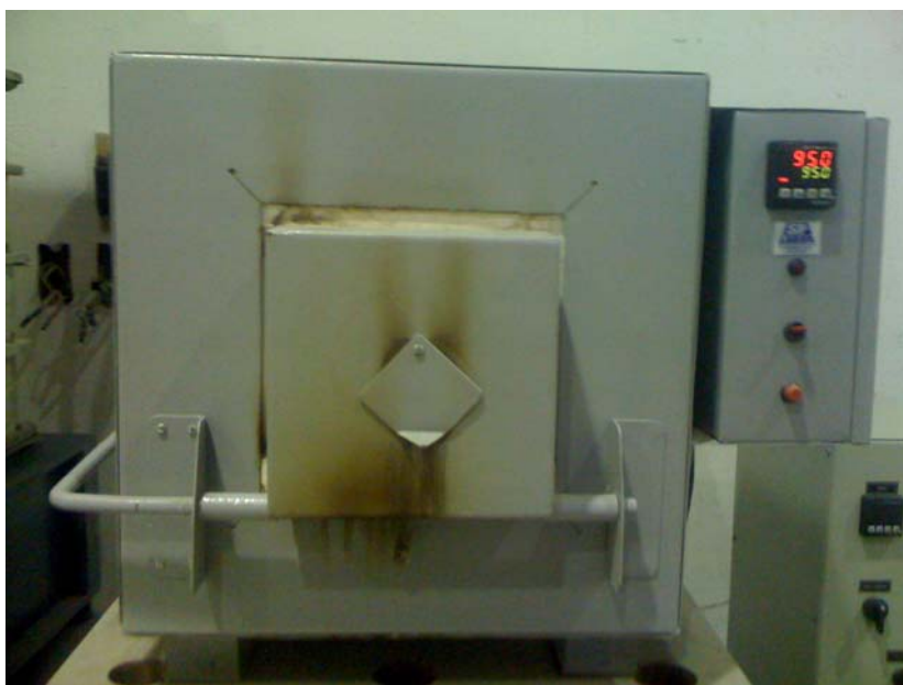
Figura 4.9 - Mufla utilizada para o ensaio de perda ao fogo.
