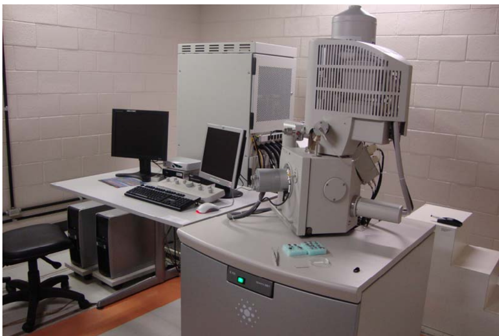
Figura 4.6 - Equipamento para ensaio de Microscopia Eletrônica de Varredura (MEV).
