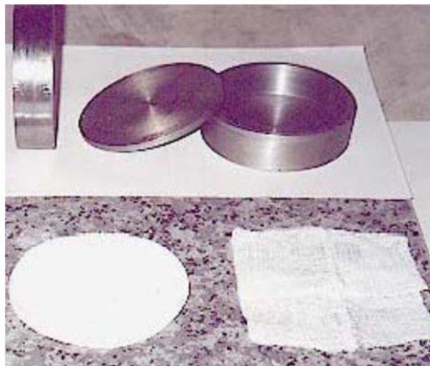
Figura 13 – Dispositivos necessários para determinação da retenção de água.
