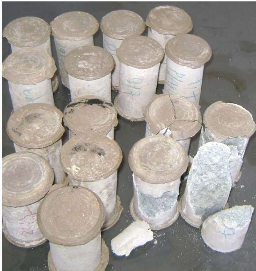
Figura 35 - Vista dos CP's após rompimento.
