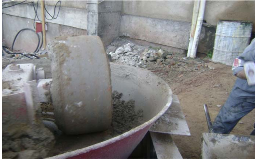
Figura 18 – Cominuição do RCC pelo moinho/argamassadeira.
