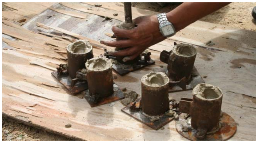
Figura 20 - Moldagem dos CP's de argamassa (em obra).
