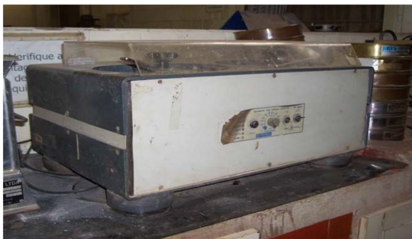
Figura 30 – Moagem de uma amostra de material no moinho de disco orbital TECNAL TE-360.
