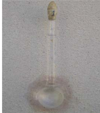
Figura 28 – Ensaio de Permeabilidade à água com cachimbo de vidro.
