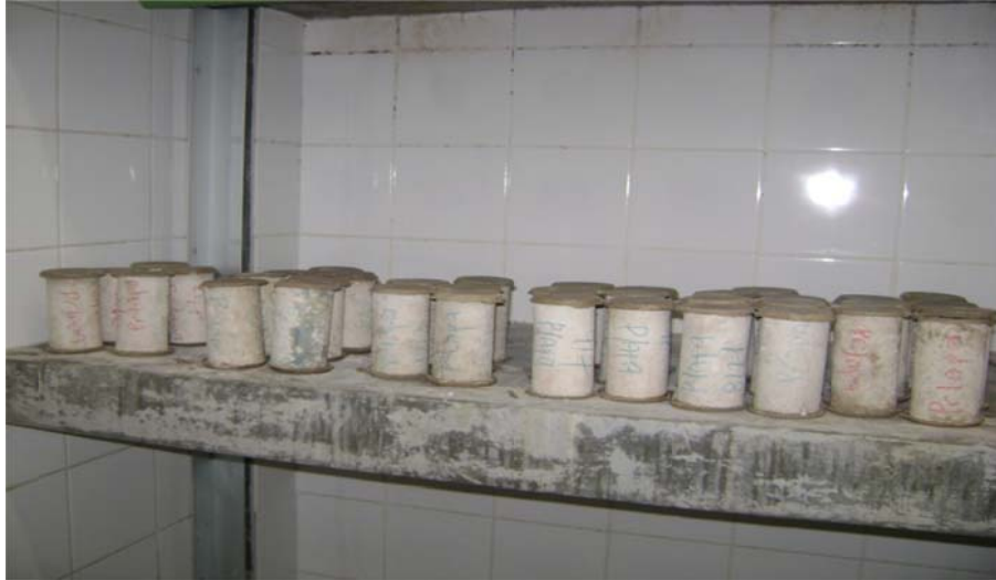
Figura 23 – Capeamento dos CP's com mistura de enxofre.
