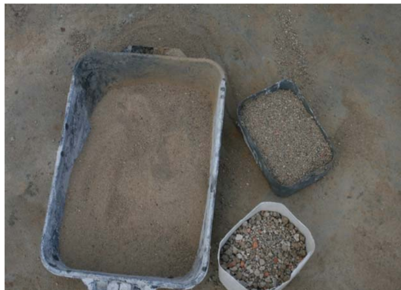
Figura 11 – Agregado miudo de RCC passante na peneira 2,4 mm.
