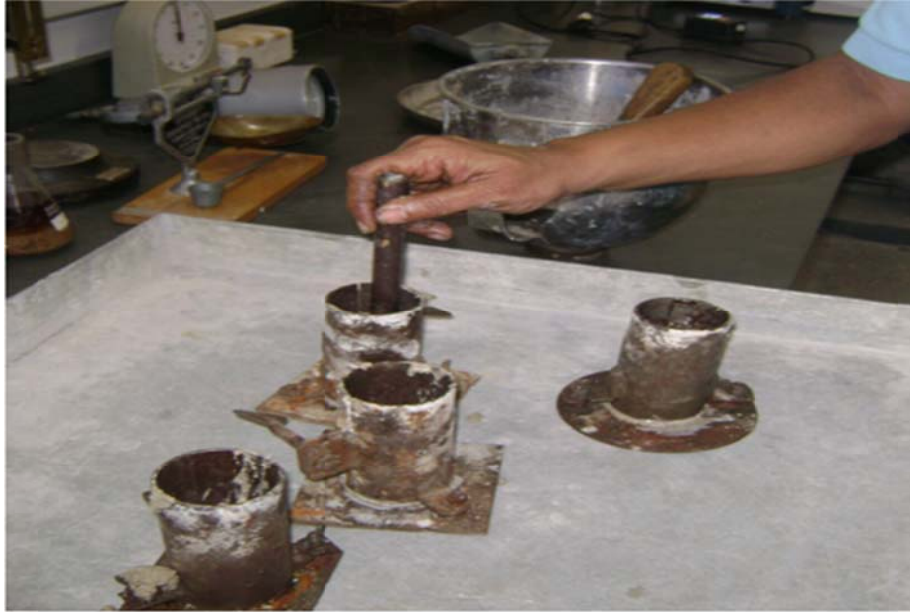
Figura 16 – Moldagem dos CP's no laboratório.
