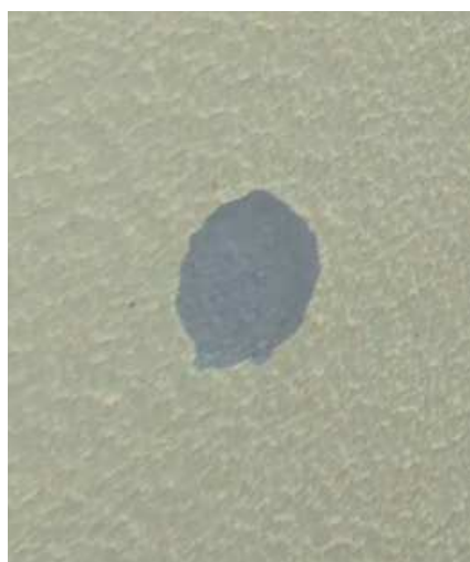
Figura 20 - Local onde houve ensaio tipo pull-off
