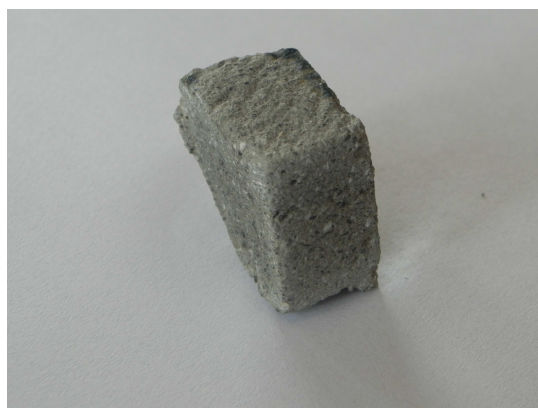
Figura 21 - Amostra retirada em local onde foi feito o ensaio tipo pull-off
