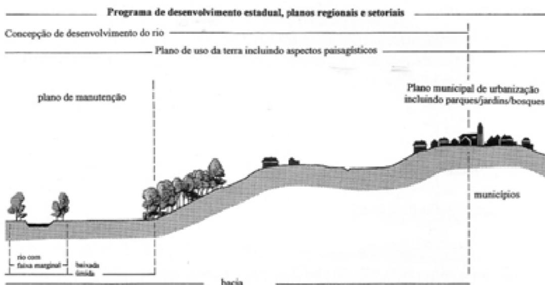
**FIGURA 38:** Esquema para interligação territorial de áreas adjacentes a cursos d'água.
