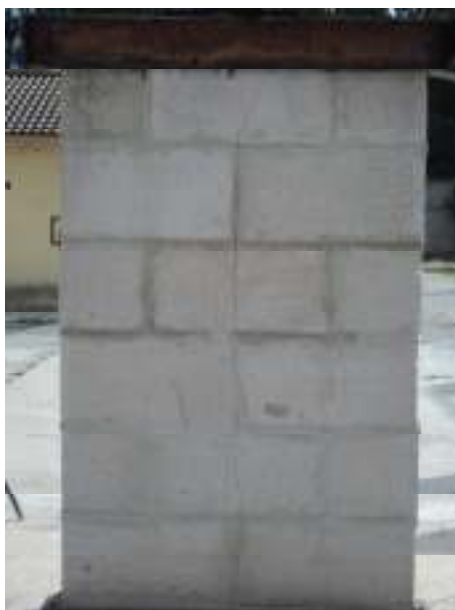
FIGURA 4.28 – Ensaio de compressão das paredes BCCA: ruptura – argamassa traço 1:3:8
