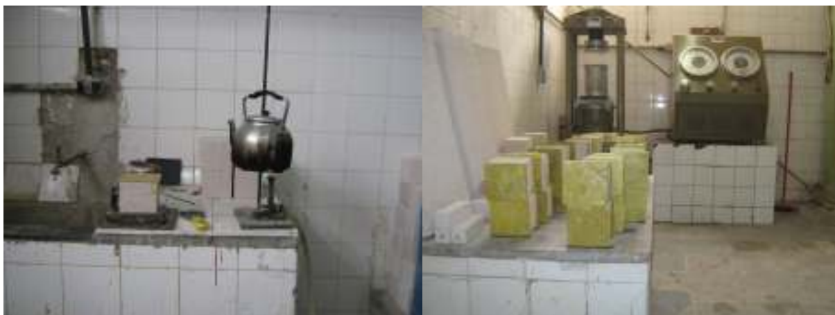
FIGURA 4.7 – Nivelamento dos corpos-de-prova de CCA
