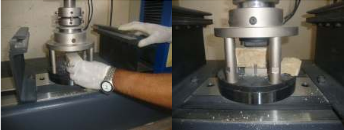
FIGURA 4.42 – Ensaio de resistência à compressão – traço 1:3:8 Fonte: Precon, 2010.
