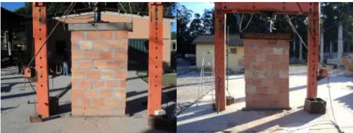
FIGURA 4.31 – Ensaio de compressão das paredes cerâmicas – argamassa industrial
