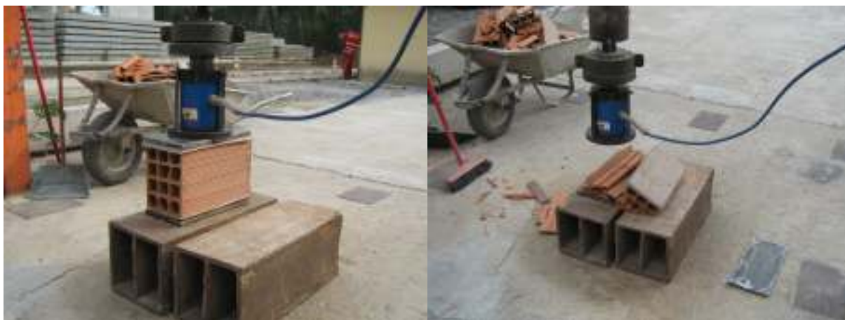
FIGURA 4.12 – Ensaio de compressão dos corpos-de-prova cerâmicos
