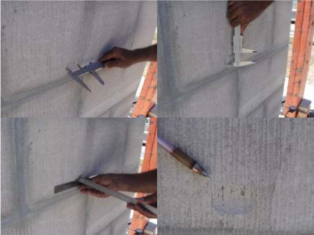
FIGURA 4.46 – Ensaio de corpo duro – medição das mossas para esfera de 1 kg (Parede BCCA)
