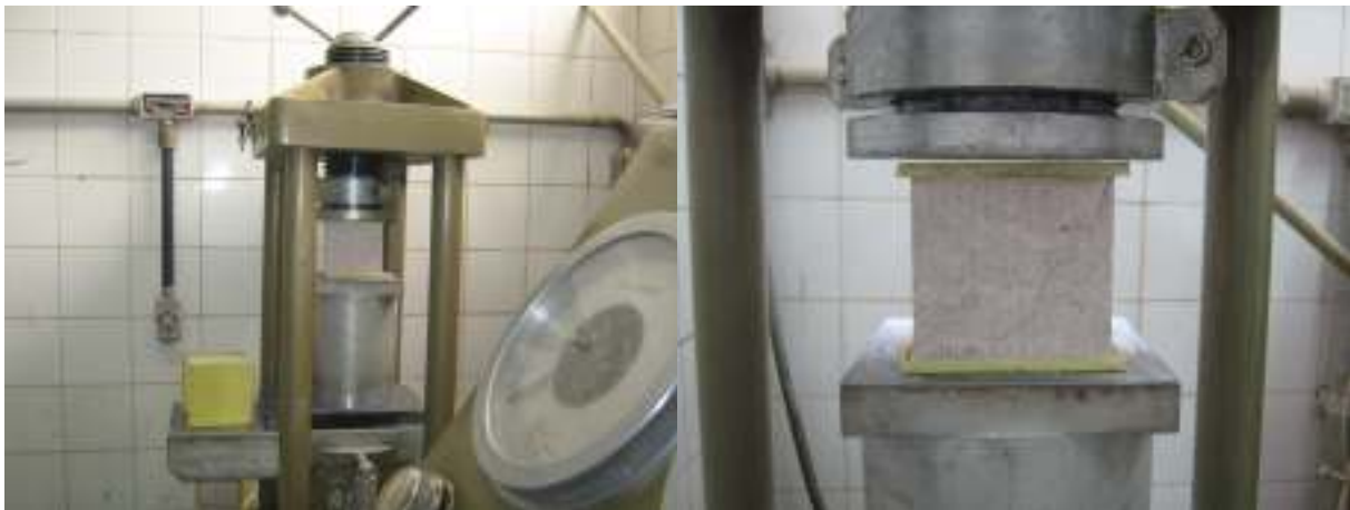
FIGURA 4.8 – Ensaio de compressão dos corpos-de-prova de CCA
