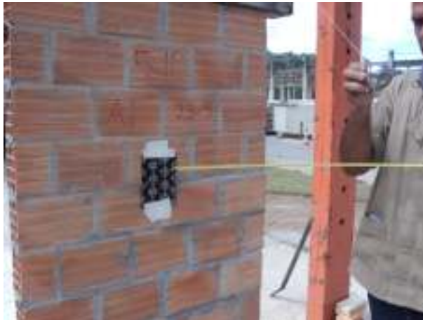
FIGURA 4.49 – Ensaio de corpo duro – esfera de 1 kg (Parede Cerâmica)
