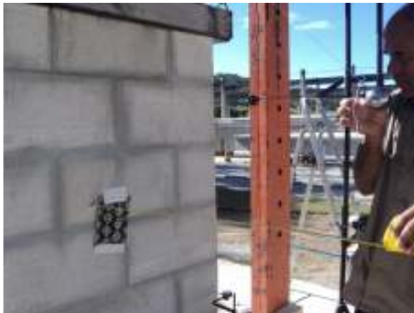
FIGURA 4.45 – Ensaio de corpo duro – esfera de 1 kg (Parede BCCA)
