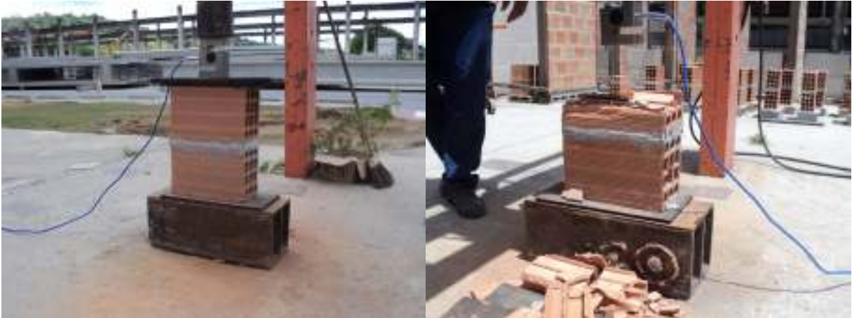
FIGURA 4.20 – Ensaio de compressão dos prismas cerâmicos – argamassa industrial
