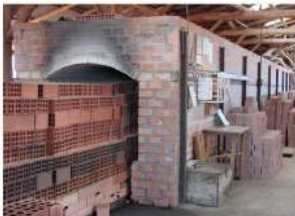
FIGURA 3.6 - Forno tipo Túnel: detalhe da saída da cerâmica, após a queima Fonte: IBRACON, 2007.
