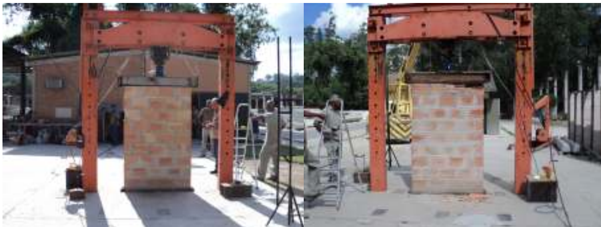
FIGURA 4.32 – Ensaio de compressão das paredes cerâmicas – argamassa de traço 1:3:8
