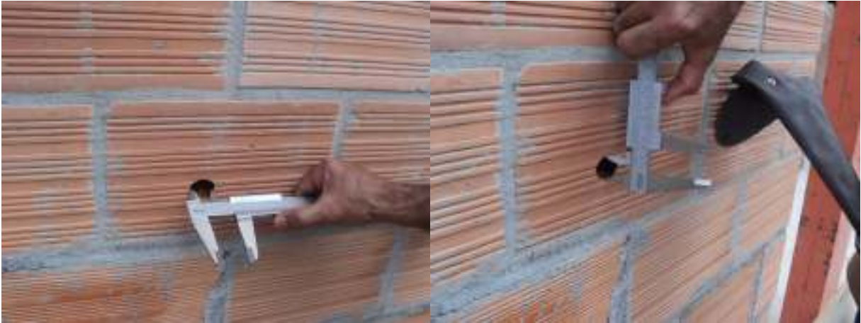
FIGURA 4.48 – Ensaio de corpo duro – medição das mossas para esfera de 0,5 kg (Parede Cerâmica)
