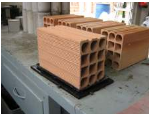
FIGURA 4.10 – Nivelamento dos corpos-de-prova cerâmicos
