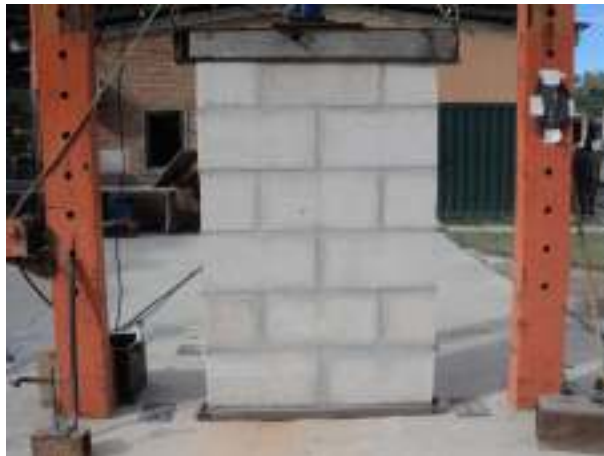
FIGURA 4.26 – Ensaio de compressão das paredes BCCA – argamassa industrial
