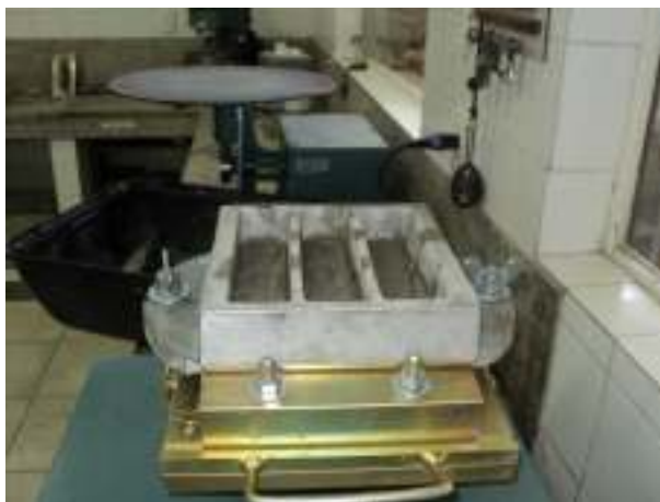
FIGURA 4.36 – Argamassa no molde
