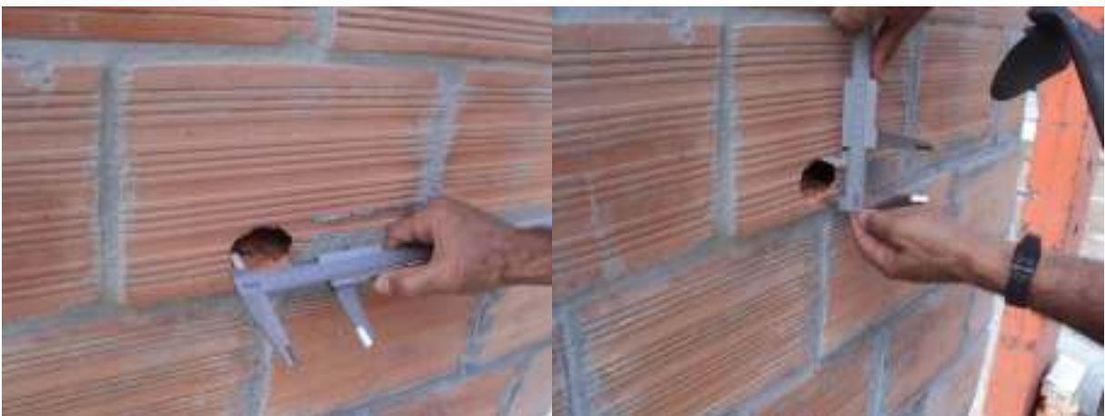
FIGURA 4.50 – Ensaio de corpo duro – medição das mossas para esfera de 1 kg (Parede Cerâmica)
