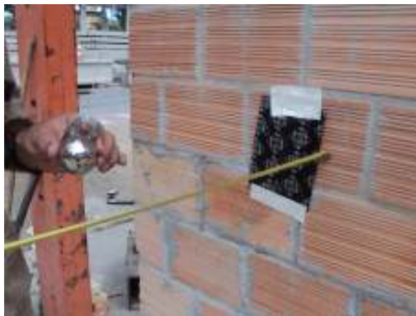
FIGURA 4.47 – Ensaio de corpo duro – esfera de 0,5 kg (Parede Cerâmica)
