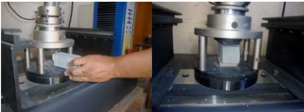
FIGURA 4.41 – Ensaio de resistência à compressão – argamassa industrial Fonte: Precon, 2010.
