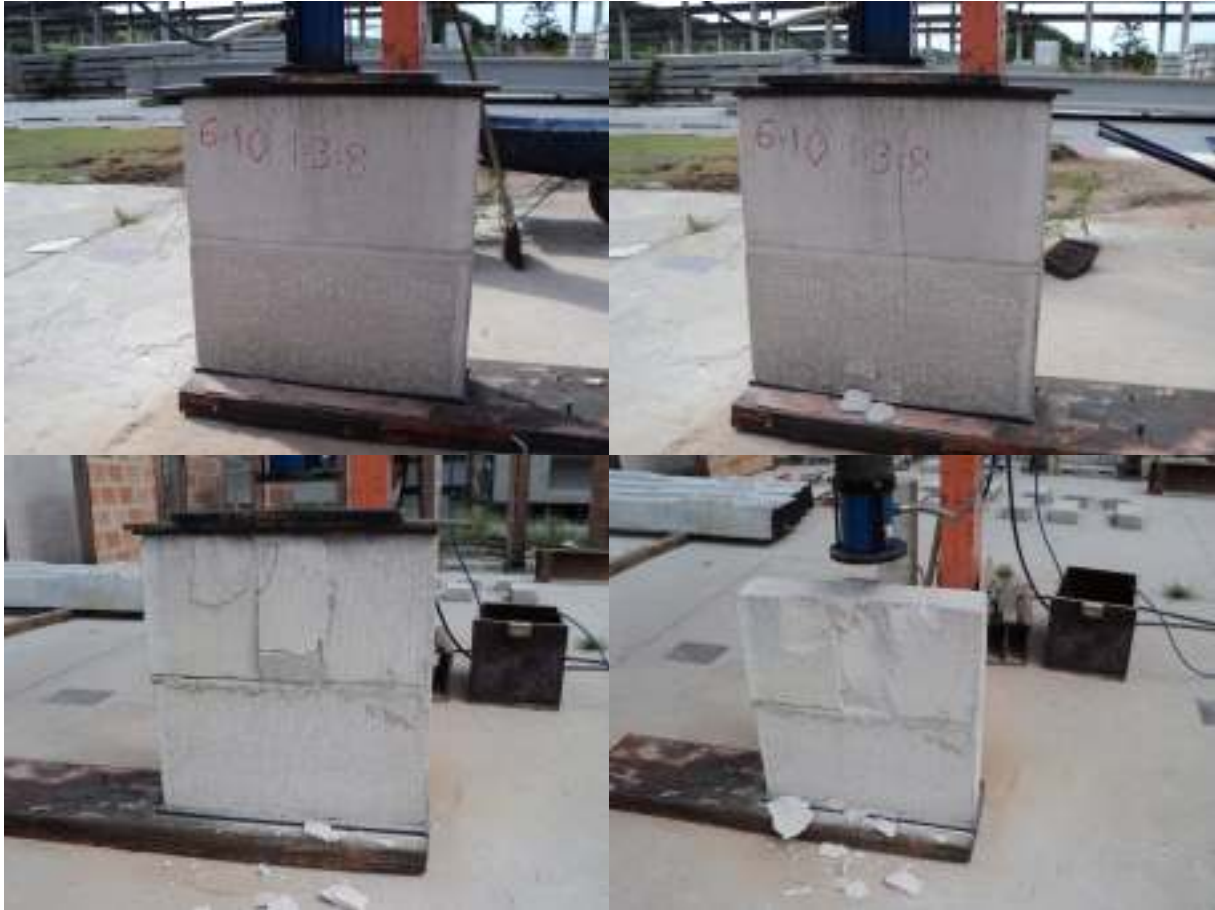
FIGURA 4.16 – Ensaio de compressão dos prismas BCCA – argamassa traço 1:3:8
