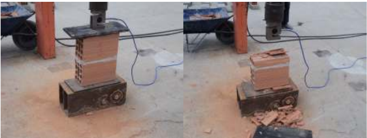
FIGURA 4.21 – Ensaio de compressão dos prismas cerâmicos – argamassa traço 1:3:8
