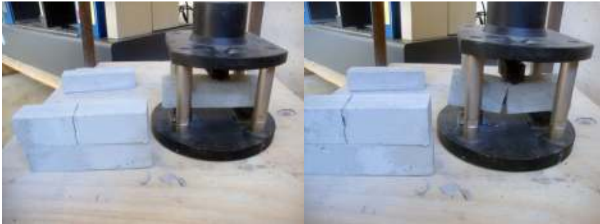
FIGURA 4.39 – Ensaio de resistência à tração na flexão – argamassa industrial Fonte: Precon, 2010.
