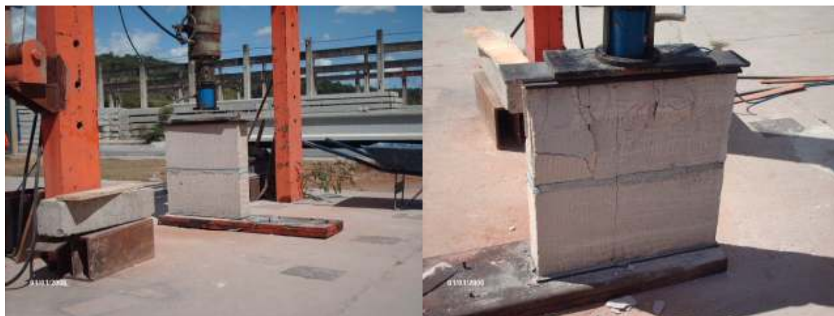
FIGURA 4.15 – Ensaio de compressão dos prismas BCCA – argamassa industrial
