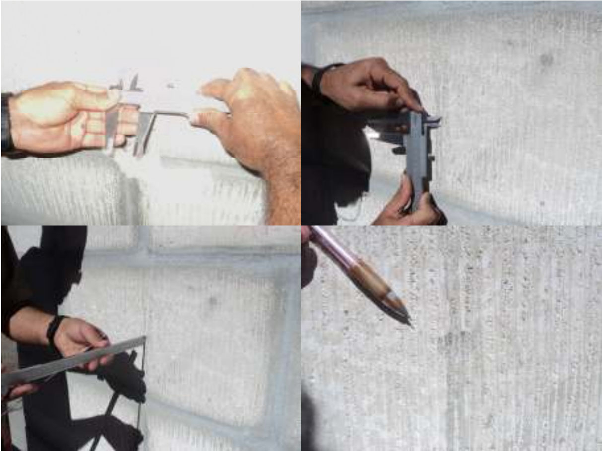
FIGURA 4.44 – Ensaio de corpo duro – medição das mossa para esfera de 0,5 kg (Parede BCCA)
