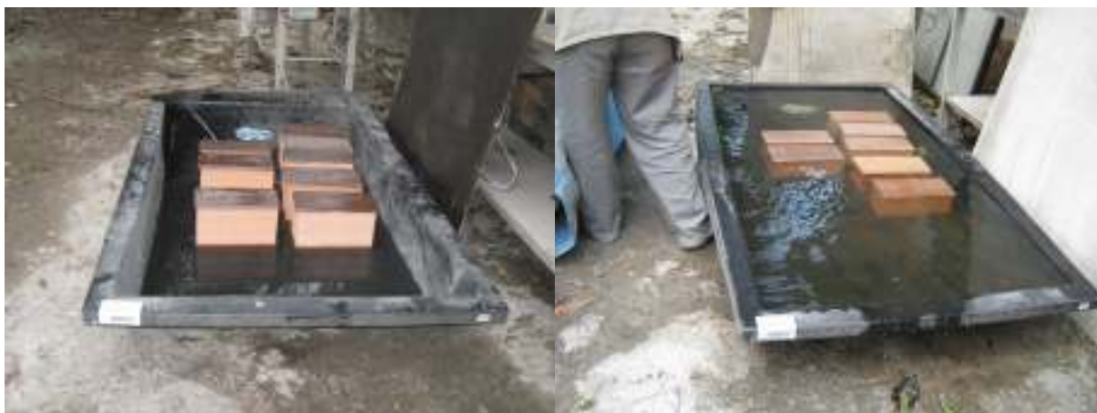
FIGURA 4.11 – Saturação dos corpos-de-prova cerâmicos
