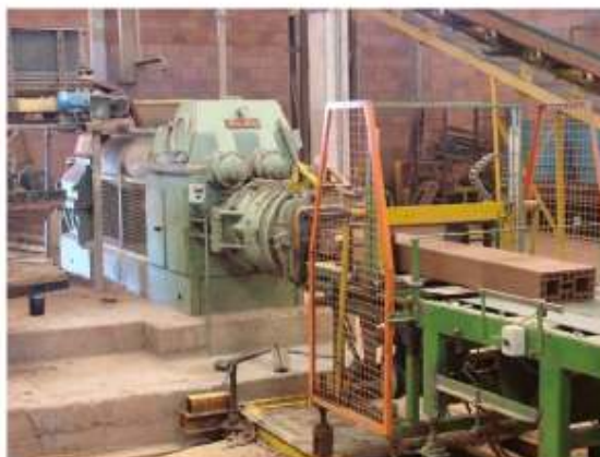
FIGURA 3.5 - Extrusão de filete de argila em maromba Fonte: IBRACON, 2007.
