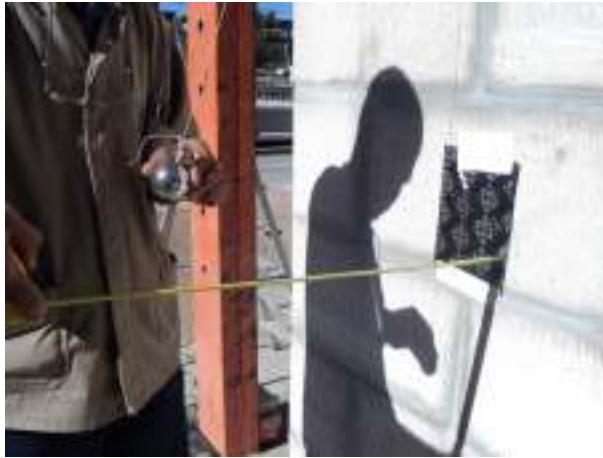
FIGURA 4.43 – Ensaio de corpo duro – esfera de 0,5 kg (Parede BCCA)
