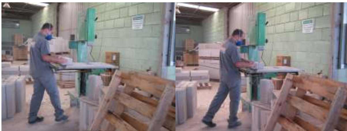
FIGURA 4.3 – Extração dos corpos-de-prova de CCA
