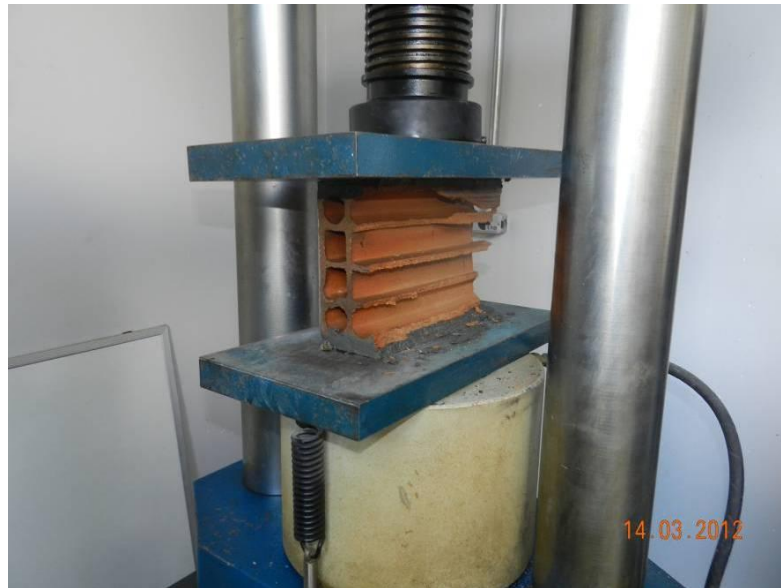
Figura 76 - Destacamento da lateral do bloco durante o ensaio de compressão - Bloco BI 01.
