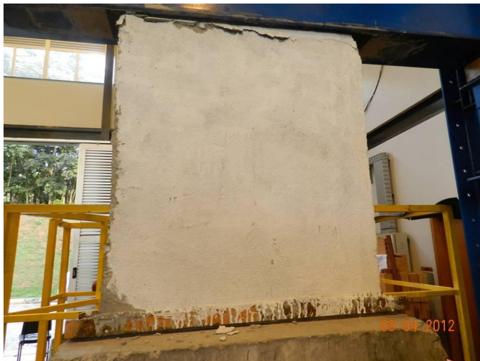
Figura 105 - Miniparede com reboco após ensaio - Trinca horizontal na região do capeamento.
