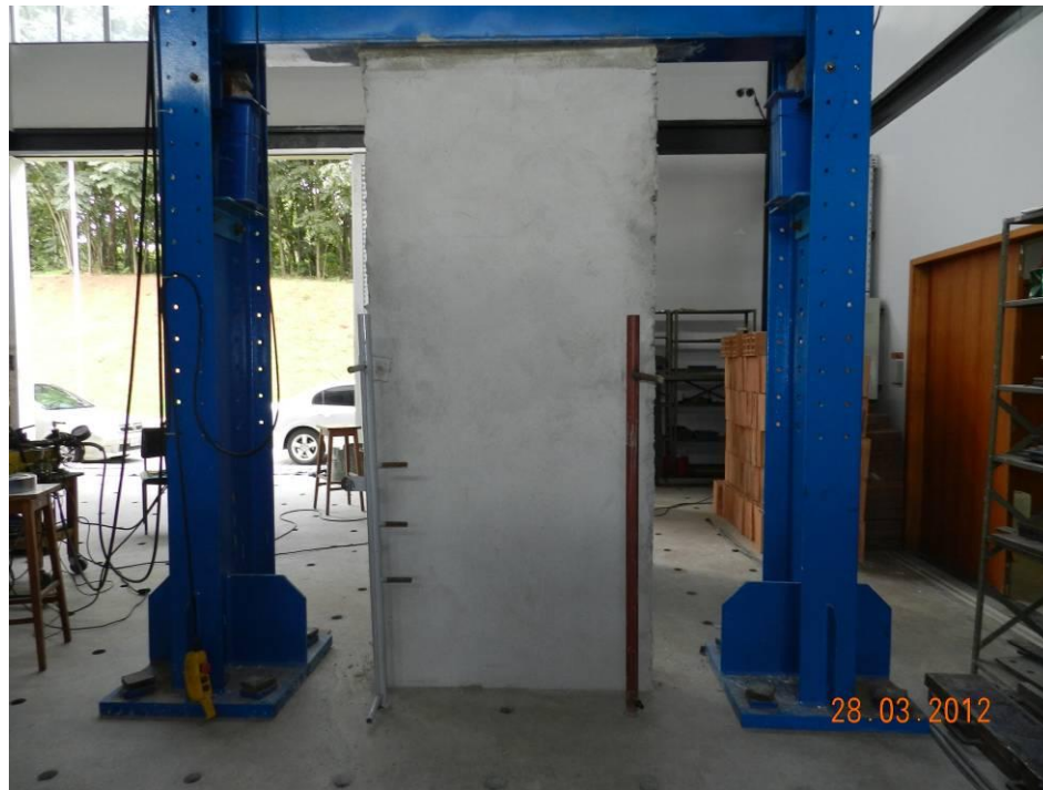
Figura 93 - Parede PAR-3, antes do ensaio.
