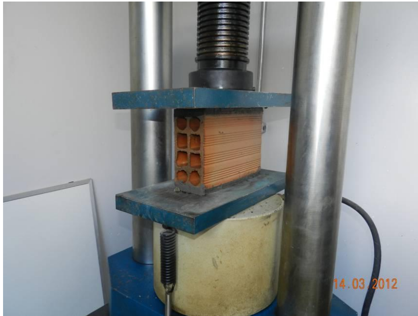
Figura 75 - Ensaio de ruptura dos blocos cerâmicos.
