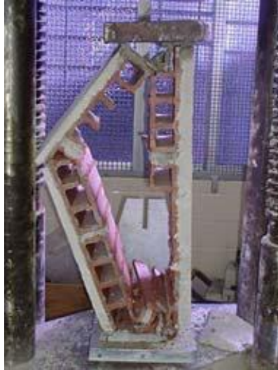
Figura 60 - Ensaio de compressão axial de miniparede, rebocada com espessura de 2 cm. Extraído de MOTA (2006)
