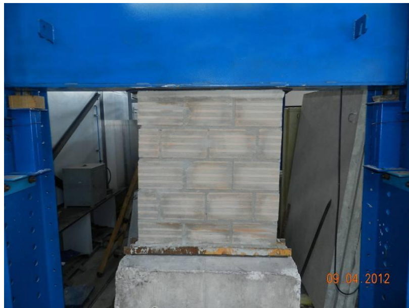
Figura 98 - Miniparede sem reboco antes do ensaio.
