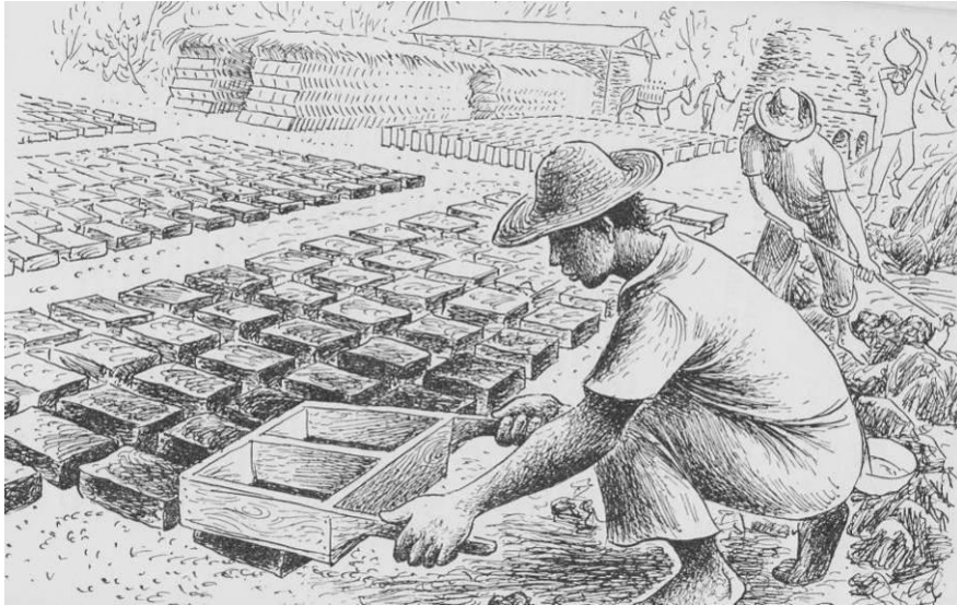
Figura 3 - Fabricação de tijolos de barro por oleiros - Ilustração de Percy Lau 4
