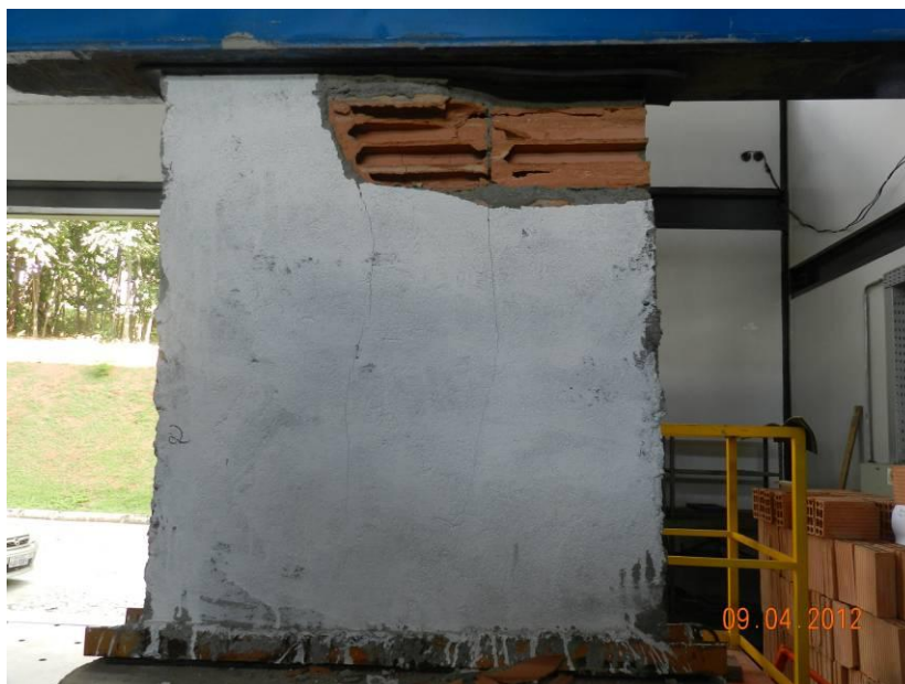
Figura 103 - Miniparede com reboco após ensaio (Verso da parede indicada na Figura 104)
