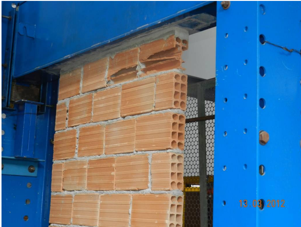
Figura 83 - Rompimento dos blocos da última fiada - PAR-1.
