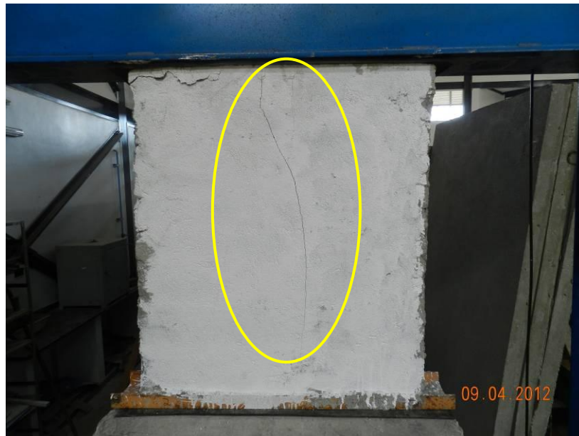
Figura 102 - Fissura vertical após rompimento da parede.
