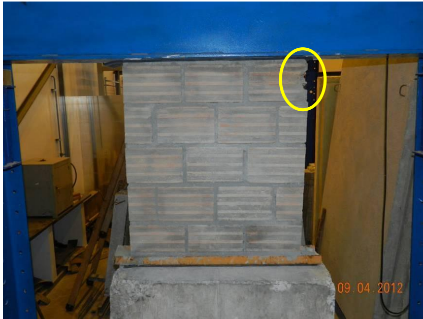
Figura 99 - Miniparede sem reboco antes do ensaio. No detalhe, pequeno defeito do bloco.
