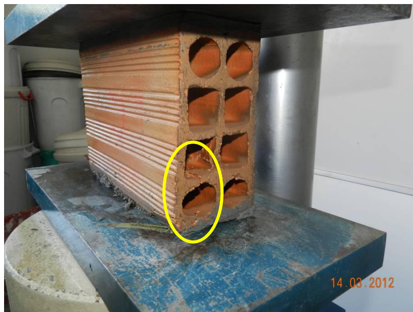
Figura 77 - Destaque ao rompimento do septo horizontal por tração - Bloco BI 02.
