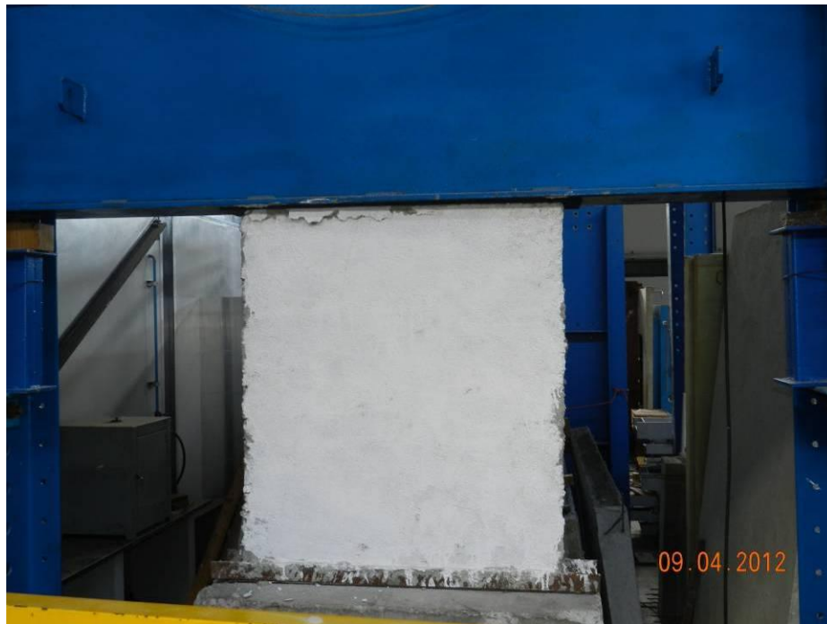
Figura 107 - Rompimento do capeamento.
