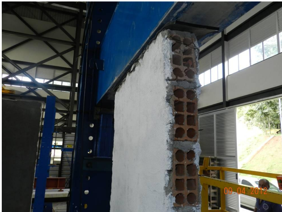
Figura 110 - Momento da ruptura - Separação dos septos dos blocos com destacamento do reboco.
