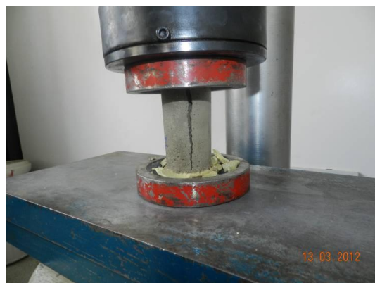
Figura 73 - Ensaio de ruptura da argamassa de assentamento.
