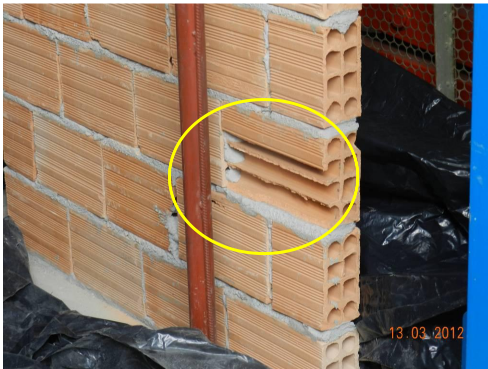
Figura 82 - Lascamento do bloco da 3ª fiada durante o ensaio. Parede ainda sob compressão.
