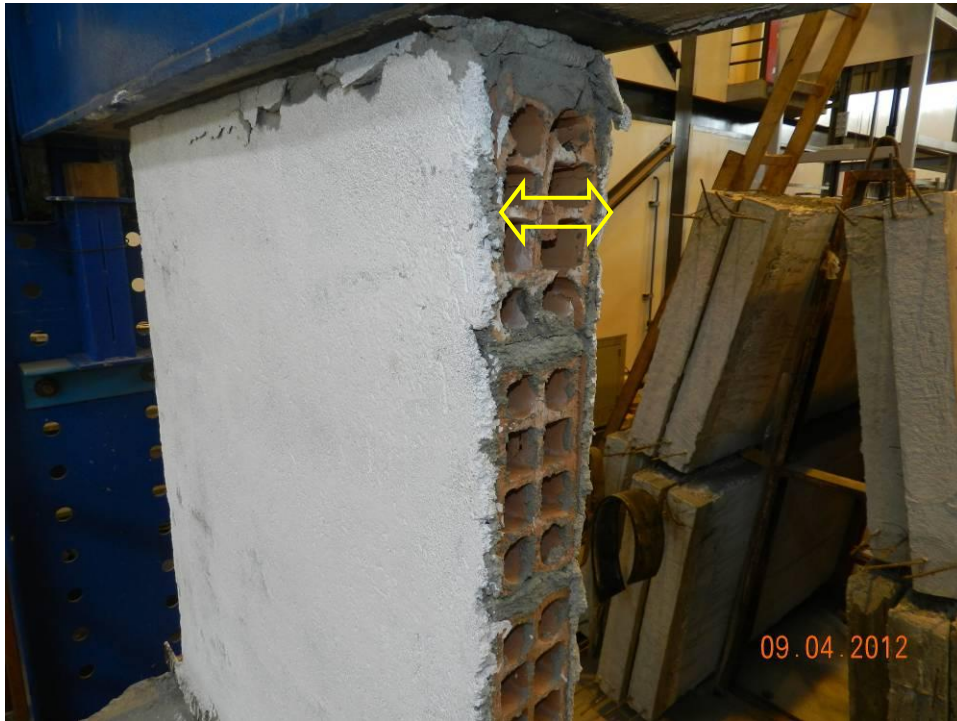
Figura 106 - Abertura do septo do bloco superior. Seta indica sentido da movimentação.
