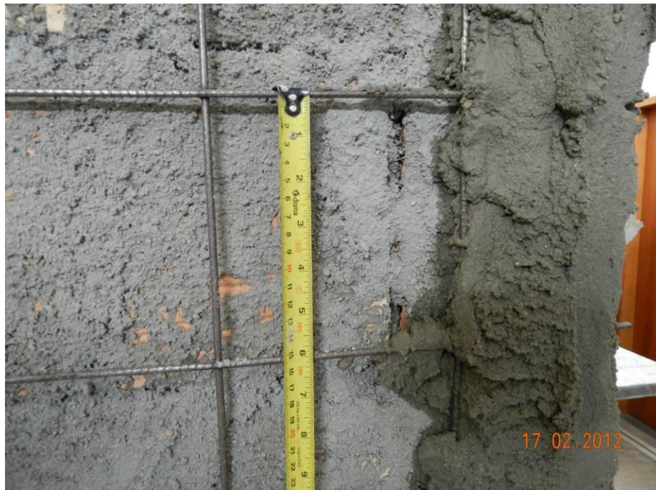
Figura 66 - Detalhe da tela inserida na argamassa de revestimento do corpo de prova - PAR-3.
