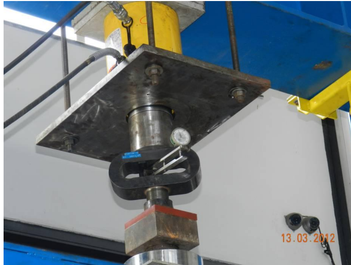
Figura 80 - Detalhe do anel dinamométrico (cor preta) e da célula de carga (cromada, na parte inferior).
