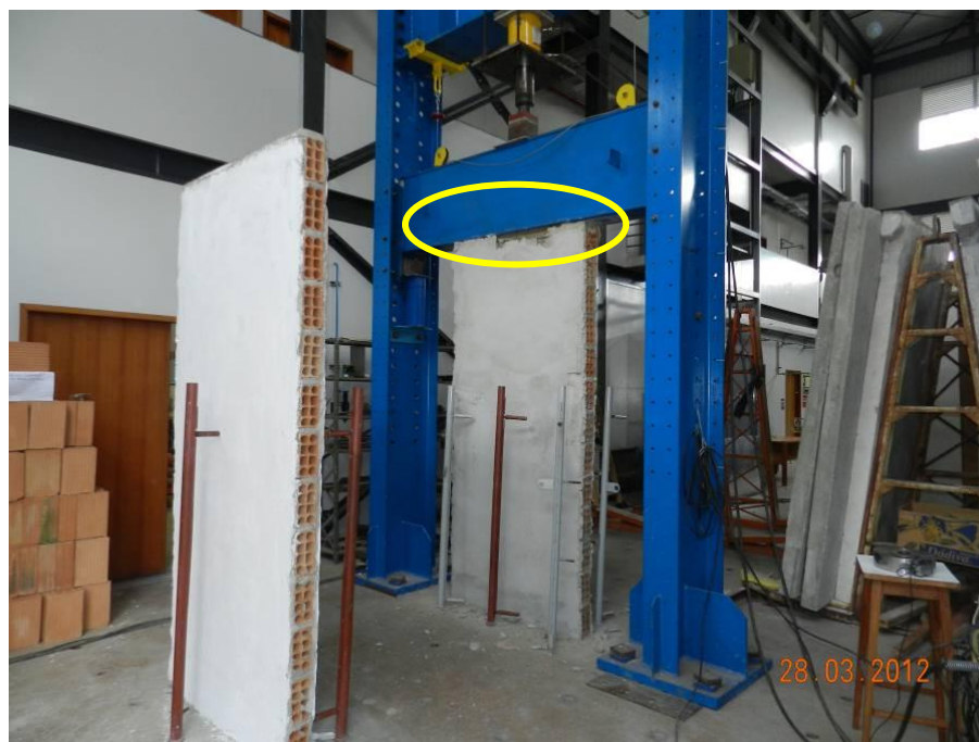
Figura 94 - Rompimento da Parede PAR-3, apenas na parte superior.
