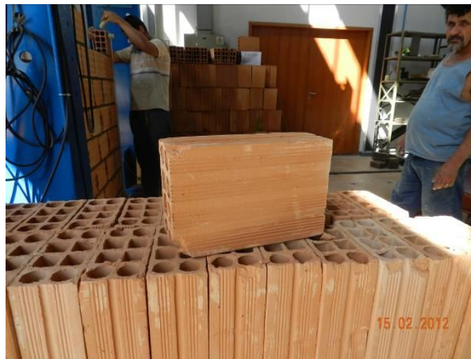
Figura 74 - Bloco de vedação usado nos ensaios.
