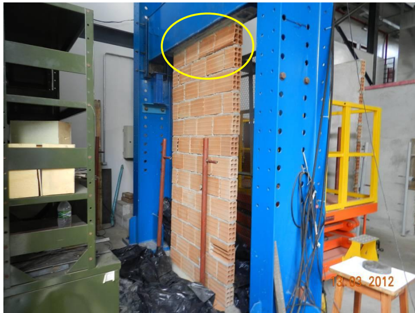
Figura 84 - Momento exato da ruptura do bloco da última fiada - PAR-1.
