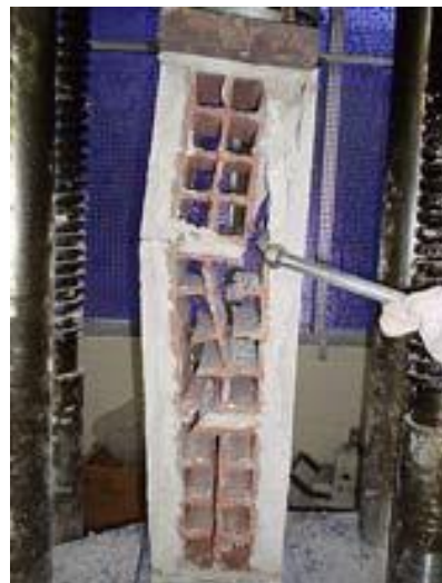
Figura 61 - Ensaio de compressão axial de miniparede, rebocada com espessura de 3 cm. Extraído de MOTA (2006)
