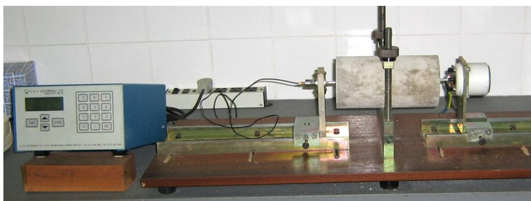
Figura 4-16 – Equipamento para determinar a freqüência ressonante - Erudite MKII (Laboratório de Materiais - UFMG)
