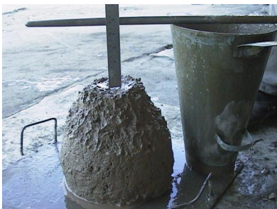
Figura 4-10 – Medição do abatimento do concreto em laboratório
