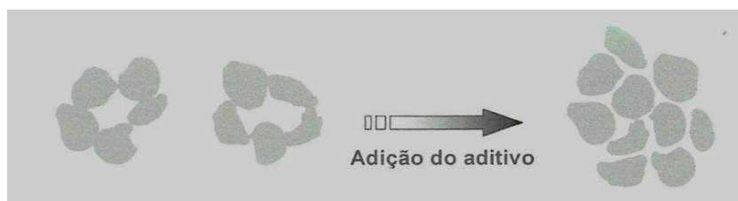
Figura 3-5 – Ação do aditivo redutor de água sobre a flocculação e deflocculação das partículas de cimento
