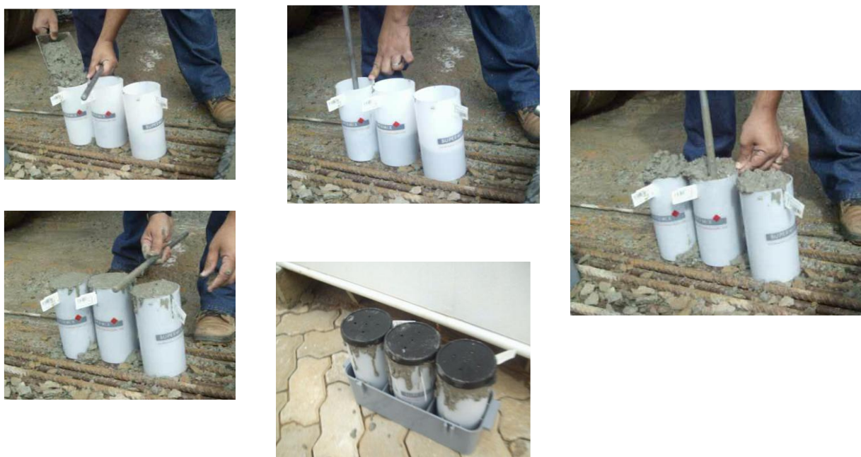
Figura 4-5 – Moldagem dos corpos-de-prova em campo
