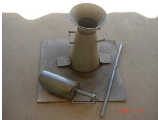
Figura 4-9 – Conjunto de equipamento para slump test
