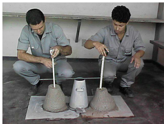
Figura 4-10 – Medição do abatimento do concreto em laboratório
