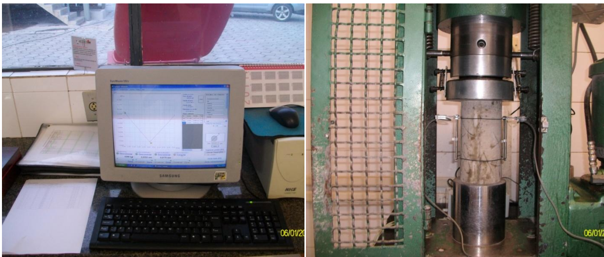
Figura 4-15 – Equipamento para determinação do módulo de elasticidade em concreto
