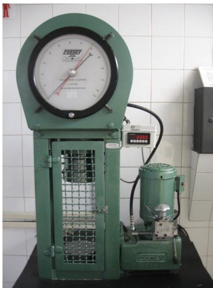
Figura 4-14 – Equipamento utilizado nos ensaios de compressão
