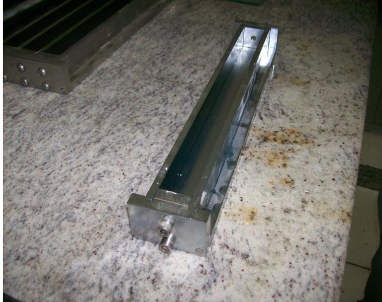
Figura 3.4-Forma metálica (seção quadrada de 25 (±)1 mm e comprimento mínimo de 250 mm) para execução de corpos de prova para ensaio de tração na flexão.
