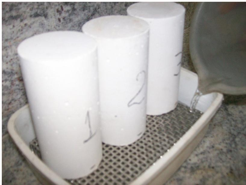
Figura 6.9-Aplicação de água para o ensaio de absorção por capilaridade.
