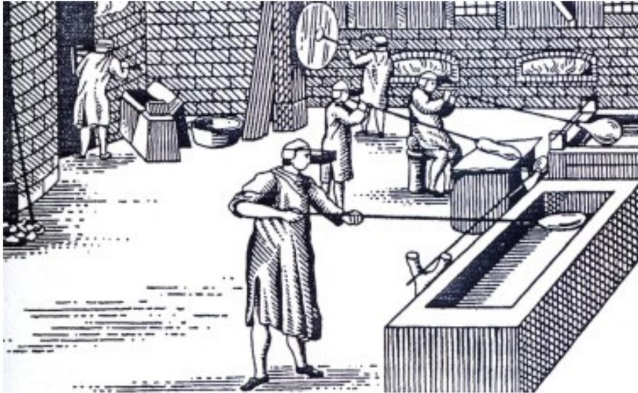
Figura 4.4-Processo de produção de vidros para janela no ano de 1800
