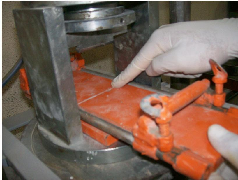
Figura 6.7-Dispositivo para apoio do corpo de prova – Ensaio de resistência à tração na flexão.
