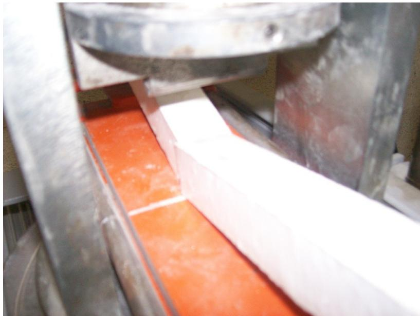
Figura 6.8-Rompimento do corpo de prova-Ensaio de resistência da tração na flexão.
