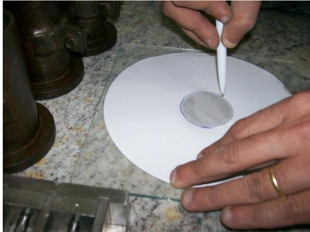
Figura 3.2-demarcação da mancha no ensaio de retenção de água.
