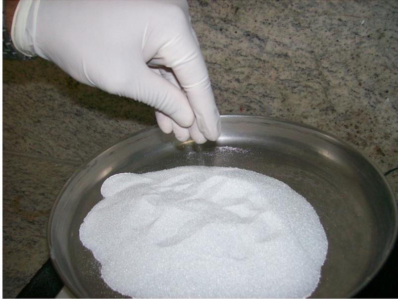
Figura 5.1-Microesferas de vidro para demarcação viária.
