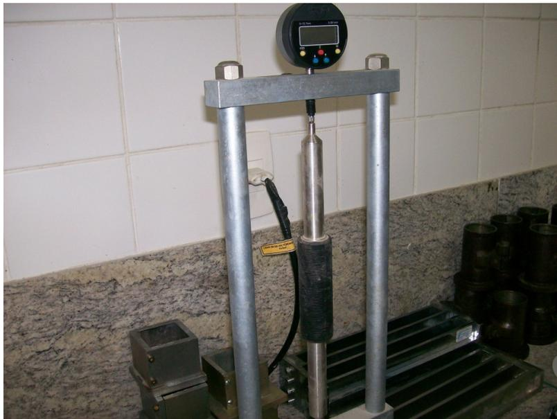
Figura 3.3-Suporte para medir a variação dimensional.
