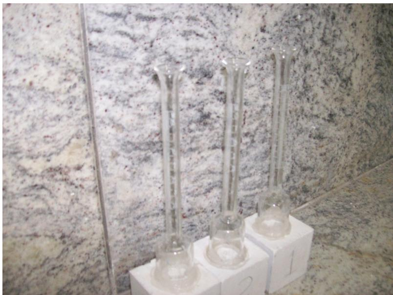
Figura 6.11-Coluna de vidro sobre os corpos de prova-Ensaio de permeabilidade.
