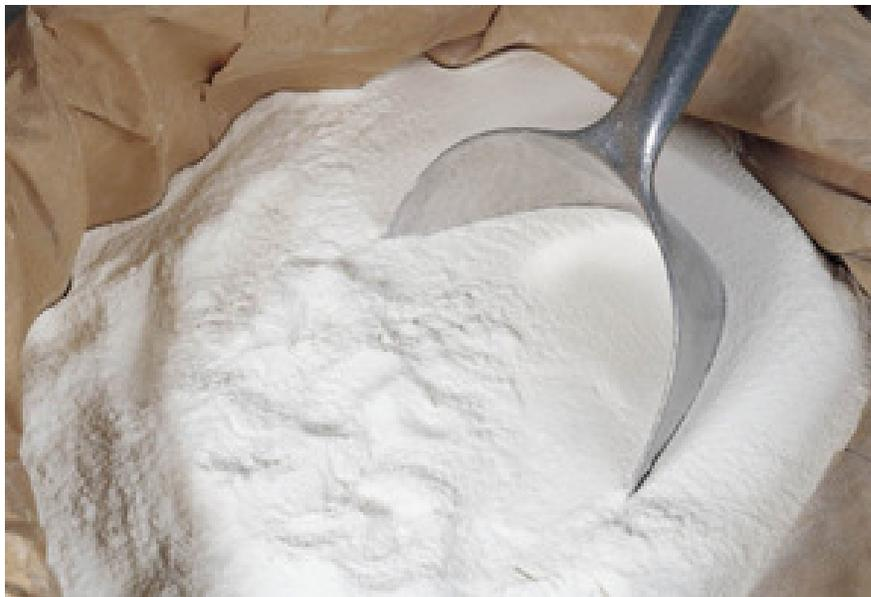
Figura 6.1-Aditivo retentor de água.
