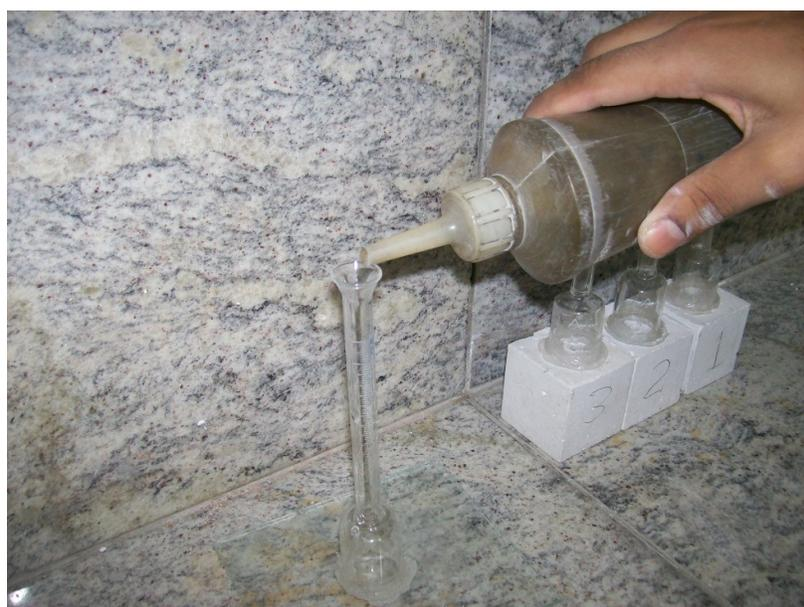
Figura 6.12-Preenchimento da Coluna de vidro usada como testemunho.
