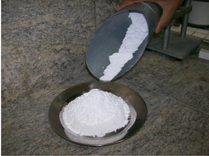
Figura 5.8-Calcita utilizada na fabricação do rejunte.
