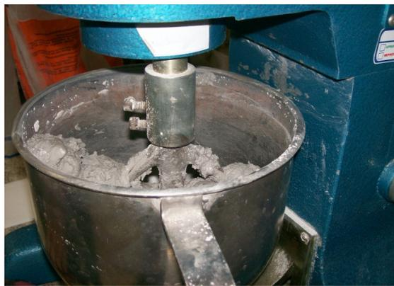
Figura 3.1- Misturador Mecânico utilizado na mistura de argamassas.
