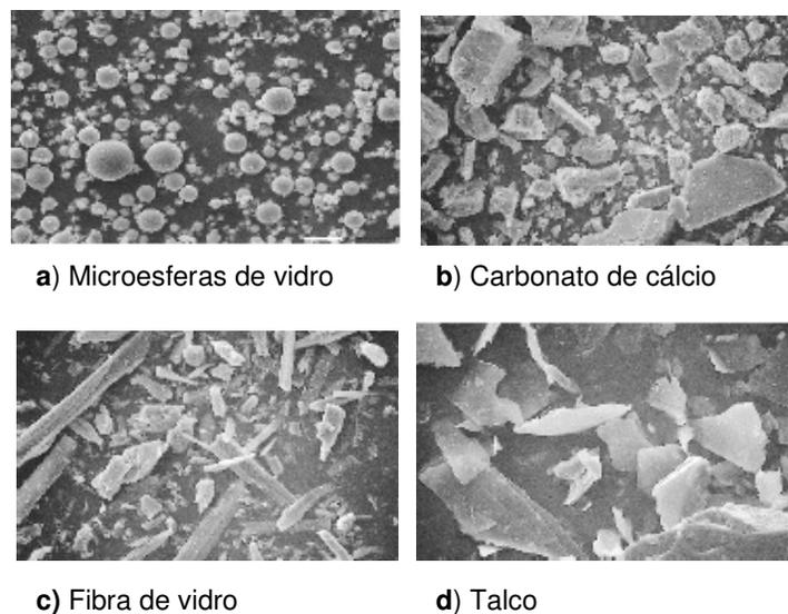
Figura 5.6-Comparação da geometria de diferentes materiais (b, c e d) com as microesferas de vidro (a) (3M, 2010).
