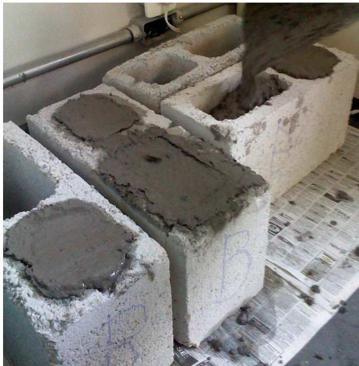
Figura 5.38: Blocos de concreto sendo preenchidos com micro concreto preparados para o ensaio de resistência à compressão.
