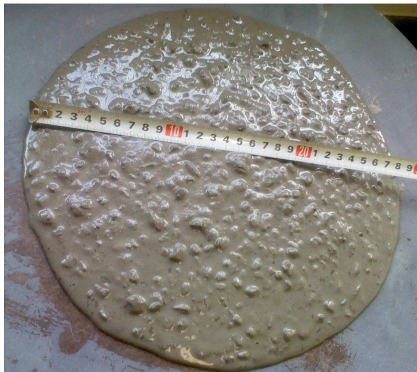
Figura 6.30: Ensaio de consistência do micro concreto, espalhamento (29cm), traço A2.
