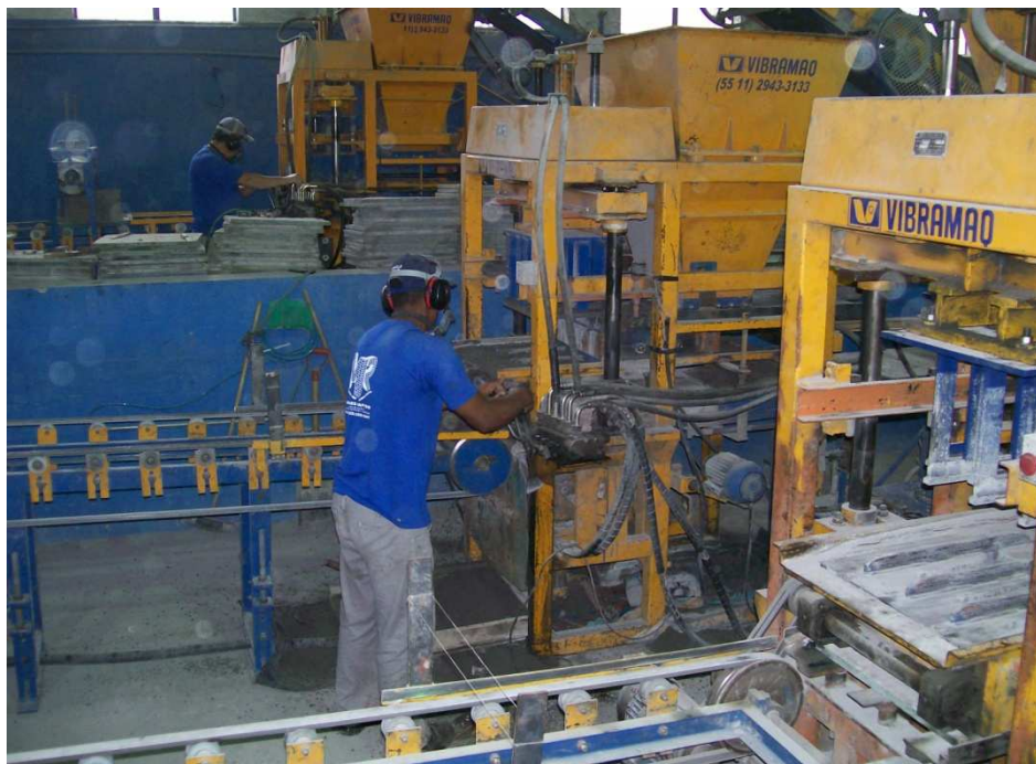
Figura 5.15: Prensa hidráulica e placa vibratória.
