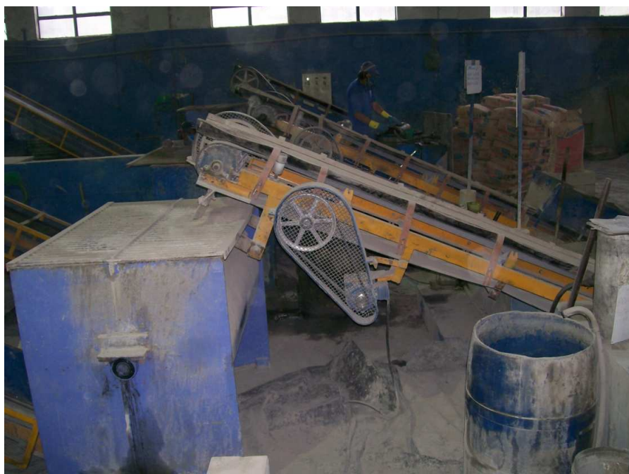
Figura 5.12: Final da esteira de transporte de materiais e cocho de homogeneização.
