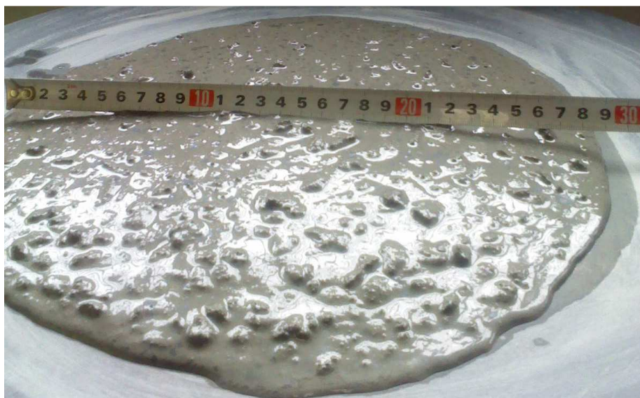
Figura 6.32: Ensaio de consistência do micro concreto, espalhamento (29cm), traço C2.
