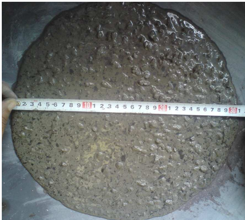
Figura 6.29: Ensaio de consistência do micro concreto, espalhamento (31cm), traço C1.
