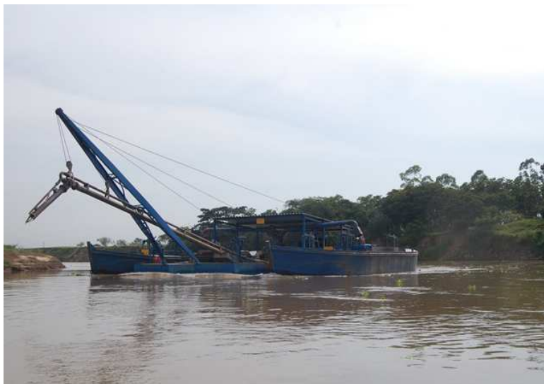
Figura 4.16 – Dragagem – Etapa do processo de extração da areia. Fonte: http://jornalcontato.blogspot.com/2011/03/extracao-de-areia.html .
