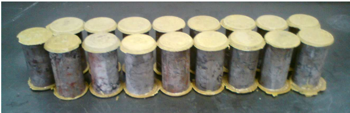
Figura 5.32: Corpos de prova de micro concreto já preparados com o capeamento de enxofre para o ensaio de resistência à compressão.
