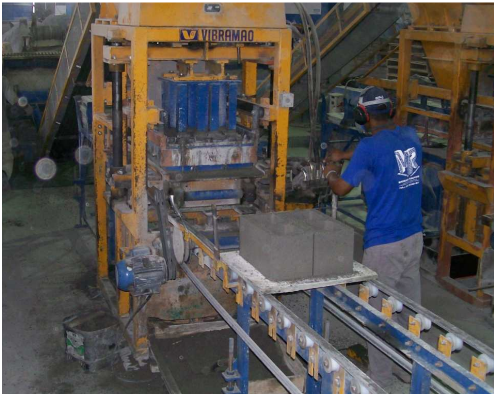
Figura 5.17: Blocos moldados e prontos para o acondicionamento nas prateleiras para cura.
