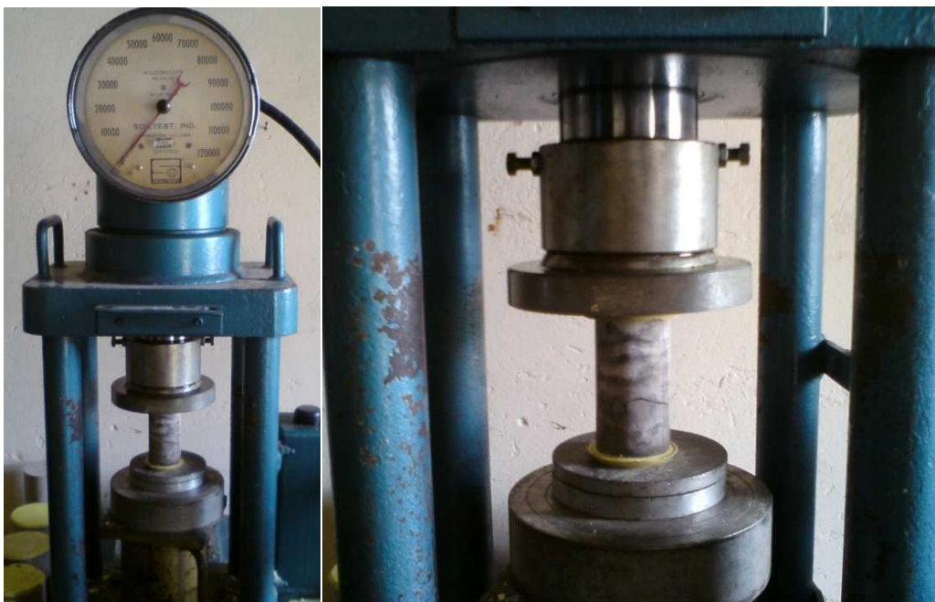
. Figura 5.33: Prensa do ensaio de resistência à compressão dos corpos de prova de micro concreto e bloco.
