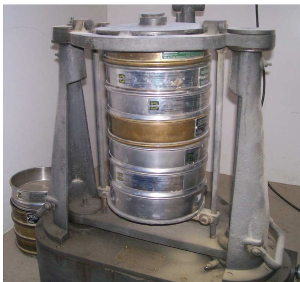
Figura 5.27: Granulometria – conjunto de peneiras 0,15 a 4,8 mm e agitador mecânico.
