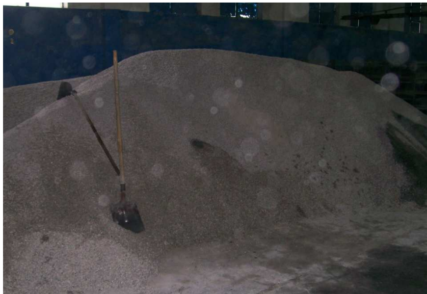
Figura 5.2: Estoque de brita 0 – Fábrica de Blocos de Concreto – Barbacena-MG
