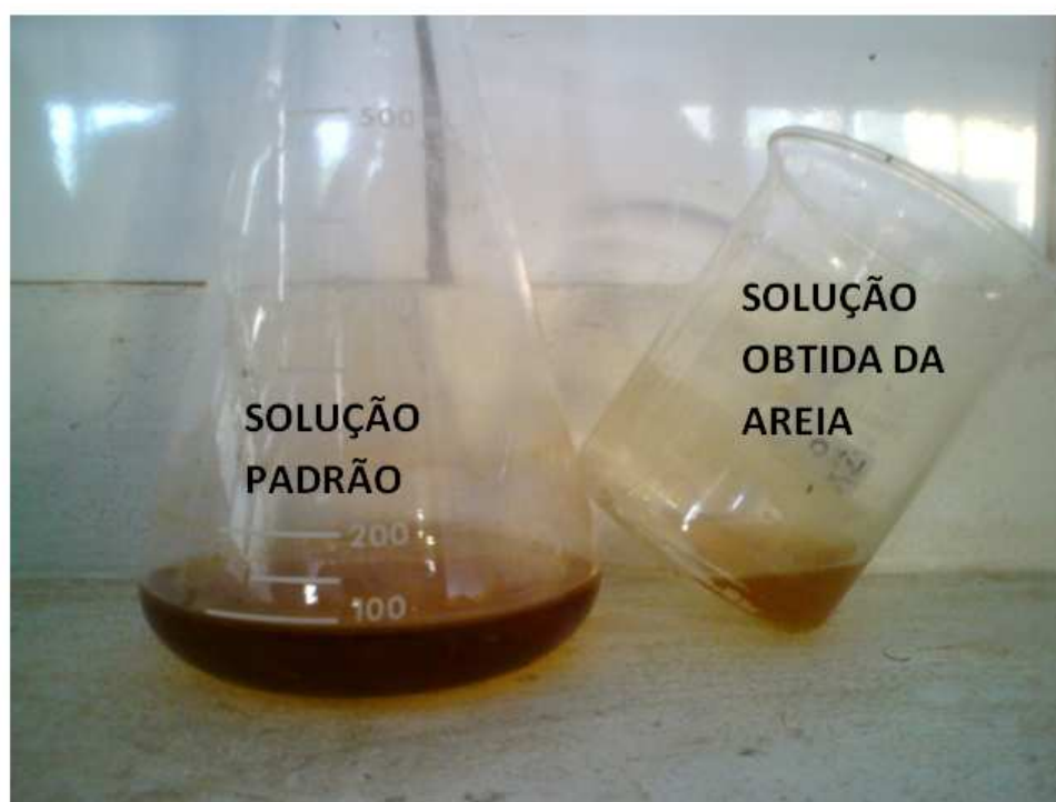
Figura 6.7: Ensaio colorimétrico para obtenção da matéria orgânica do agregado miúdo.
