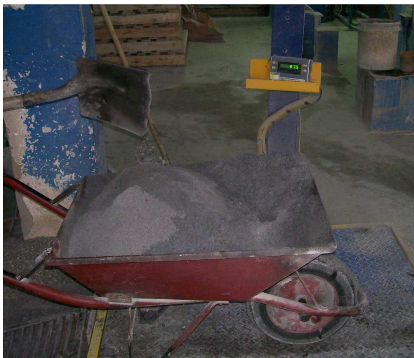
Figura 5.10: Pesagem dos agregados.
