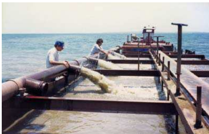
Figura 4.17 – Transporte até a área de estocagem – Etapa do processo de extração da areia.
