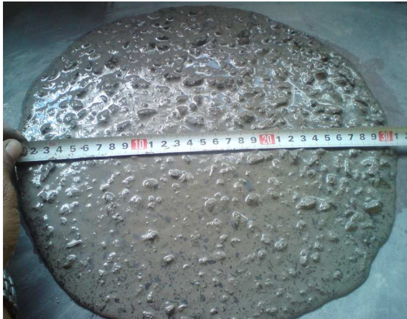
Figura 6.28: Ensaio de consistência do micro concreto, espalhamento (31cm), traço B1.
