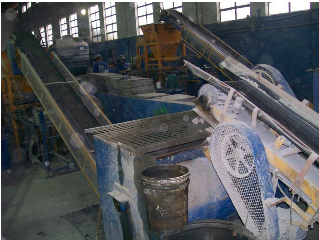
Figura 5.14: Esteira que encaminha a mistura à prensa.
