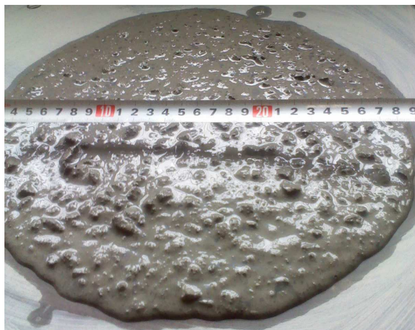
Figura 6.31: Ensaio de consistência do micro concreto, espalhamento (29cm), traço B2.
