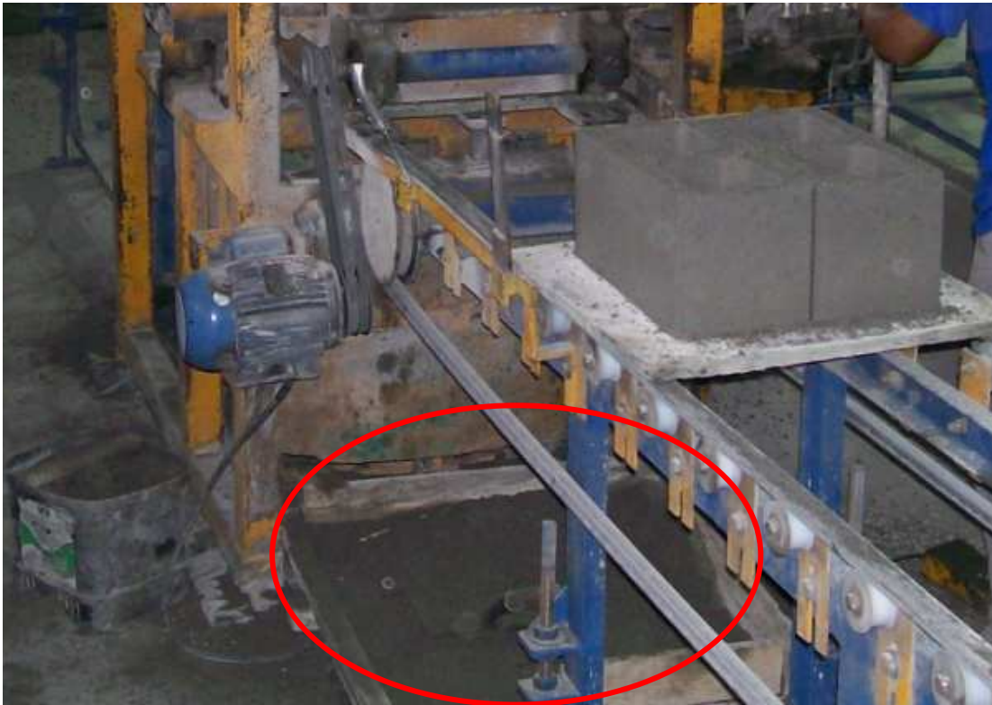
Figura 5.20: Resíduo gerado no processo de prensagem dos blocos.
