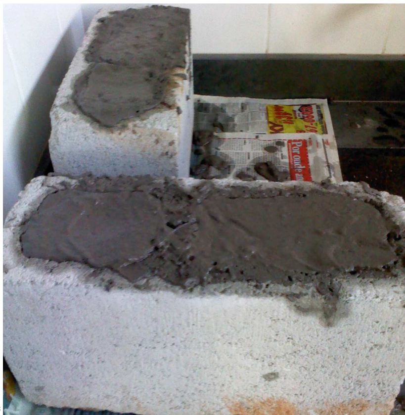
Figura 5.40: Blocos de concreto preenchidos com micro concreto e preparados para o ensaio de absorção.
