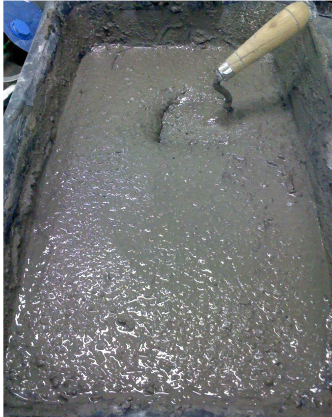
Figura 6.26: Micro concreto, traço padrão.
