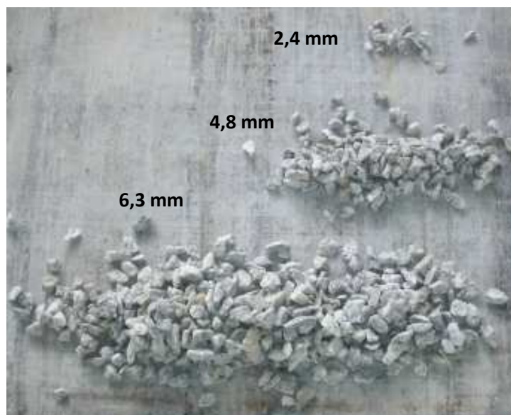
Figura 5.6: Separação granulométrica da brita 0. Fonte: Fábrica de Blocos de Concreto, 2011.
