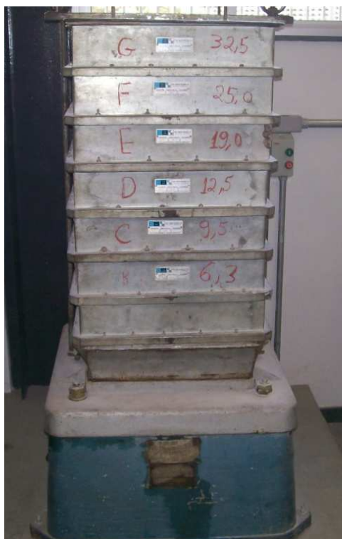
Figura 5.26: Granulometria – conjunto de peneiras 4,8 a 32 mm e agitador mecânico (peneirador).
