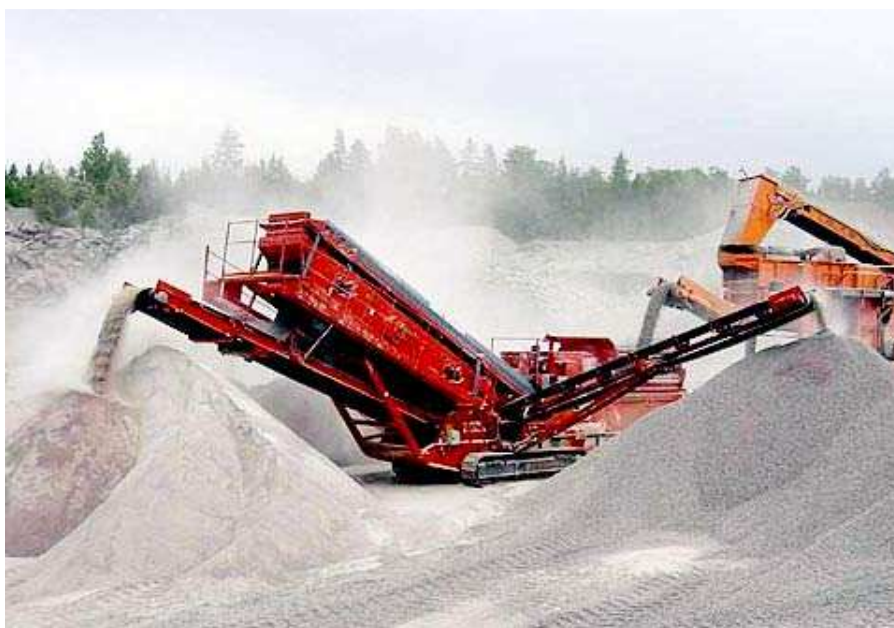
Figura 4.14 – Classificação – Etapa do processo de extração de pedra britada. Fonte: http://www.britadorpedra.com.br/blog/index.php/page/4/ .
