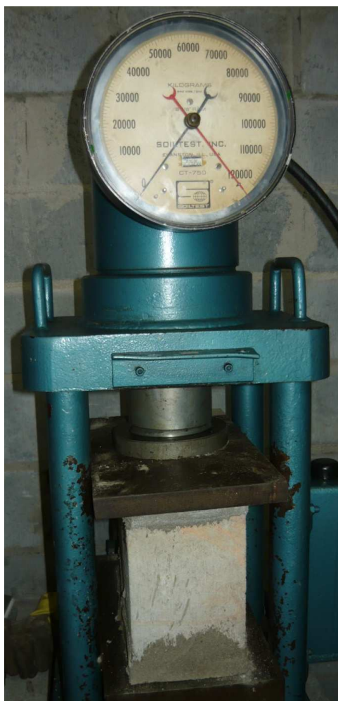
Figura 5.39: Ensaio de resistência à compressão dos blocos de concreto preenchidos com micro concreto, aos 28 dias de cura.
