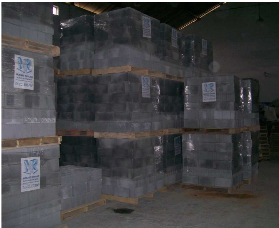
Figura 5.19: Blocos estocados, paletizados e embalados, prontos para o transporte.
