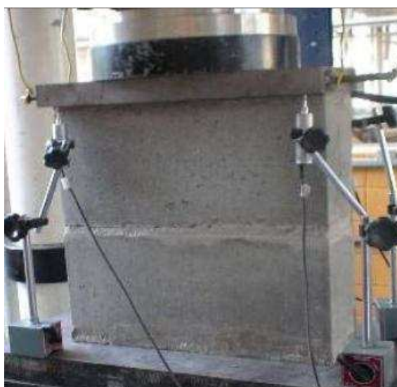
Figura 4.10: Ensaio de prisma de blocos de concreto estruturais.
