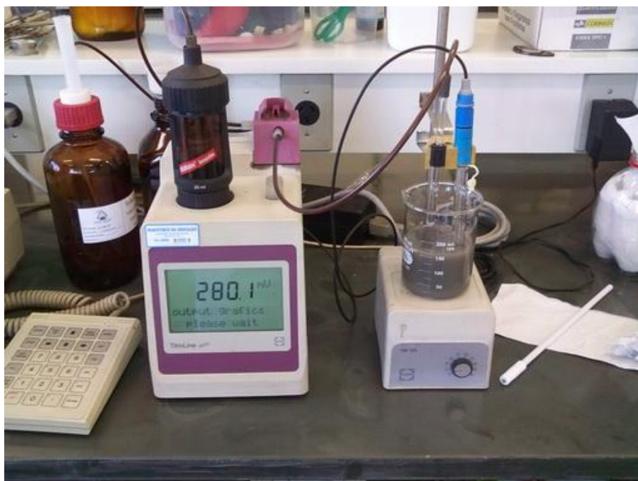
Figura 22 – Realização de ensaios de íons cloretos, utilizando o método potenciométrico.
