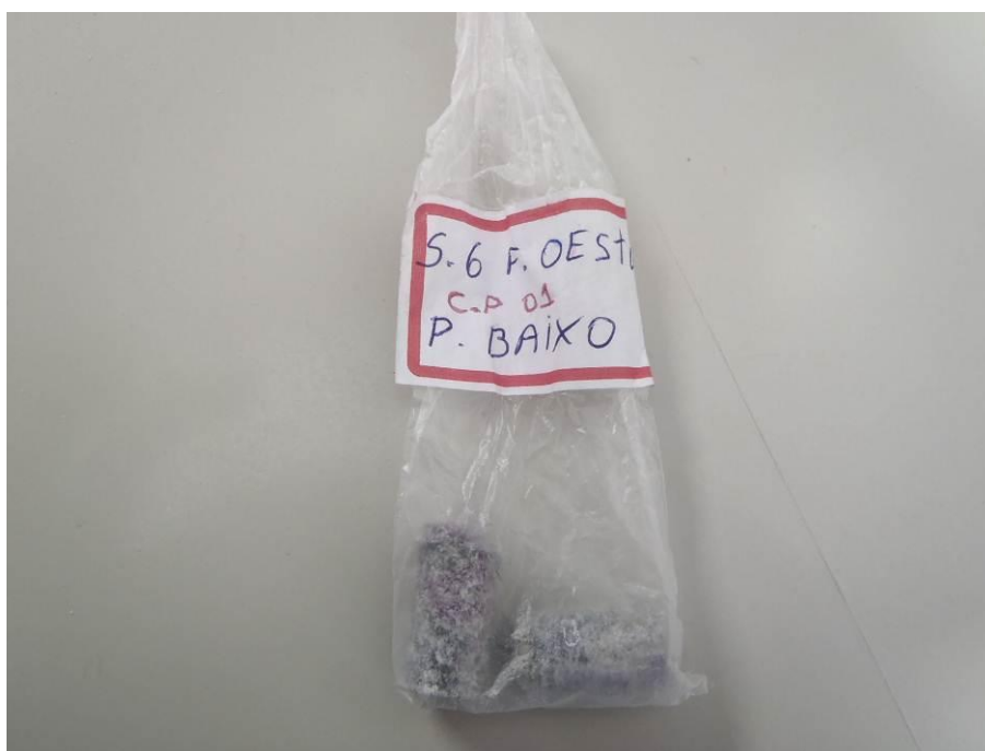
Figura 56 – Testemunhos de concreto do Pilar S6, sentido cidade de Vila Velha, face oeste.
