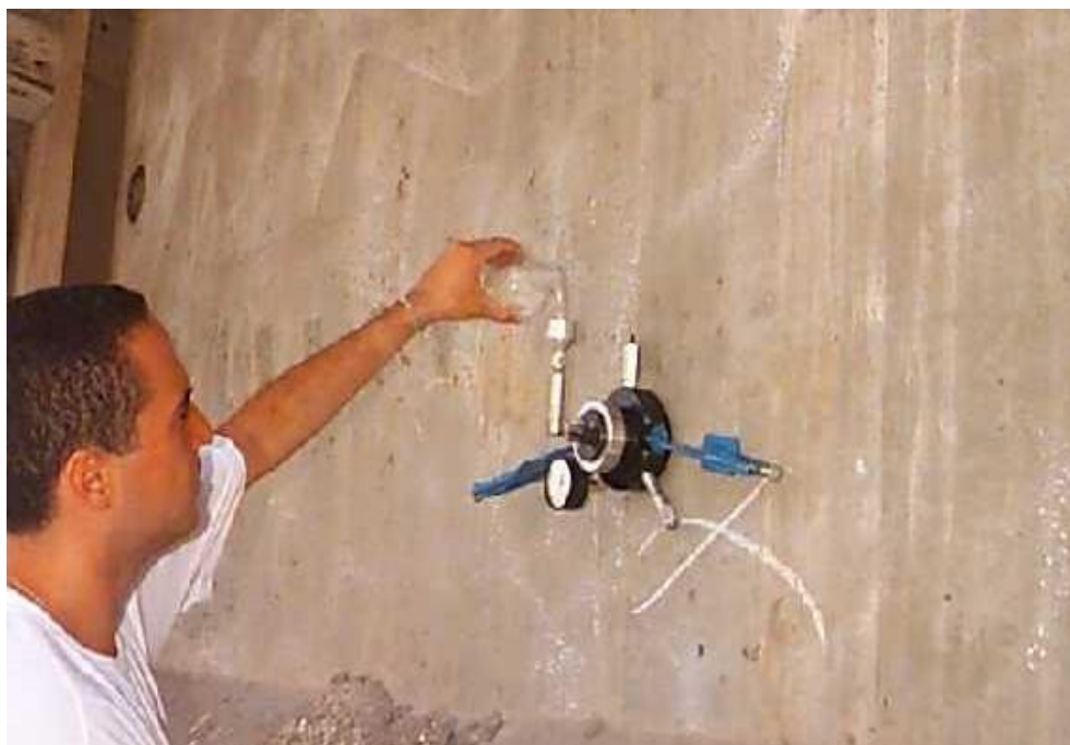
Figura 23 – Ensaio de permeabilidade em concreto realizada “in loco”.
