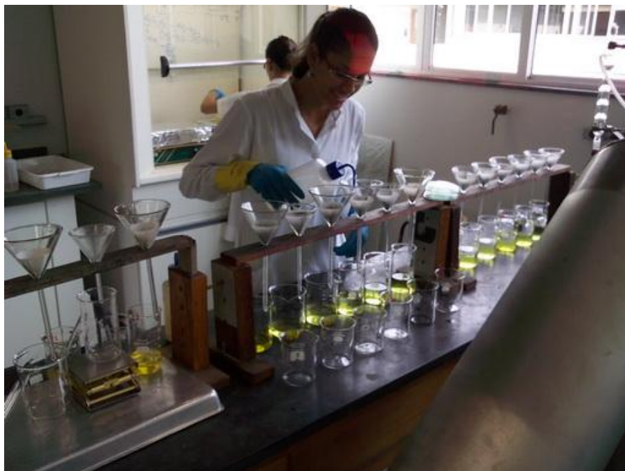
Figura 21 – Realização de ensaios de íons cloretos, utilizando o método gravimétrico.
