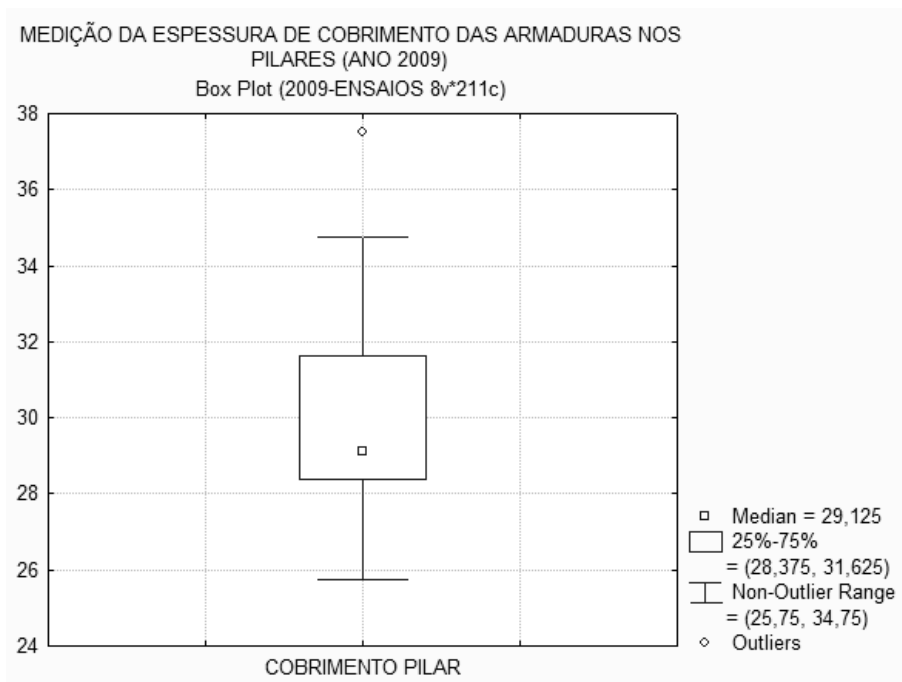
Figura 34: Ensaio de medição do cobrimento das armaduras nos pilares, realizado no ano de 2009.
