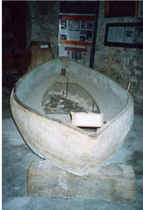
Figura 1 - Protótipo original do barco de Lambot, preservado no Museu de Brignoles, França.
