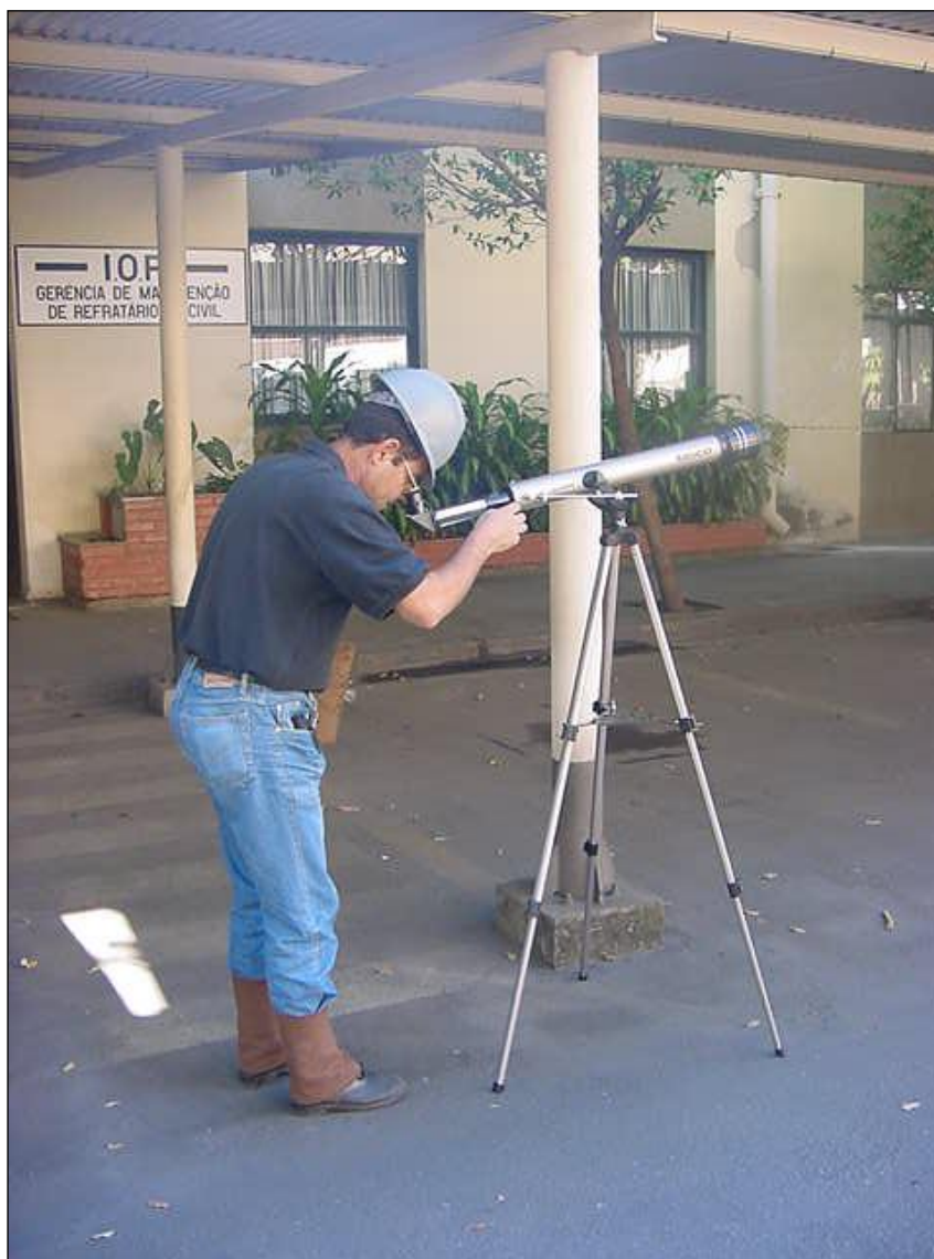
Figura 13 – Inspeção visual sendo auxiliada pelo uso de luneta. (Fonte: Empresa Recuperação Engenharia.)
