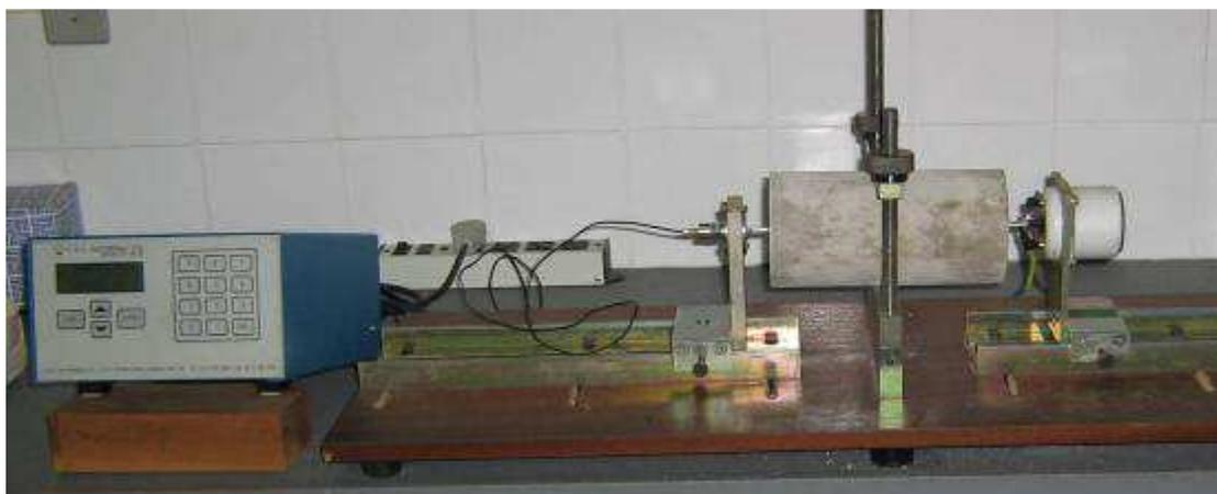
Figura 4.2 - Equipamento para determinar a frequência ressonante - Erudite MKII (Laboratório de Materiais - UFMG).
