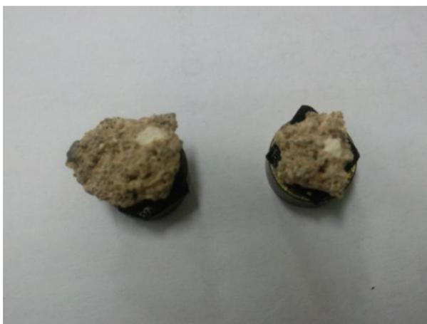
**FIGURA 43: Amostras sendo preparadas para recobrimento com película condutora.**
