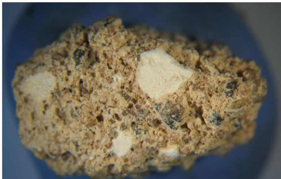
**FIGURA 52:** Fragmento tridimensional da argamassa. Escala em milímetros.
