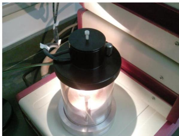
**FIGURA 44: Instrumento: Coater tipo Spi-Module Carbon Coater.**
