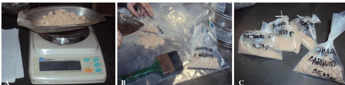
**FIGURA 40:** (A) balança para pesagem das porções; (B) ensacamento das porções; (C) identificação das porções.
