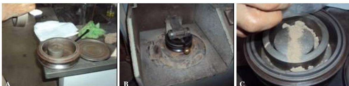
**FIGURA 41:** (A) limpeza do moinho de panela; (B) detalhe externo do moinho de panela; (C) detalhe interno do moinho de panela, com amostra pulverizada.
