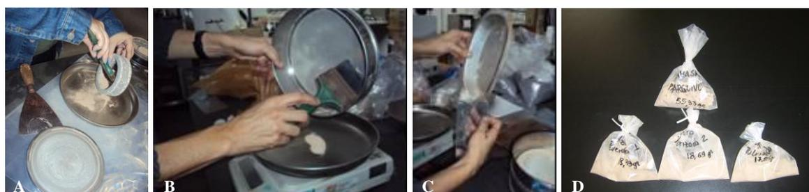
**FIGURA 42:** (A) remoção do material do moinho com pincel; (B) pesagem e (C) ensacamento do material pulverizado; (D) registro do peso das amostras.
