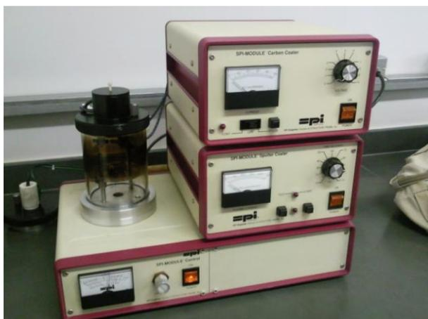
**FIGURA 45: Aparelho SPUTTER, utilizado para recobrimento da amostra.**
