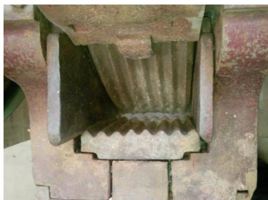
**FIGURA 37: Tritador (britador de mandíbula) - Detalhe.**
