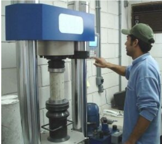
Figura 4.6– Prensa hidráulica digital EMIC para o procedimento de rompimento de concreto Fonte: Arquivo pessoal.
