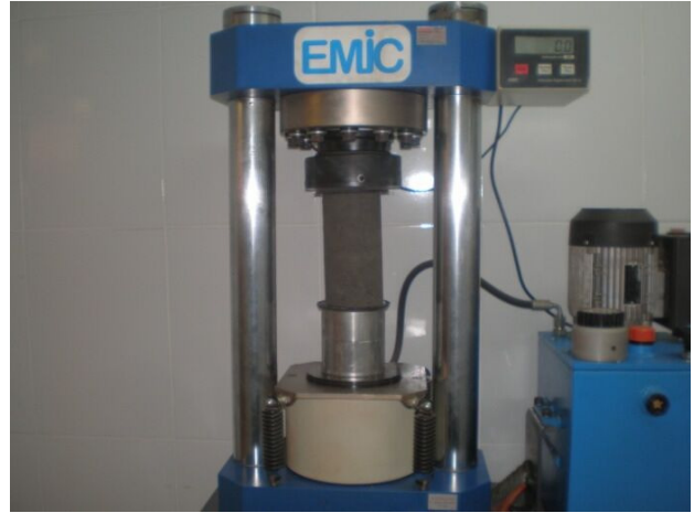
Figura 4.6– Prensa hidráulica digital EMIC para o procedimento de rompimento de concreto Fonte: Arquivo pessoal.
