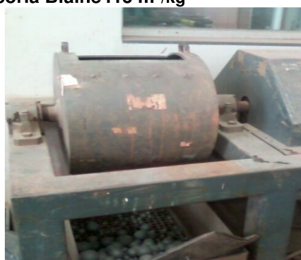
Figura 4.3 - Visão do moinho e da caçamba de recepção
