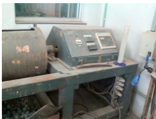
Figura 4.4 - Moinho e motor com temporizador
