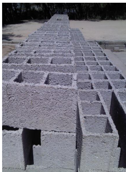
Figura 14 – Bloco produzido com material reciclado
