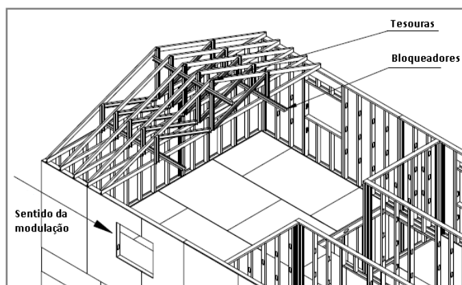
Figura 37: alinhamento dos painéis de cobertura e de vedação externa. Adaptado de Consulsteel (2006).
