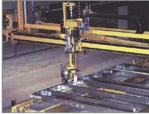
FIGURA 40: produção automatizada de painéis. Fonte: LSK (2005).
