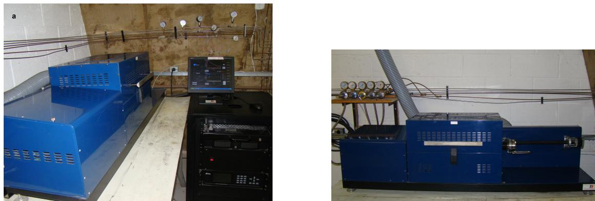
Figura 5.1: Forno CVD do laboratório de Crescimento de Nanomateriais: (a) vista frontal e (b) vista lateral.
