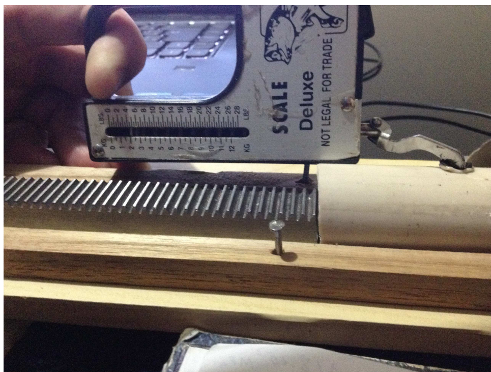
Figura H.7: Atuador Linear - Experimento para medição da força transmitida (2 kgf nesse caso, Zoom na balança).
