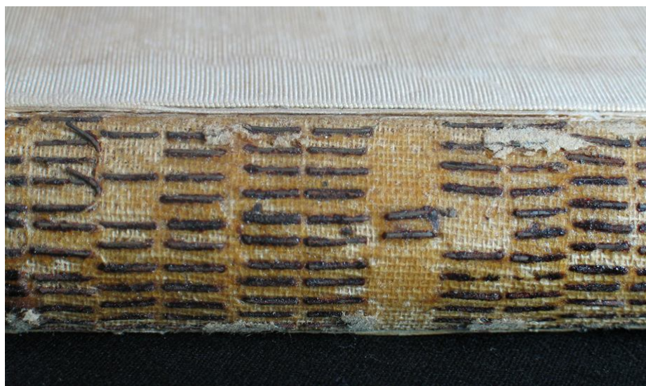
FIGURA 39 – Detalhe da oxidação dos grampos metálicos. Fonte: Coleção Rui Barbosa – livro do século XIX.
