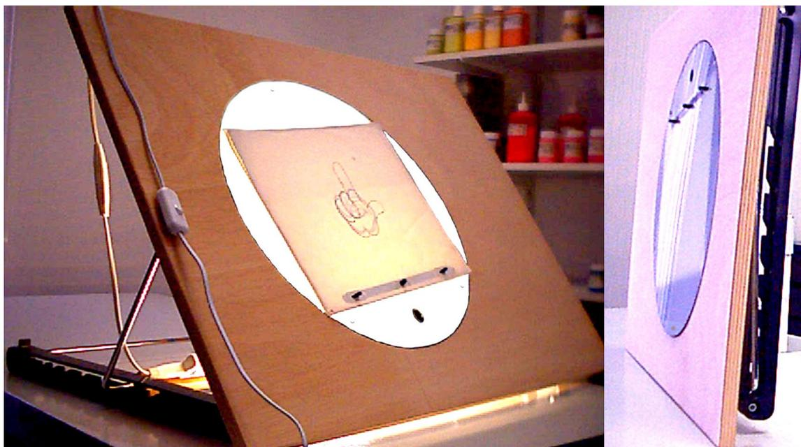
FIGURA 51: Mesa de luz com disco giratório e pino de registro padrão ACME.
