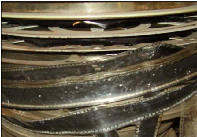
Figura 14- Filme encolhido e com síndrome do vinagre
