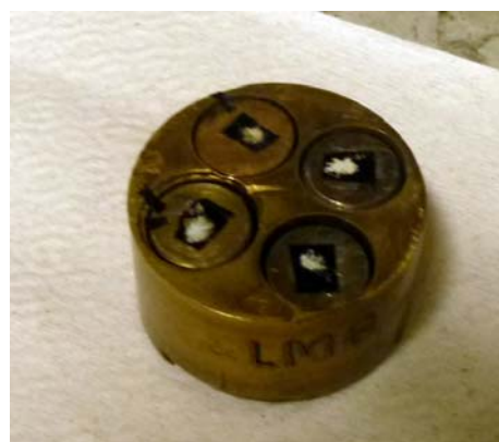
FIGURA 118 – Amostras no suporte do EDS prontas para análise.
