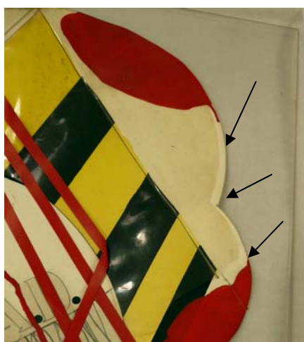
FIGURA 126 – Retrato de Antônio Dias. Encolimento do filme plástico causado pela migração do plastificante.
