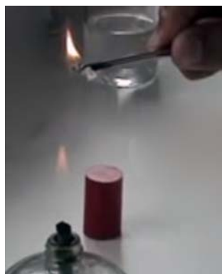
FIGURA 94 – Teste de Queima. Chama amarela indica poliestireno, poliuretano
