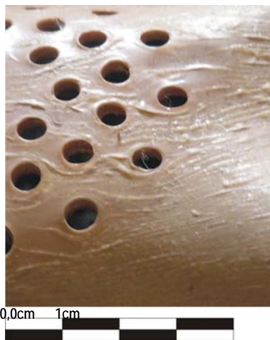
FIGURA 99 – Boneca Meu Sonho. Formação de bolhas na superfície ( Blister ) gerada pela emissão de produtos voláteis.
