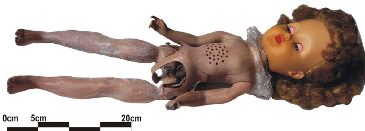
FIGURA 96 – Boneca Meu Sonho, com o corpo em adiantado estado de degradação. Notar a retração e diminuição de volume do mesmo em relação à cabeça. Não foi possível acompanhar a diminuição de massa uma vez que não há registros anteriores. Notar a “interface” entre cabeça e corpo realizada com filme plástico (pvc?).
