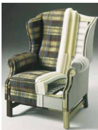
FIGURA 72 – Fotografia apresentando a estrutura interna de uma cadeira da década de 1940 – ilustrando a presença da espuma de poliuretano em seu interior.
