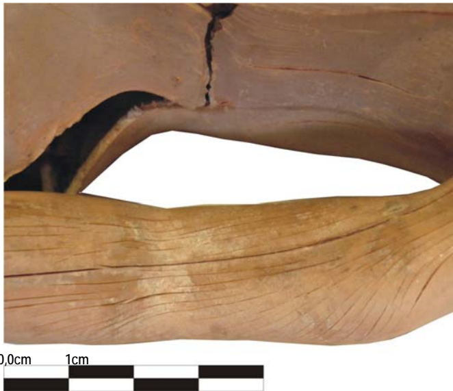
FIGURA 97 Boneca Meu Sonho. Fragmetação do abdômen e fissuração do braço no sentido longitudinal (da injeção do plástico no molde).
