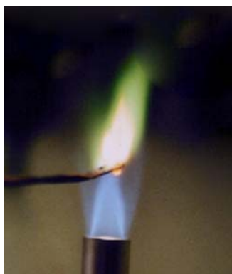
FIGURA 93 – Teste de Beilstein realizado para identificar o PVC. A chama esverdeada indica a presença de cloro.
