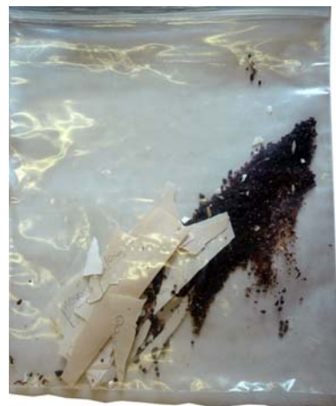
FIGURA 116 – Fragmentos de um pente. O processo autocatalítico chegou ao ponto de deteriorar completamente o pente dentro do saco plástico.
