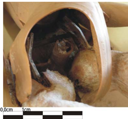
FIGURA 100 – Boneca Meu Sonho. Vista do mecanismo interno em metal oxidado.
