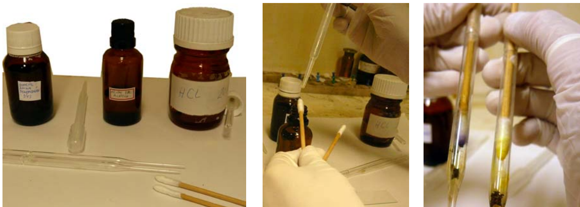
FIGURA 92 – Ensaio realizado pela autora para a identificação de poliamida, policarbonato e poliuretano. Nas pipetas, à direita, a cor azul significa positivo para poliamida (nylon) e a amarela para poliuretano. Outro resultado possível é o avermelhado para o policarbonato, mas não encontramos este material no acervo.
