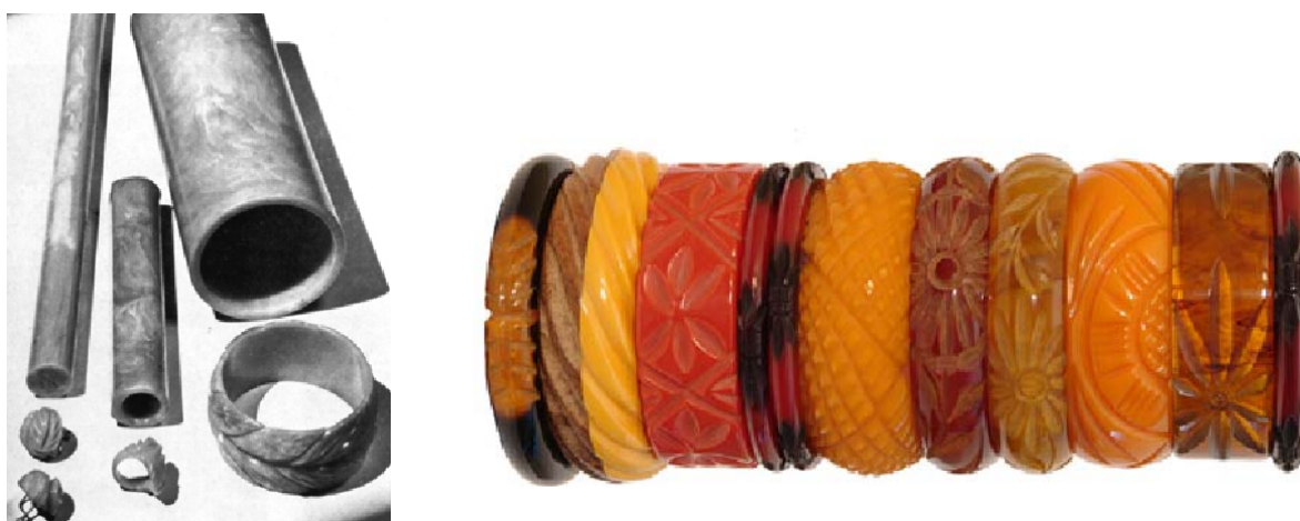
FIGURA 18 – Processo de produção das jóias em Baquelite. Tubos extrudados, serrados e usinados de forma artesanal. Fonte: http://www.countryliving.com/antiques/appraisals/antique-accessories-appraisals-0209
