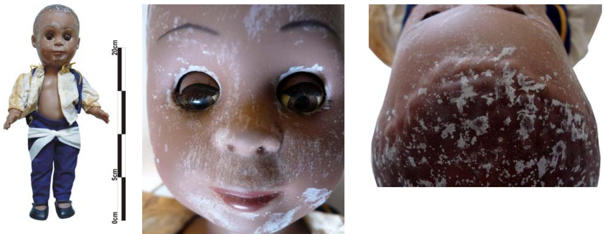
FIGURA 107 – Boneca Pepito. Detalhe da face e parte posterior da cabeça com exudação.
