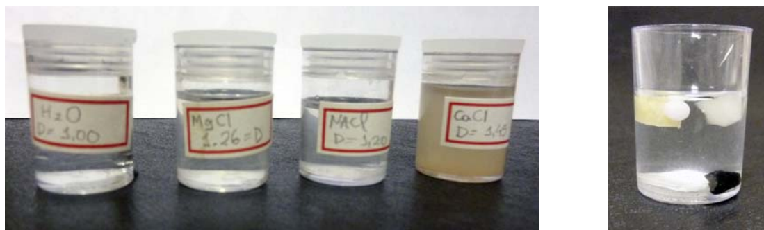
FIGURA 89 – Quatro das soluções salinas e o álcool isopropílico preparados para o teste de Densidade Específica.
