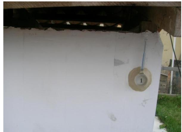
FIGURA 75- Absorção de água pela caiação artesanal. Fonte: autor (2010).
