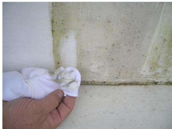
FIGURA 135 - Lavabilidade da tinta de silicato. Detalhe. Fonte: autor (2010).
