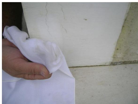
FIGURA 137 - Lavabilidade da tinta premium. Detalhe. Fonte: autor (2010).
