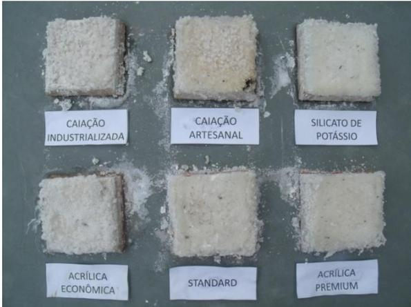
FIGURA 64 – Amostras com crosta de sulfato de sódio cristalizado. Fonte: autor (2010).
