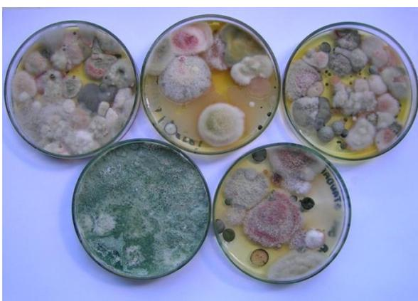
FIGURA 122- Placas de Petri com crescimento de fungos filamentosos: agentes biológicos da deterioração das tintas. Fonte: autor (2009).
