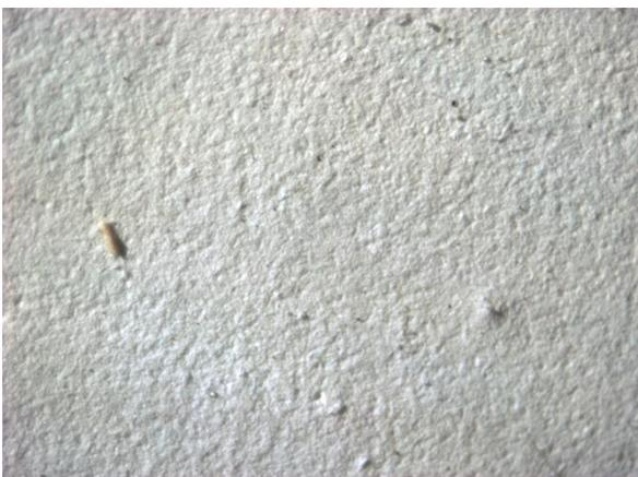
FIGURA 56 - Microfotografia estereoscópica - ampliação 45 vezes. Amostra 05 (silicato de potássio).
