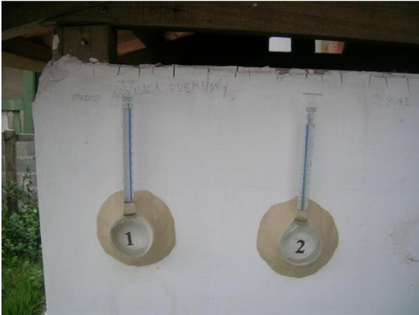
FIGURA 72 - Absorção de água pela tinta premium (1) e silicato de potássio (2). Fonte: autor (2010).
