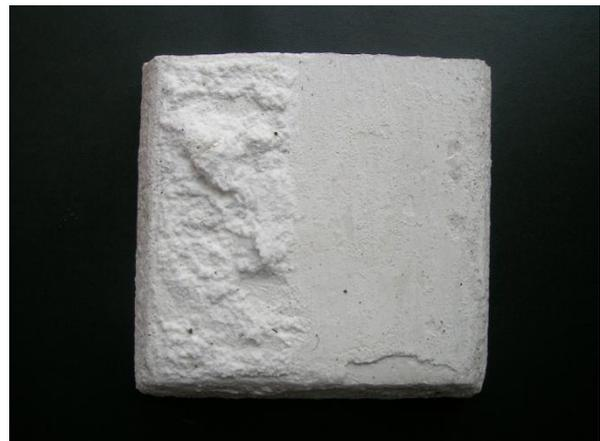
FIGURA 69 - Tinta acrílica econômica após remoção da camada de sulfato de sódio. Fonte: autor (2010).
