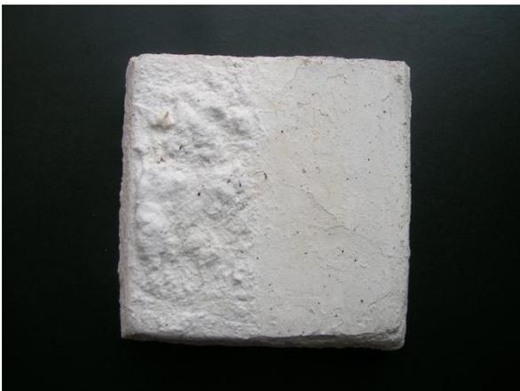
FIGURA 68 - Tinta standard após remoção da camada de sulfato de sódio. Fonte: autor (2010).
