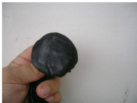
FIGURA 79 – Baixa pulverulência da tinta econômica. Fonte: autor (2010).
