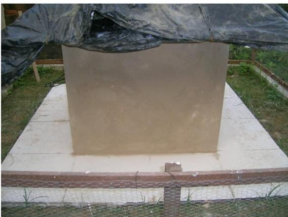
FIGURA 34 - Reboco de cal e areia. Traço 1:2. Fonte: autor (2009).
