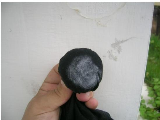
FIGURA 76 – Alta pulverulência da cal artesanal. Fonte: autor (2010).
