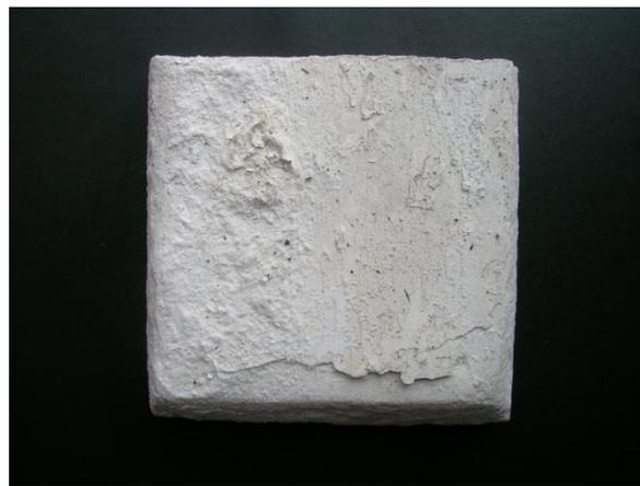
FIGURA 71- Tinta acrílica premium após remoção da camada de sulfato de sódio. Fonte: autor (2010).
