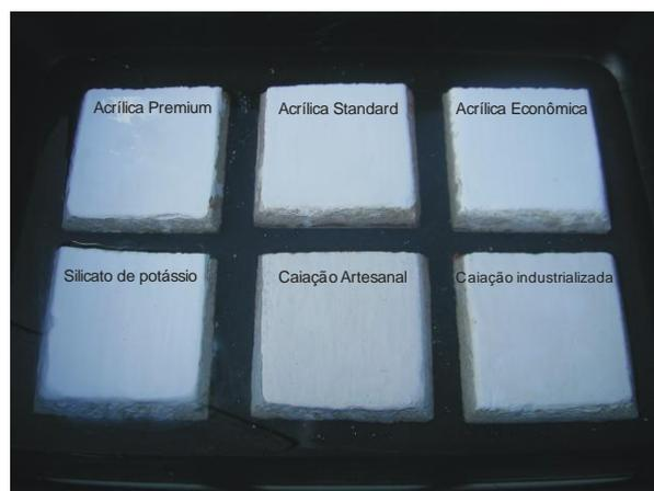
FIGURA 63- Amostras imersas em solução saturada de sulfato de sódio. Fonte: autor (2010).
