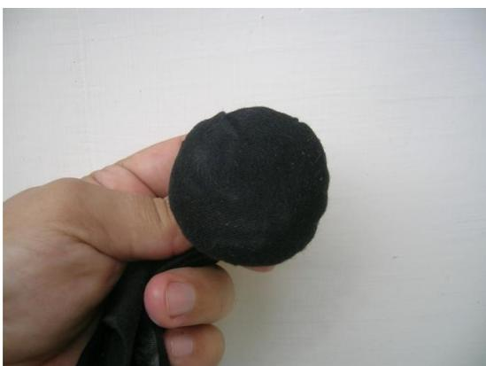
FIGURA 78 – Baixíssima pulverulência da tinta standard. Fonte: autor (2010).
