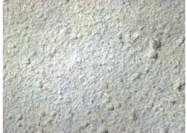
FIGURA 53 - Microfotografia estereoscópica - ampliação 25 vezes. Amostra 02 (cal industrializada).
