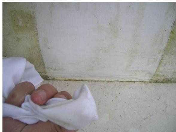
FIGURA 131 - Lavabilidade da tinta standard. Detalhe. Fonte: autor (2010).
