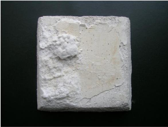
FIGURA 66 - Caição artesanal após remoção da camada de sulfato de sódio. Fonte: autor (2010).
