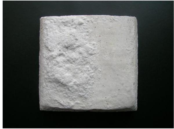
FIGURA 67 - Caição industrializada após remoção da camada de sulfato de sódio. Fonte: autor (2010).
