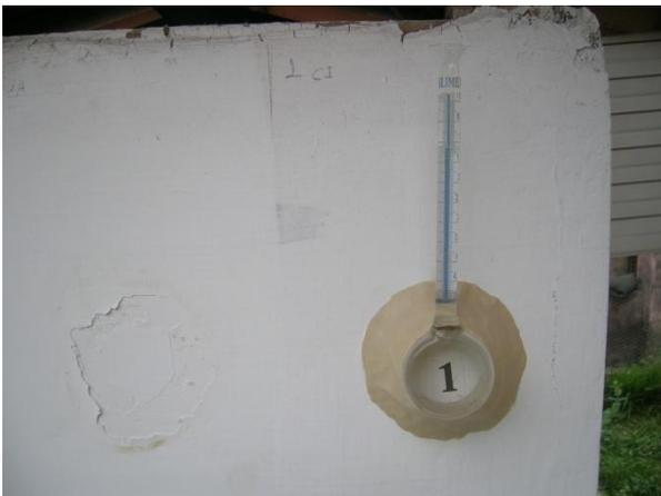
FIGURA 74- Absorção de água pela caiação industrializada. Fonte: autor (2010).
