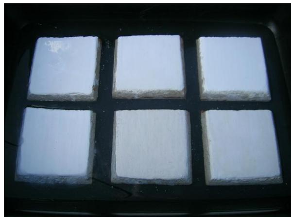
FIGURA 43 - Amostras em solução saturada de sulfato de sódio. Fonte: autor (2009).
