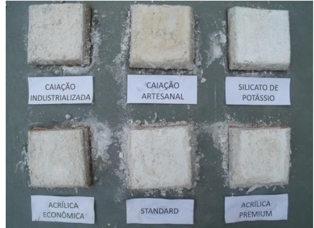
FIGURA 65- Amostras após a remoção das crostas. Fonte: autor (2010).
