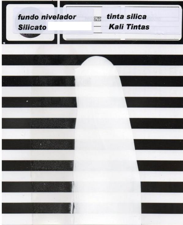
FIGURA 60 - Ensaio de poder de cobertura. Fonte: autor (2010).
