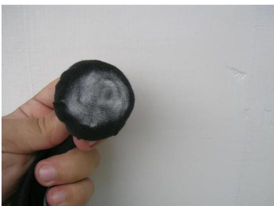
FIGURA 80 – Alta pulverulência da tinta de silicato. Fonte: autor (2010).
