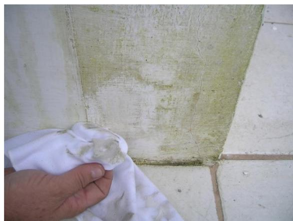
FIGURA 129 – Lavabilidade da cal artesanal. Detalhe. Fonte: autor (2010).
