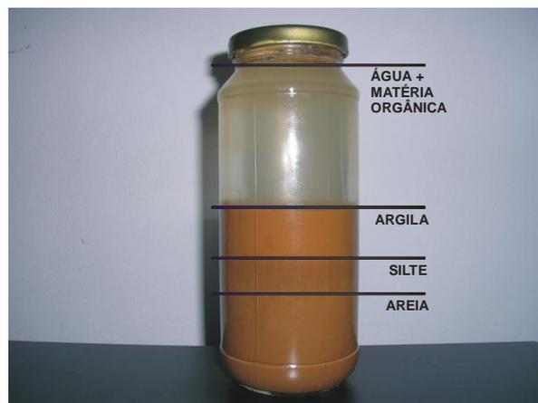
FIGURA 37 - Distribuição aproximada dos componentes da terra. Fonte: autor (2010).
