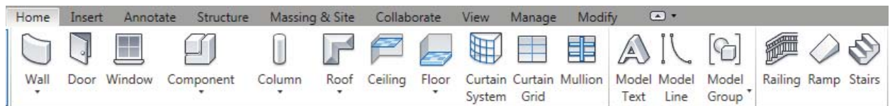
Figura 71 - Menu de criação de elementos arquitetônicos do Revit® Fonte: Revit®, da autora, 2012
