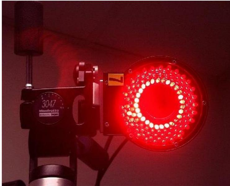
**Imagem 94:** sistema de captura com os LEDs acessos em torno da lente de entrada da câmera, retroiluminada [Vicon 2011].
