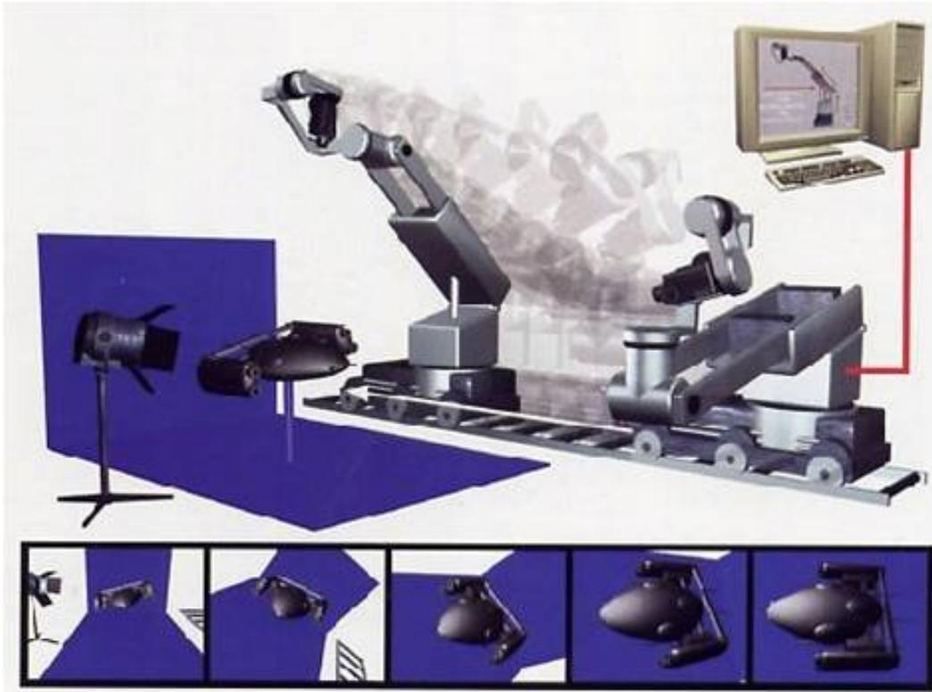
**Imagem 74:** sistema para movimentação de câmera, controlado por computador [Rickitt 2007].
