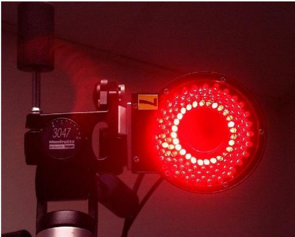
*Figura 38: sistema de captura com os LEDs acesos em torno da lente de entrada da câmera, retroiluminada<sup>69</sup>.*
