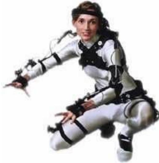
*Figura 35: sistema eletromecânico de mocap da Gipsy<sup>63</sup>.*
