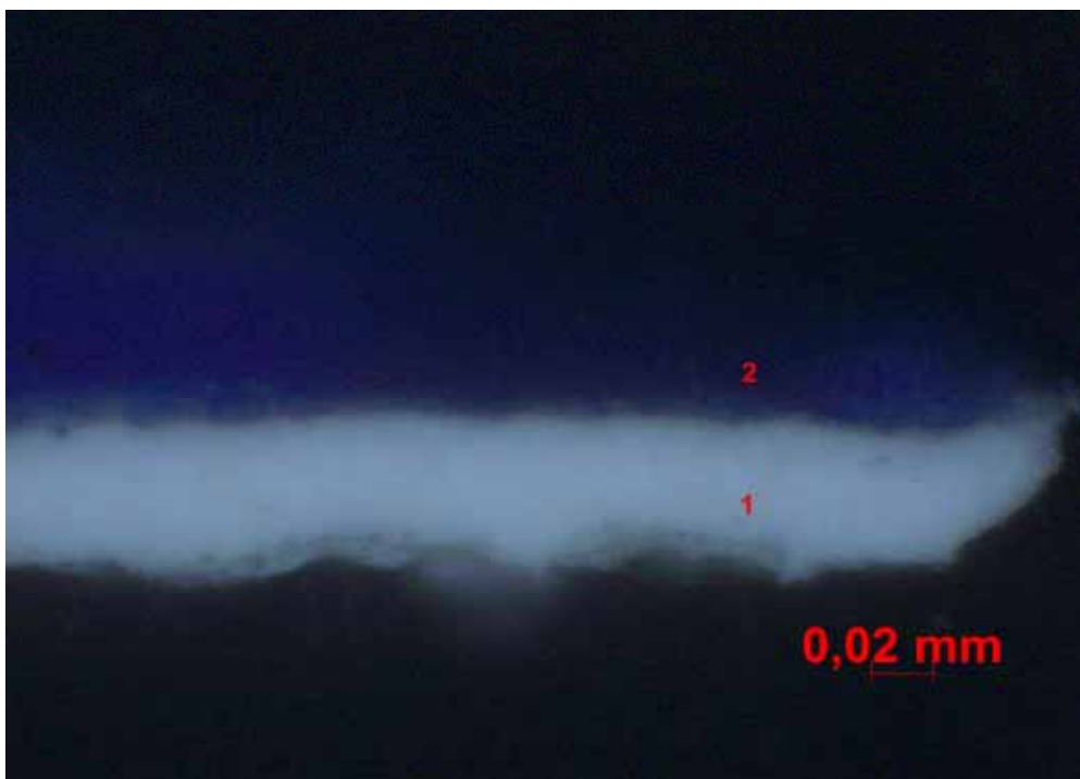
Figura 03: Corte estratigráfico da amostra 2406T - camada de tinta do fundo azul, que foi retirada em ponto de perda da borda da escultura aumento 66x
