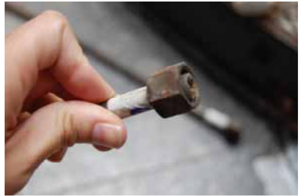
FIGURA 80- Oxidação da peça do encaixe do reservatório de água e a oxidação do conector das mangueiras ao distribuidor de água. Foto da autora, 2011.
