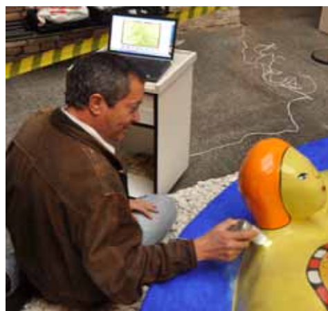
FIGURA 81- Exames com microscópio digital portátil acoplado ao notebook , para visualização e captura de imagens (fotomicrografias) e vídeos. Fotos da autora, 2011.
