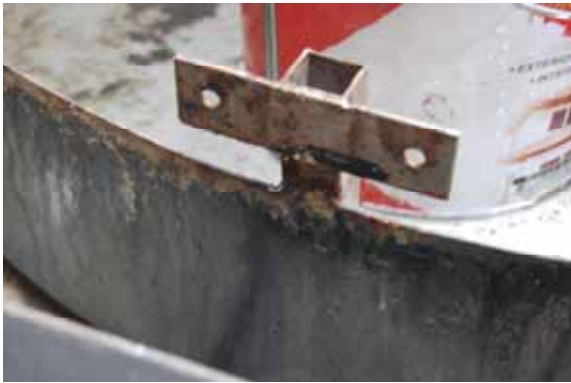
FIGURA 80- Oxidação da peça do encaixe do reservatório de água e a oxidação do conector das mangueiras ao distribuidor de água. Foto da autora, 2011.
