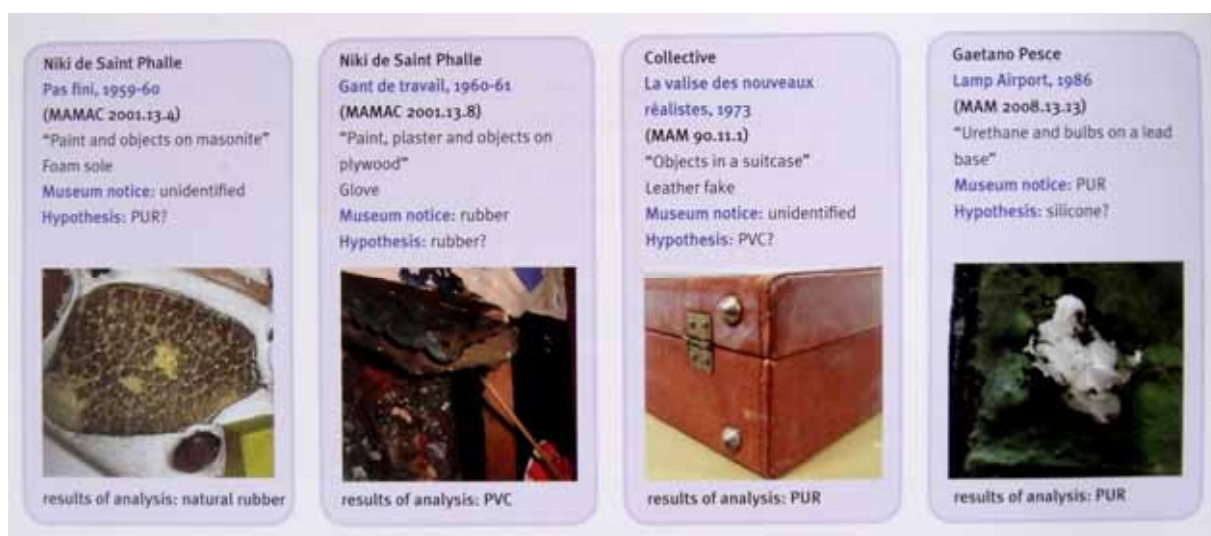
FIGURA 66- Exemplos de materiais que podem parecer ser um tipo de polímero, mesmo quando analisado por profissionais experientes, mas que somente com análises instrumentais é possível determinar o material com exatidão. Fonte: BACCI, 2012.
