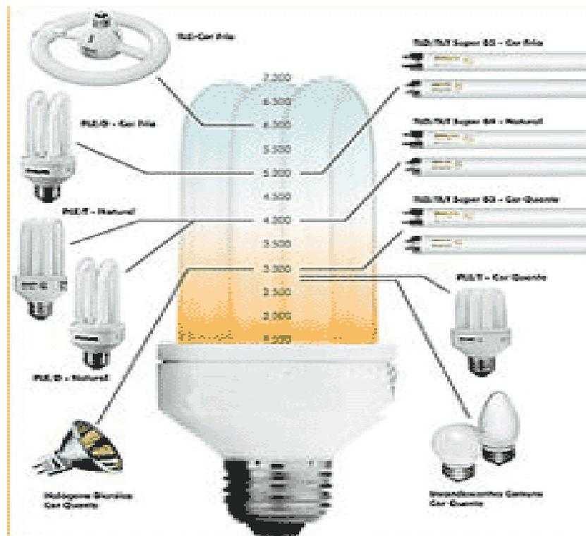
Fig.16 – Representação gráfica da temperatura de cor de algumas lâmpadas.
