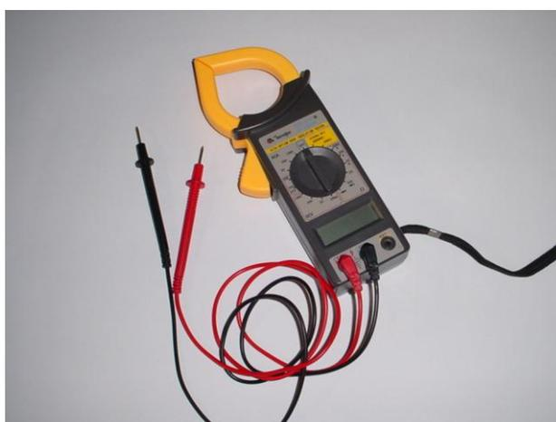
Fig.44 – Multímetro alicate.
