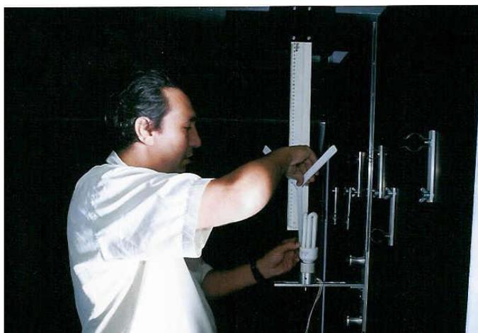
Fig.51 – Centralização da fonte de teste de ajuste de altura.
