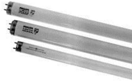
Fig.23 – Variação do diâmetro das lâmpadas fluorescentes (respectivamente de cima para baixo: 26, 38 e 16 mm).
