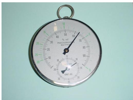
FIGURA 46 – Termohigrômetro.
