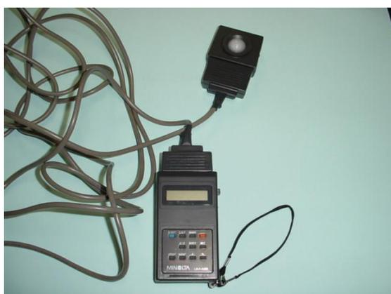
Fig.43 – Medidor com cabo extensor acoplado.
