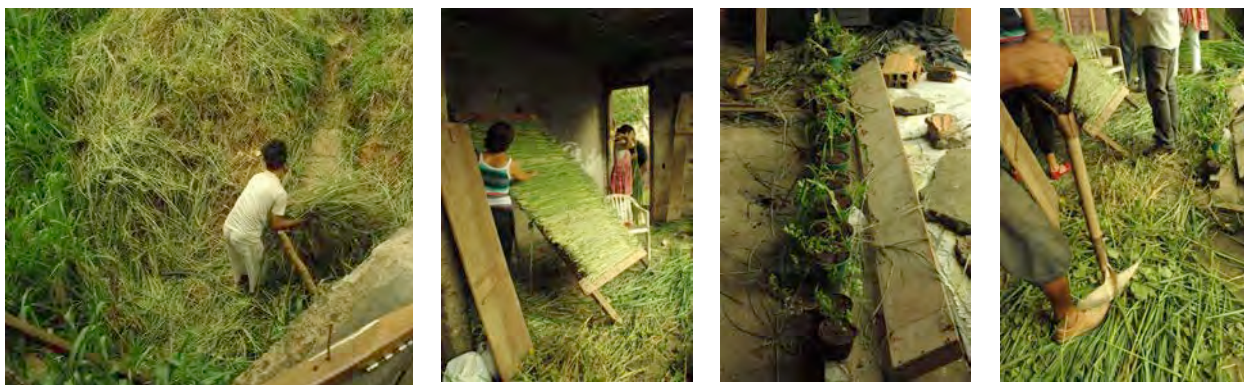
Fig. 40 - Kaza Vazia 8. Fabriquinha de esteiras . 2008. Tear feito com madeiras e capim colhidos no local. Disponível em: http://kazavazia8.blogspot.com . Acessado em: 2 out. 2012.
