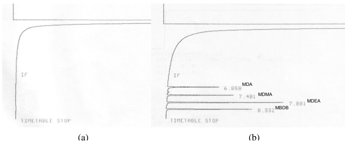
Figura 9 – Cromatogramas obtidos após a injeção de alíquota de metanol (a) e de solução metanólica contendo MDA, MDMA, MDEA e MBDB, em concentração de 50 µg/mL (b), no aparelho CG, nas condições estabelecidas.
