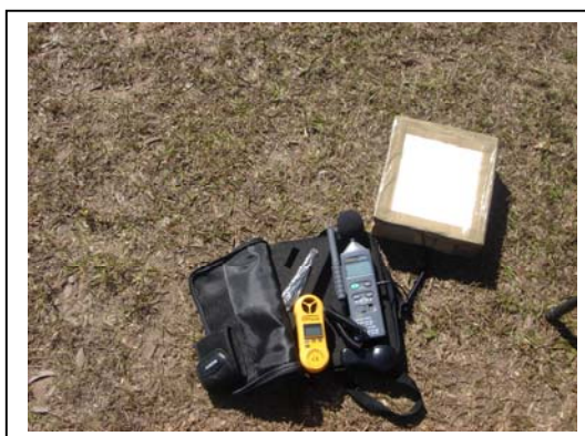
Figura 8A e 8B. Foto do luxímetro usado para medição da luminosidade do ambiente.
