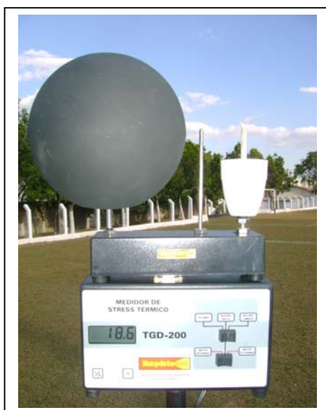
Figura 7. Foto do aparelho Medidor de Estresse Térmico (TGD 200) usado na medição da temperatura ambiente.
