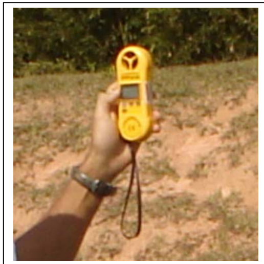
Figura 10. Foto da medição da velocidade do vento.
