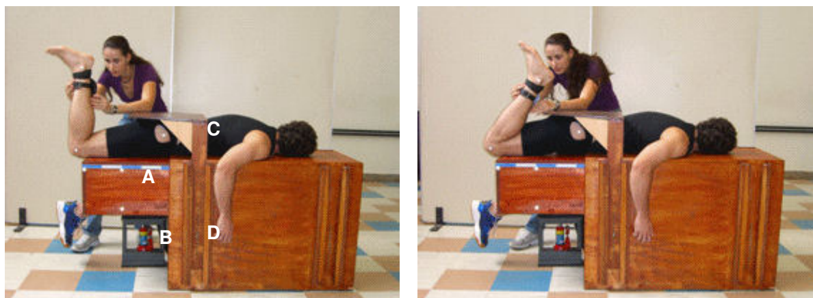
FIGURA 8 – Posicionamento inicial e final no TFJ. A) Suporte para a coxa; B) Apoio para o joelho; C) Estabilizador pélvico; D) Trilho lateral.
