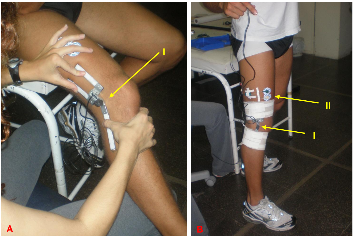
FIGURA 3: Equipamentos para aquisição de dados. I) Eletrogoniômetro; II) Eletrodos de superfície. Fonte: Arquivos de fotos do LAMUSC
