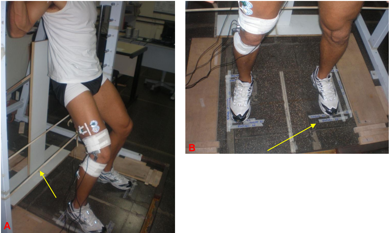
FIGURA 5: Padronização de posicionamento. A) Fita de borracha para delimitação da amplitude de movimento inferior; B) Padronização da posição dos pés. Fonte: Arquivo de fotos do LAMUSC
