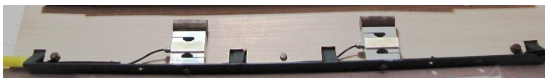
FIGURA 8 – Base de saída. Composta por duas células de força adaptadas com duas agarras de madeira onde o escalador o inicia o movimento. Fonte: arquivo Biolab
