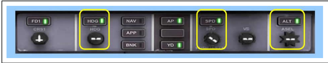
FIGURA 19 – Flight Guidance Controller – Em destaque, as teclas e botões de proa, velocidade e altitude. As teclas com o LED verde iluminado indicam as funções ativadas
