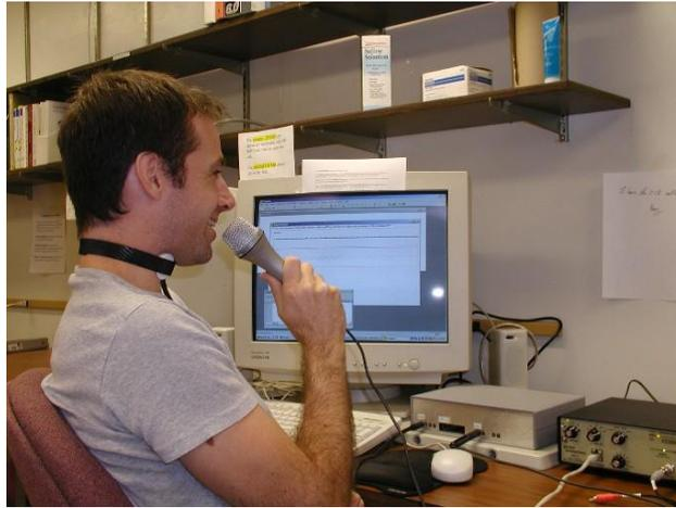
**Figura 22** – Foto ilustrativa de como o EGG é conectado ao sujeito
