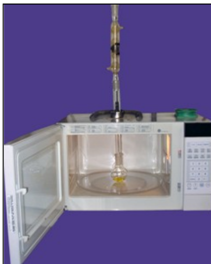
Figura 4.14 – Aparelho de microondas adaptado utilizado para a remoção do acetal benzilidênico (Departamento de Química/ICEX – UFMG).
